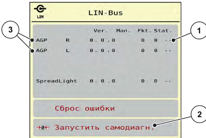
Рис. 24: Тестирование системы; пример: Тест/диагностика
