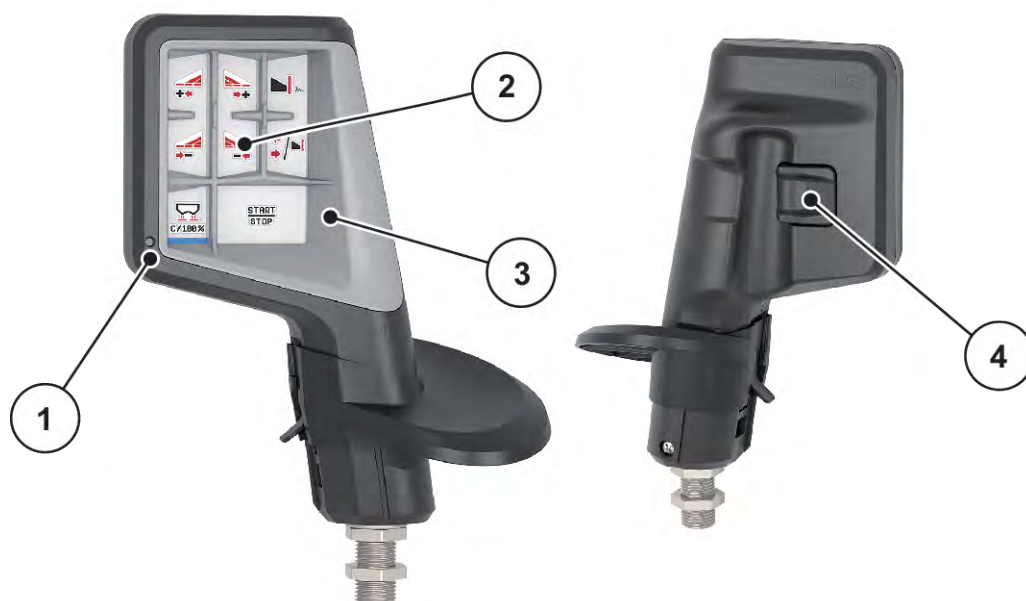
Rys. 30: CCI A3 Dżojstik, przednia i tylna strona
