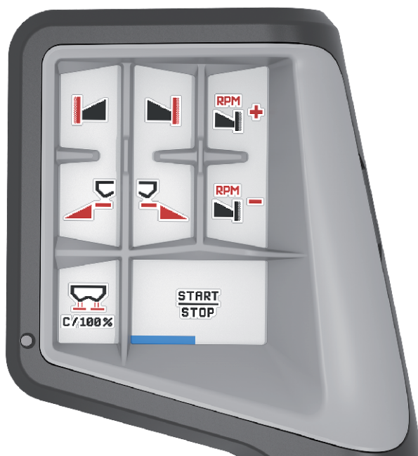
Rys. 33: Przyporządkowanie przycisków do poziomu 2
