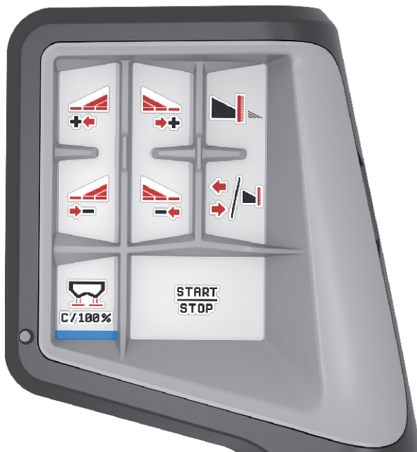
Rys. 32: Przyporządkowanie przycisków do poziomu 1
