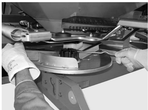
Slika 8.3: Otpustite zaobljenu slijepu maticu
