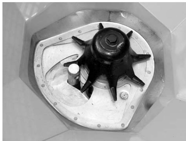
Slika 9.14: Klin donjeg cilindra u otvoru za doziranje
