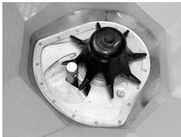
Мал. 9.13: Болт нижньої тяги в отворі дозатора
