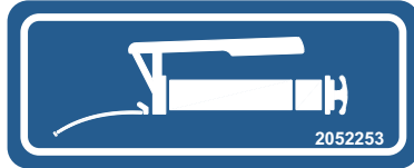
Εικόνα 9.22: Πινακίδα σήμανσης σημείου λίπανσης
