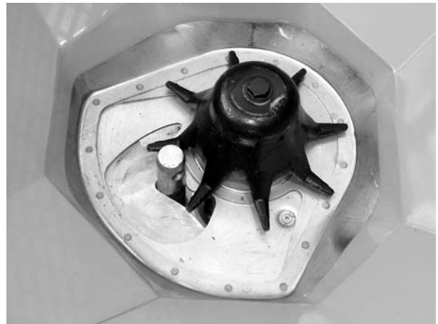
Εικόνα 9.13: Μπουλόνι κάτω συνδέσμου στο δοσιμετρικό στόμιο
