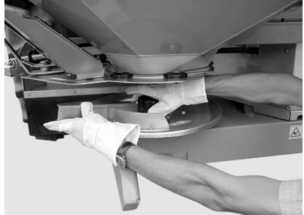
Εικόνα 8.4: Ξεβίδωμα τυφλού παξιμαδιού
