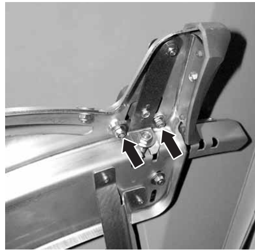
図 29: 放出ポイント調整プレートをゆるめる
