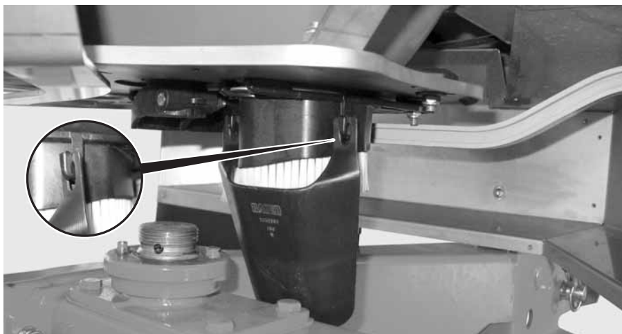
図 18: キャリブレーションテストシュートの取付け
