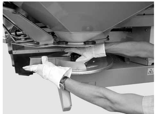
図 14: キャップナットを締める
