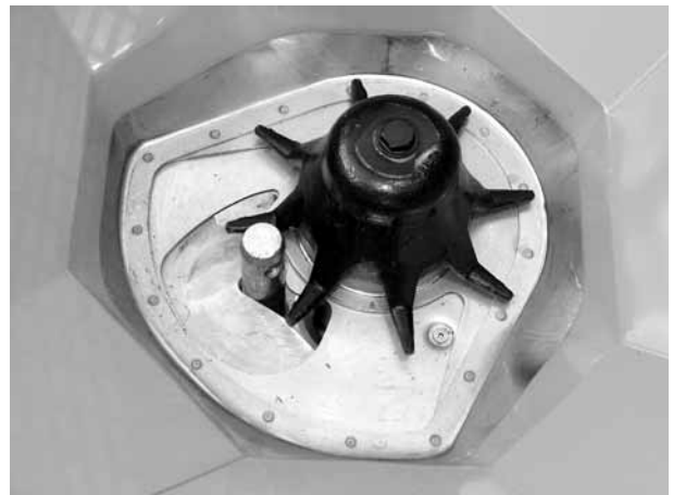
図 25: 計測アウトレットのロアリンクピン
