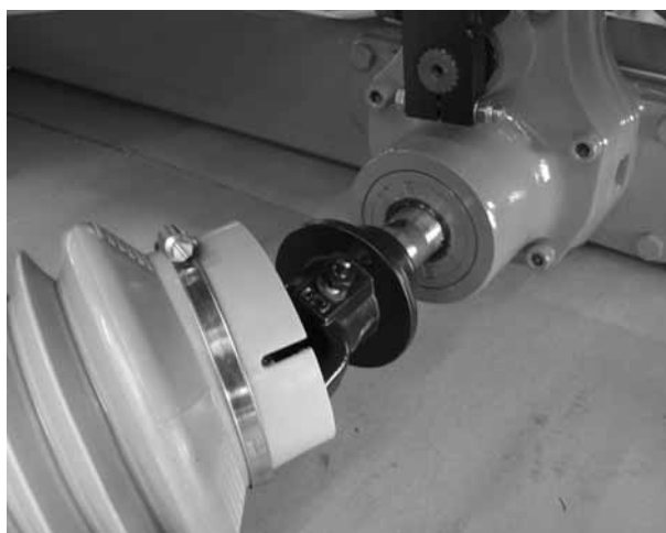
図 3: ユニバーサルドライブシャフトをギアボックスピンに取り付ける
