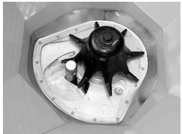
図 23: 計測アウトレットのロアリンクピン
