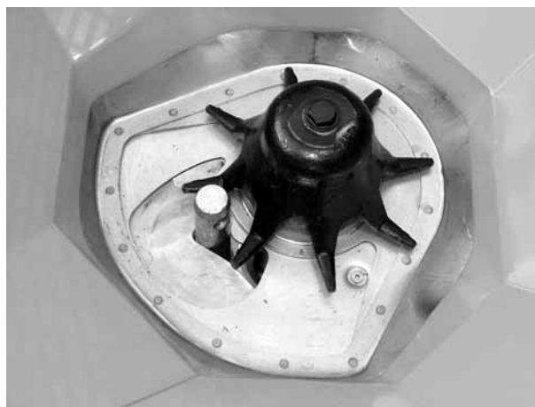
図 22: 計測アウトレットのロアリンクピン
