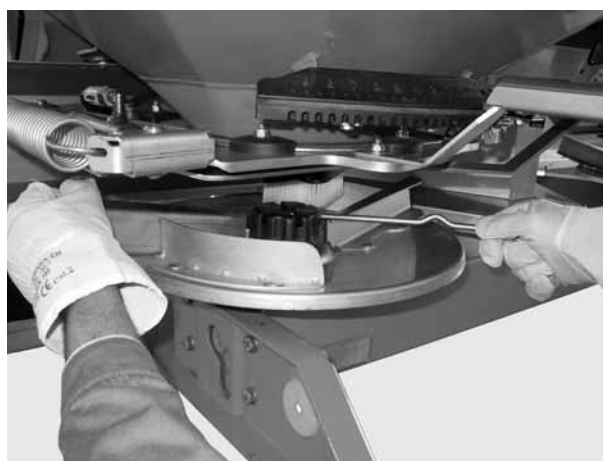
図 4: キャップナットをゆるめる
