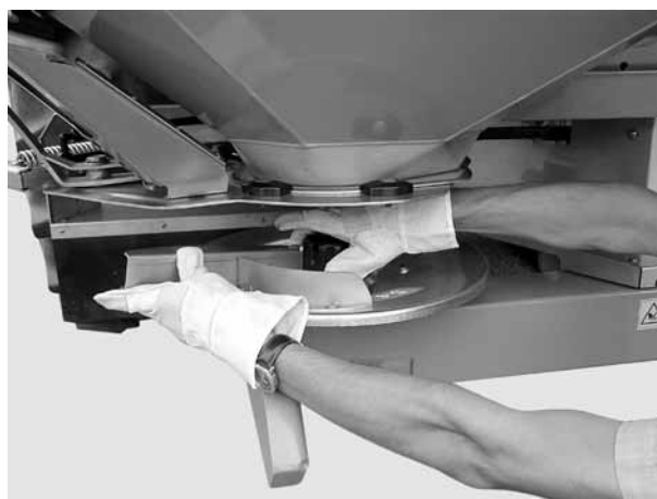
図 13: キャップナットを締める
