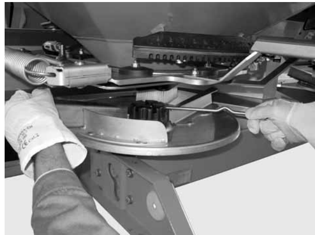
図 10: キャップナットをゆるめる
