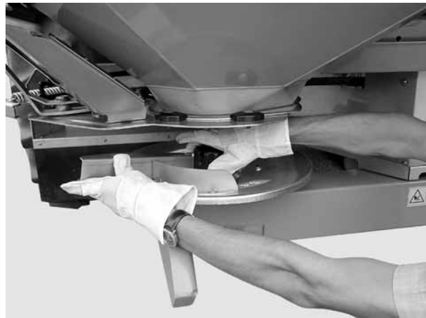
図 20: キャップナットを締める
