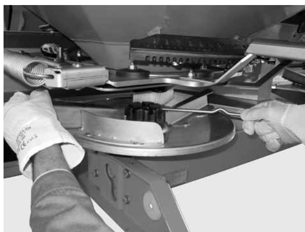
図 4: キャップナットをゆるめる
