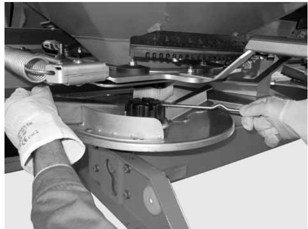
図 11: キャップナットをゆるめる
