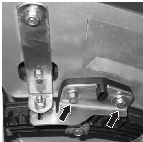
図 28: 放出ポイント調整プレートをゆるめる
