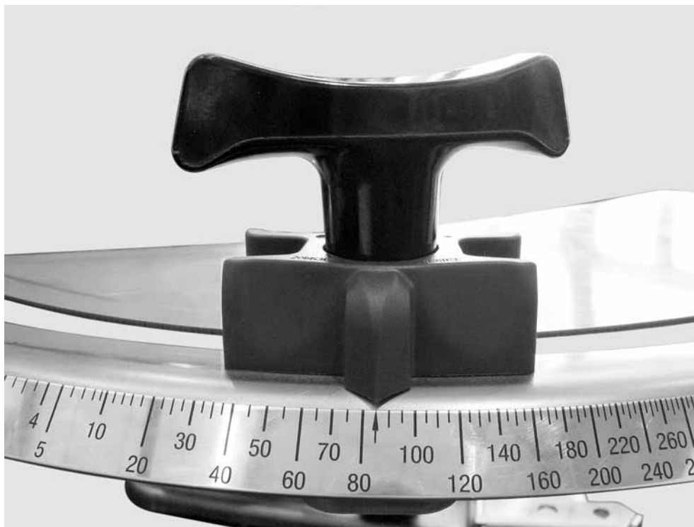
図 24: 計測スライドの設定スケール
