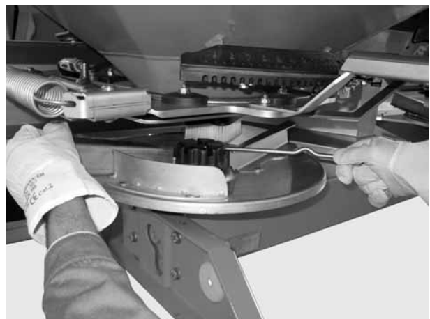
図 11: キャップナットをゆるめる
