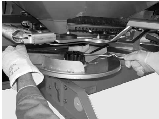
図 17: キャップナットをゆるめる
