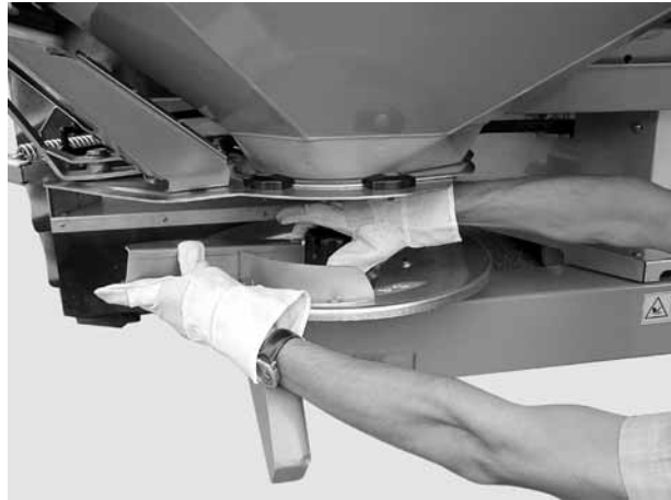
図 5: キャップナットを外す
