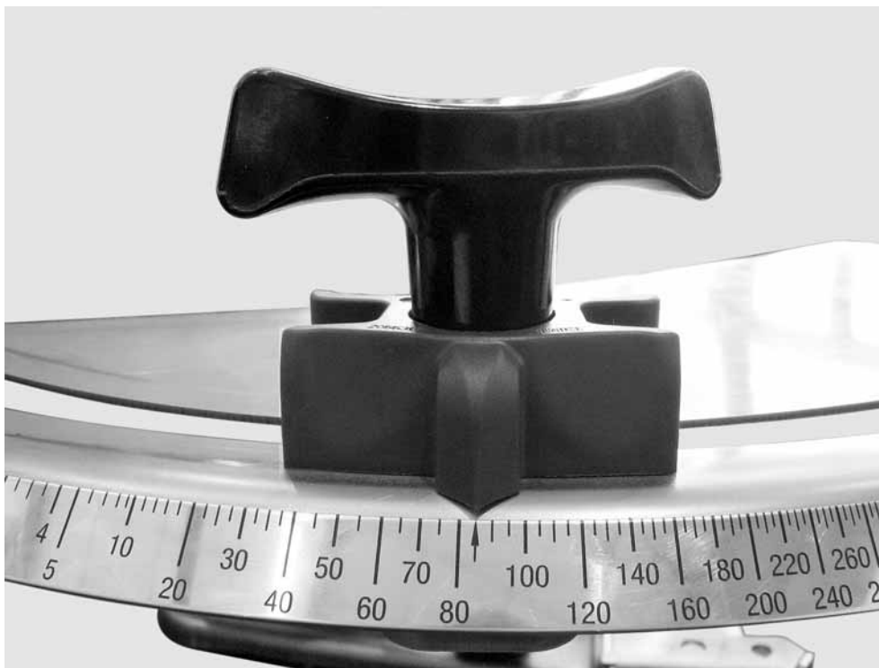
図 23: 計測スライドの設定スケール
