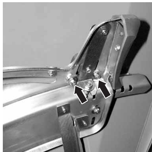
図 25: 放出ポイント調整プレートをゆるめる
