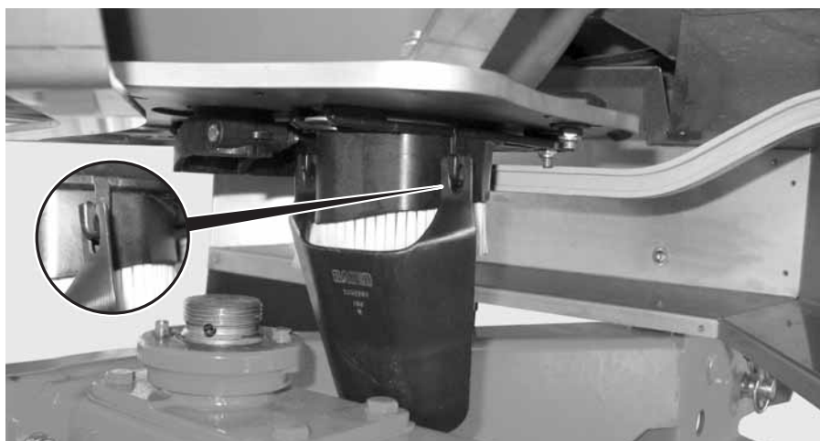
図 12: キャリブレーションテストシュートの取付け
