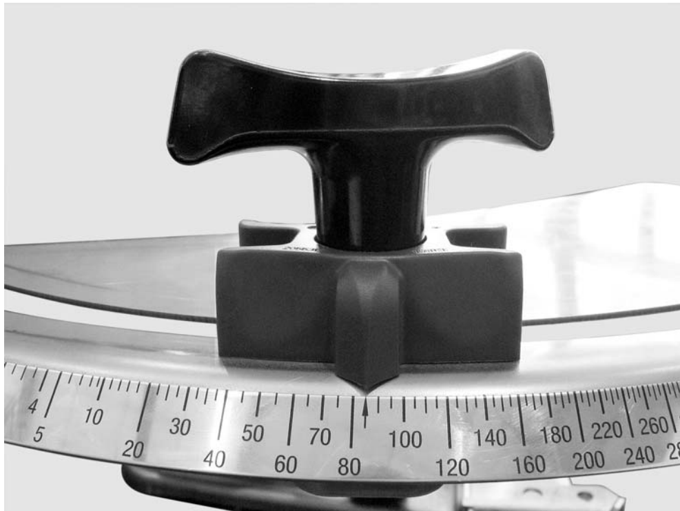
Mynd 23: Kvarði fyrir stillingu skömmtunarops
