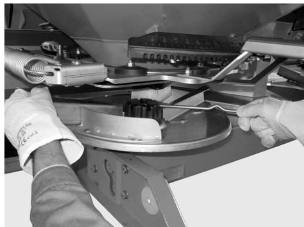
Mynd 11: Losað um hetturó
