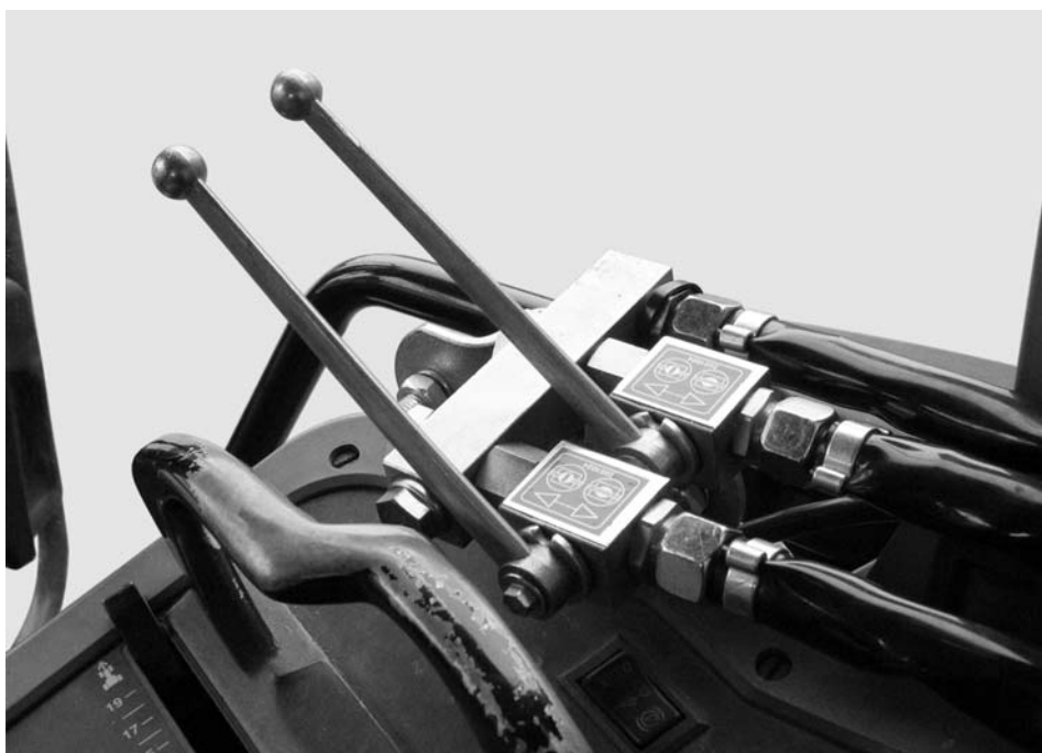
Mynd 1: Stýring skömmtunarops með tvíátta einingu
