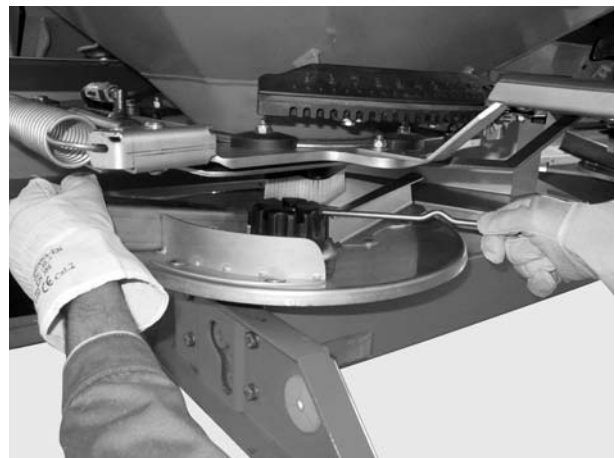
Mynd 4: Losað um hetturó
