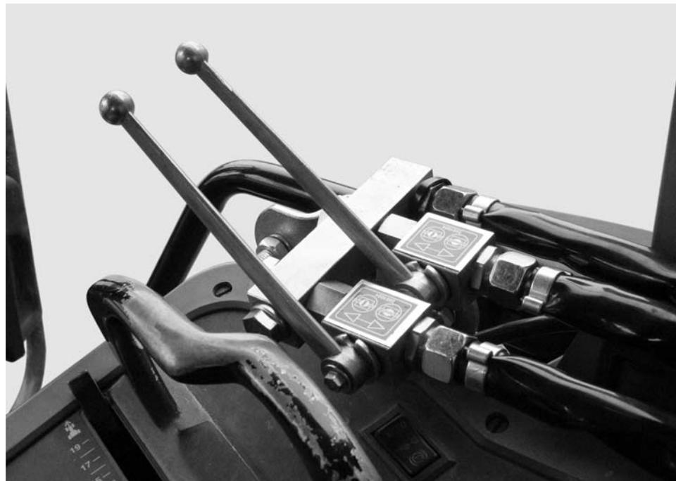
Mynd 8: Stýring skömmtunarops með tvíátta einingu
