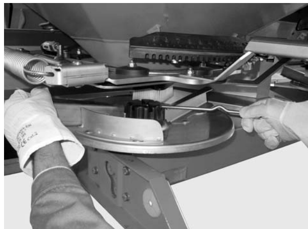
Εικόνα 4: Χαλάρωση τυφλού παξιμαδιού
