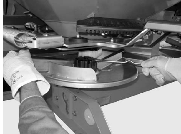
Εικόνα 11: Χαλάρωση τυφλού παξιμαδιού
