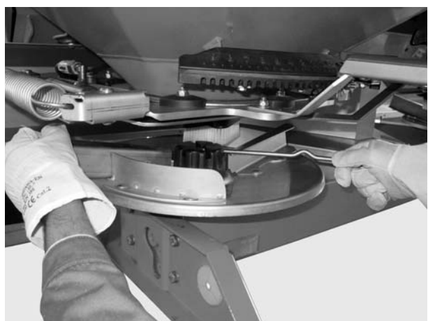
Εικόνα 4: Χαλάρωση τυφλού παξιμαδιού
