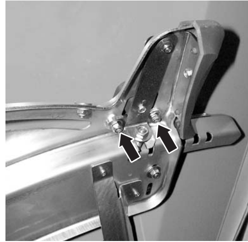
Εικόνα 25: Χαλάρωση ελάσματος ευθυγράμμισης σημείου εφαρμογής
