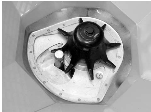
Εικόνα 25: Μπουλόνι κάτω συνδέσμου στο δοσιμετρικό στόμιο
