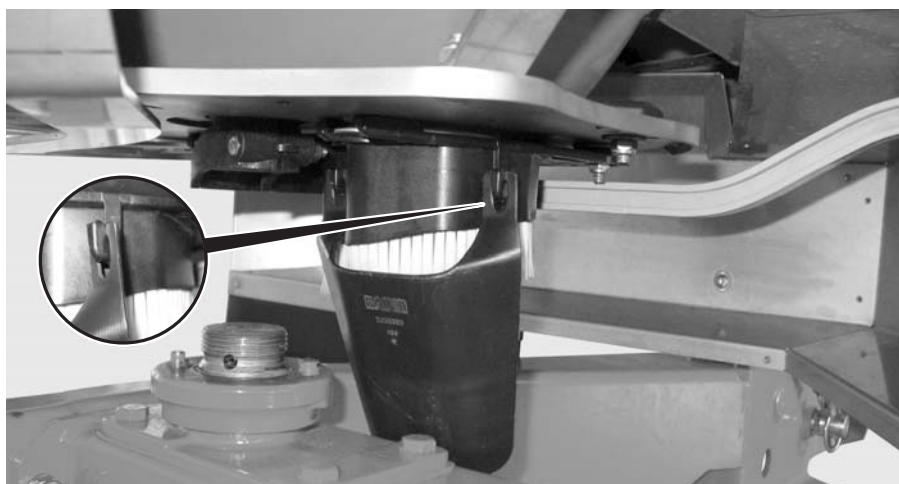
Εικόνα 12: Προσάρτηση ολισθητήρα δοκιμής βαθμονόμησης
