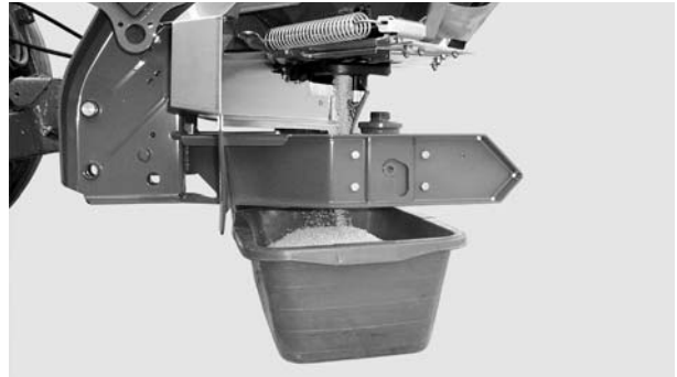
Εικόνα 19: Εκτέλεση δοκιμής βαθμονόμησης
