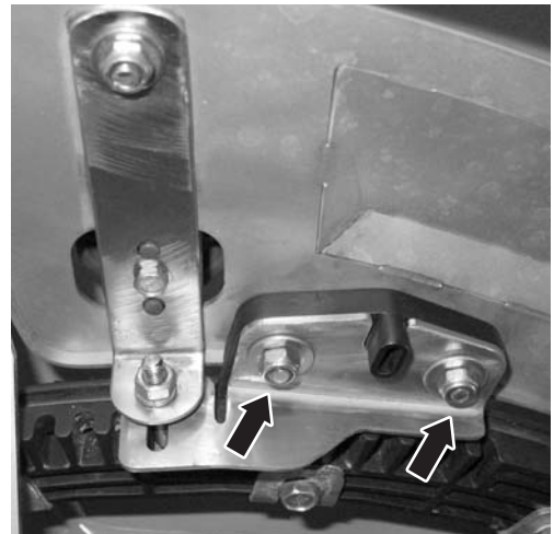
Εικόνα 28: Χαλάρωση ελάσματος ευθυγράμμισης σημείου εφαρμογής
