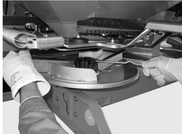
Εικόνα 17: Χαλάρωση τυφλού παξιμαδιού
