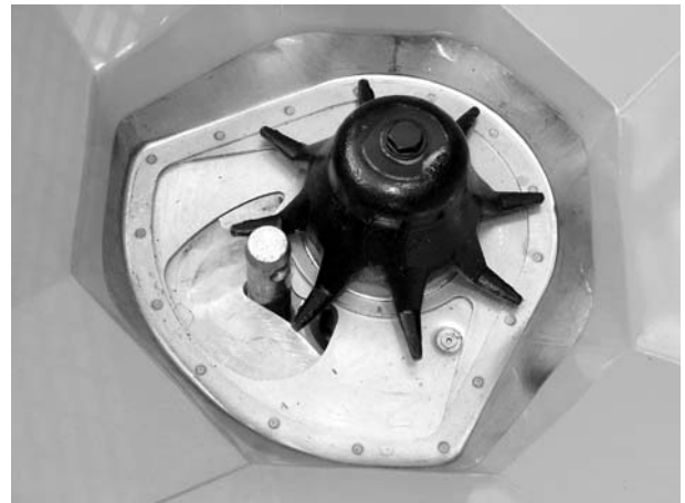
Εικόνα 23: Μπουλόνι κάτω συνδέσμου στο δοσιμετρικό στόμιο
