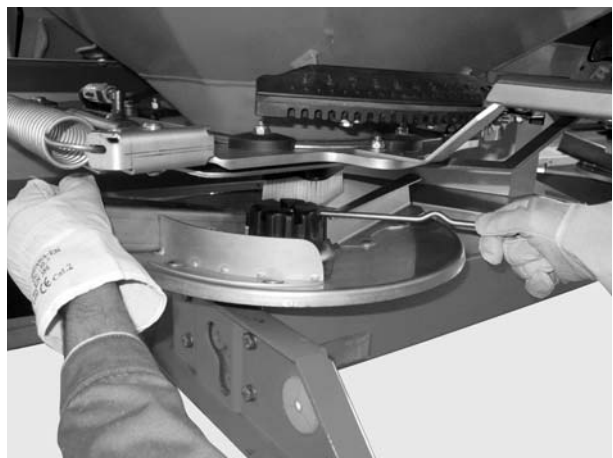
Εικόνα 11: Χαλάρωση τυφλού παξιμαδιού
