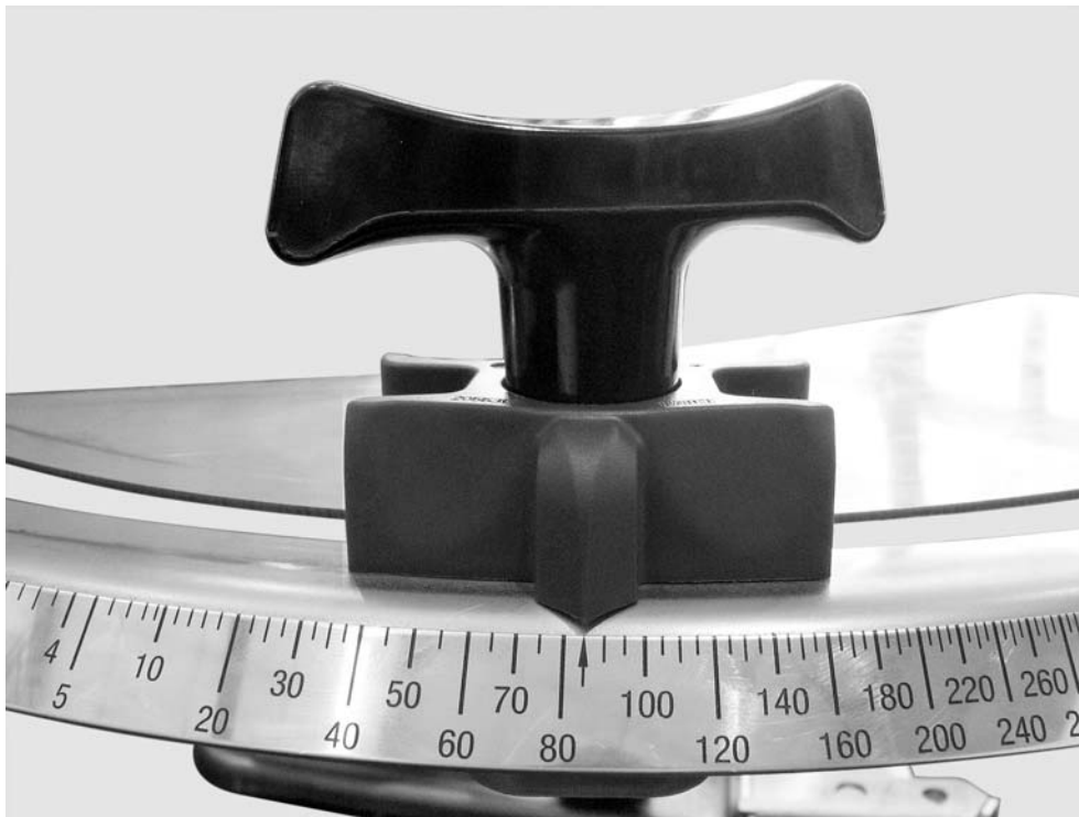
Εικόνα 23: Κλίμακα ρύθμισης δοσιμετρικής θυρίδας
