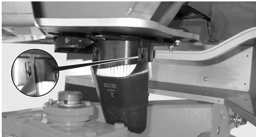
Εικόνα 11: Προσάρτηση ολισθητήρα δοκιμής βαθμονόμησης
