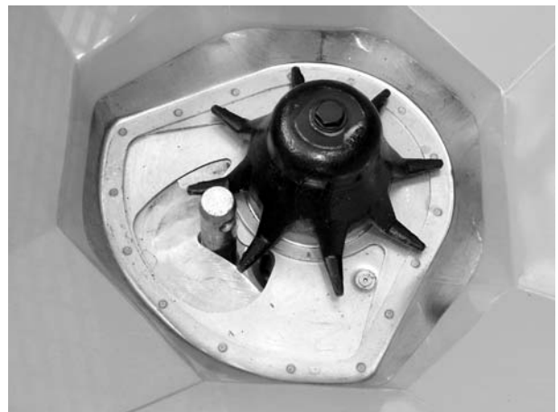
Εικόνα 22: Μπουλόνι κάτω συνδέσμου στο δοσιμετρικό στόμιο
