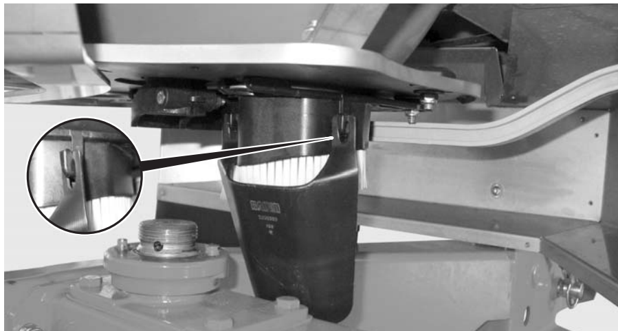
Εικόνα 18: Προσάρτηση ολισθητήρα δοκιμής βαθμονόμησης
