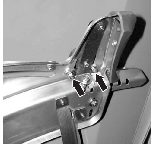
Resim 29: Gübre bırakma noktası düzeltme levhasının sökülmesi
