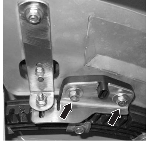
Resim 28: Gübre bırakma noktası düzeltme levhasının sökülmesi
