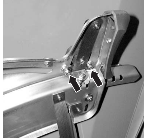
Resim 25: Gübre bırakma noktası düzeltme levhasının sökülmesi
