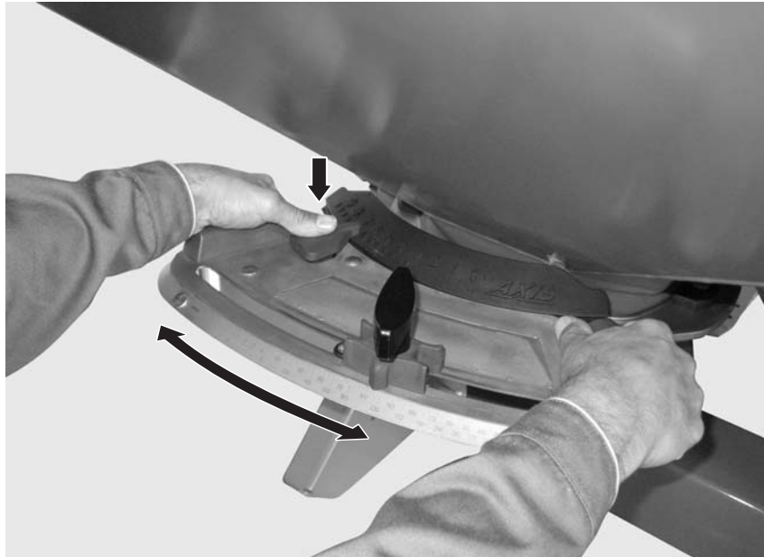
Slika 13: Nastavitvena konzola za izstopno odprtino
