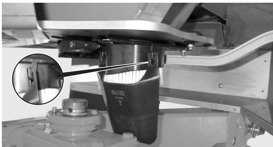
Slika 18: Vpnite zaskočko za umerjanje.
