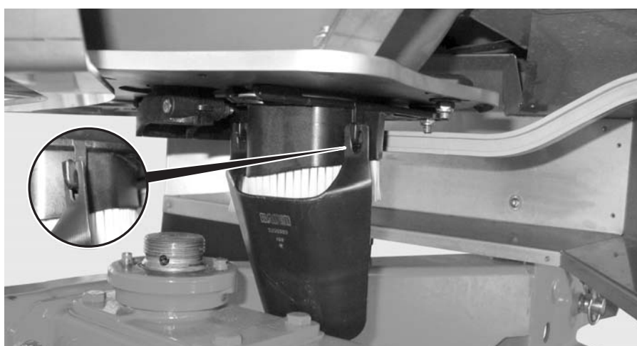
Slika 12: Vpnite zaskočko za umerjanje.
