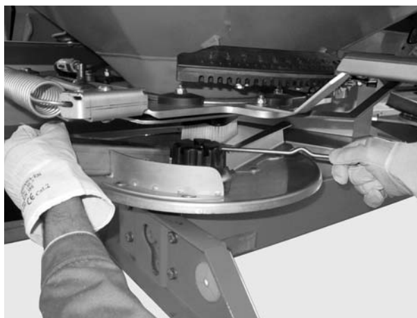
Slika 4: Zrahljajte klobučaste matice.
