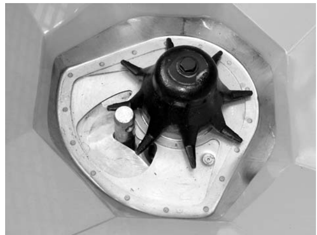
Slika 23: Sornik spodnjega vodila v dozirni odprtini
