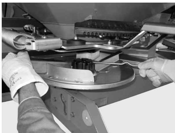
Slika 10: Zrahljajte klobučaste matice.
