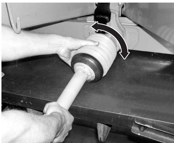
Slika 8.4: Priključite varovalo kardanske gredi.
