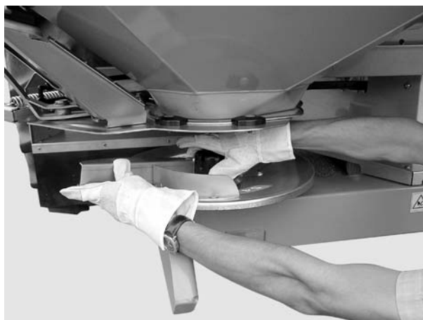
Slika 12: Odvijte klobučaste matice.
