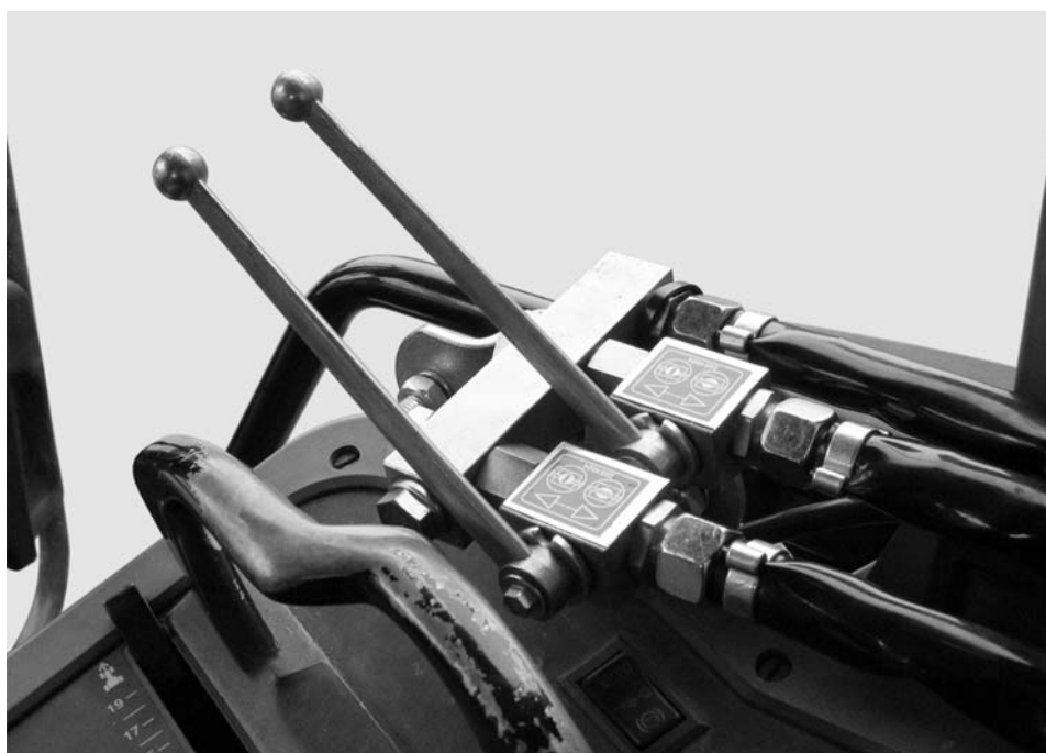
Slika 8: Sproženje drsnika dvopotne enote
