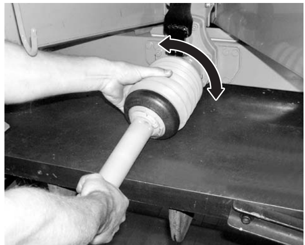
Obrázok 6: Založenie ochranného krytu kĺbového hriadeľa
