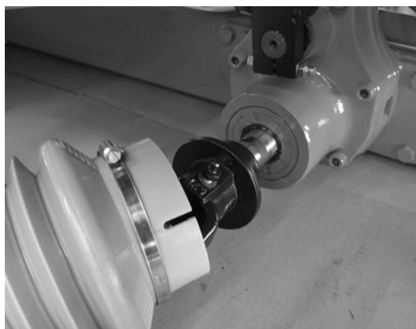
3 pav.: Kardaninio veleno užmovimas ant pavaros mechanizmo veleno galą
