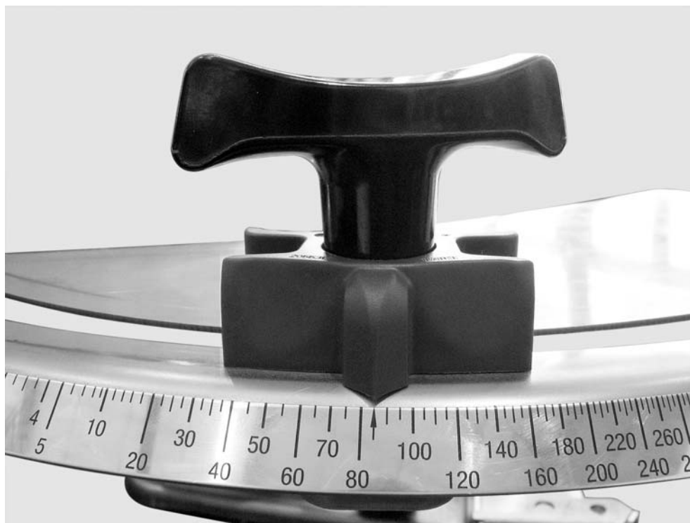
Joonis 24: Doseerimisklapi seadistamise skaala
