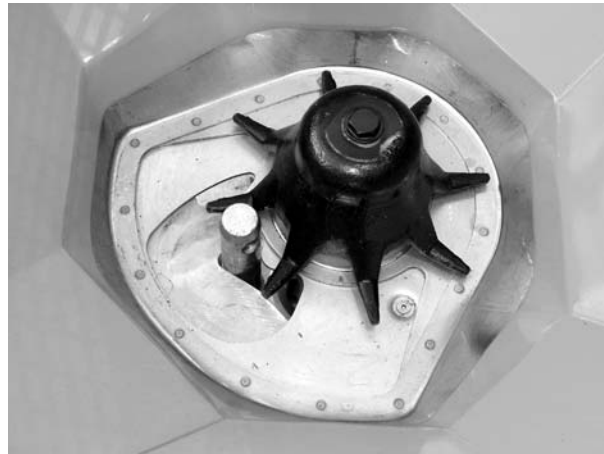
Imagine 9.13: Bolțul de cuplare inferioară în deschiderea de dozare
