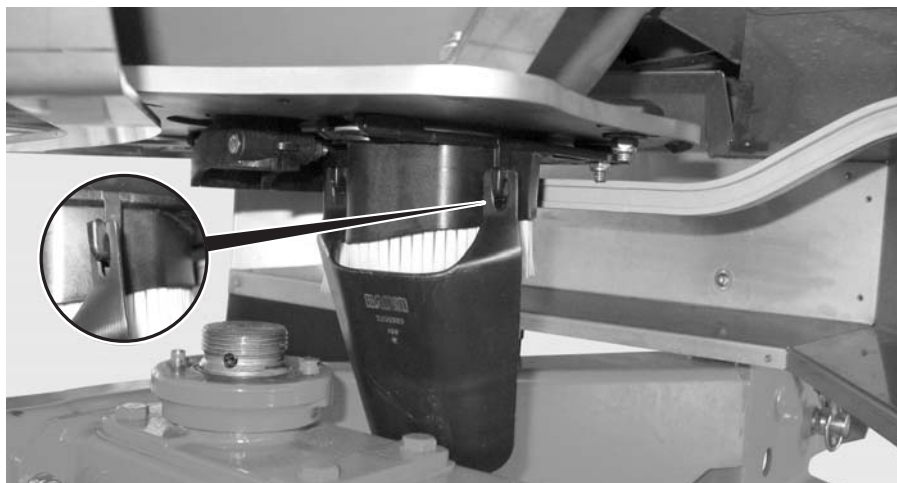
18 ábra: A leforgatási próba csúszdájának beakasztása
