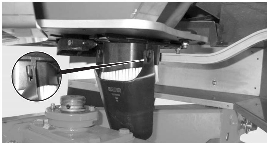
11 ábra: A leforgatási próba csúszdájának beakasztása
