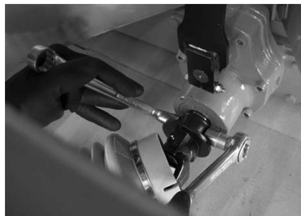
4 ábra: Kardántengely rögzítése
