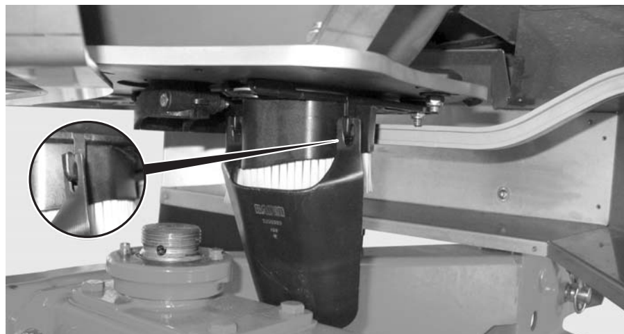
12 ábra: A leforgatási próba csúszdájának beakasztása
