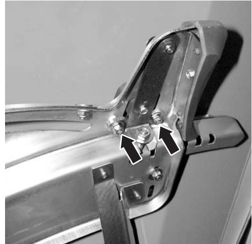
25 ábra: Munkapont állítólemeznének kioldása
