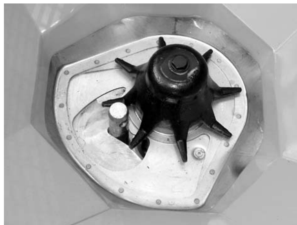
Slika 23: Klin donjeg hidrauličnog podizača u otvoru za doziranje
