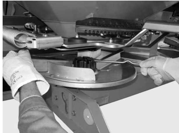
Slika 10: Olabavlјivanje slepe navrtke
