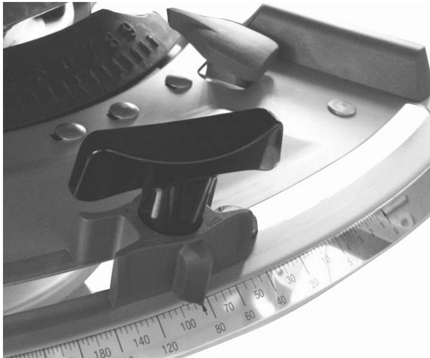
Slika 26: Podešavanje skale klizača za doziranje
