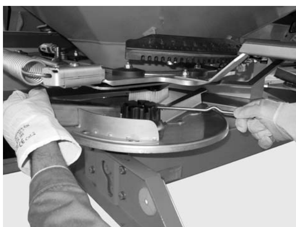
Slika 4: Olabavljanje slepe navrtke
