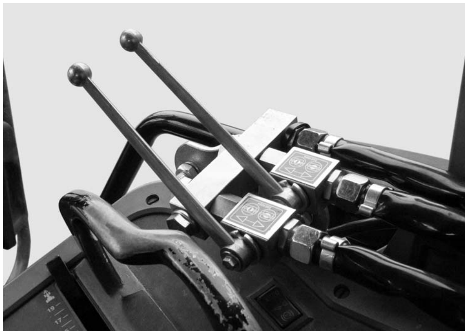
Slika 8: Pogon klizača preko dvosmerne jedinice
