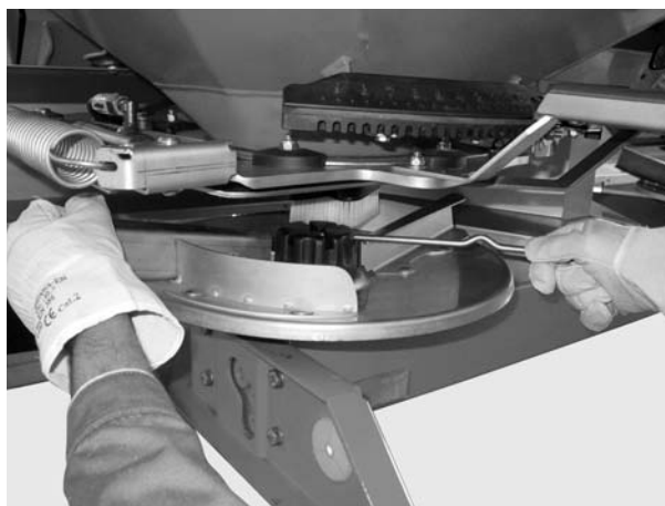
Slika 11: Olabavlivanje slepe navrtke
