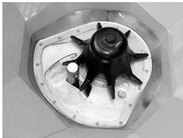
Slika 25: Klin donjeg hidrauličnog podizača u otvoru za doziranje
