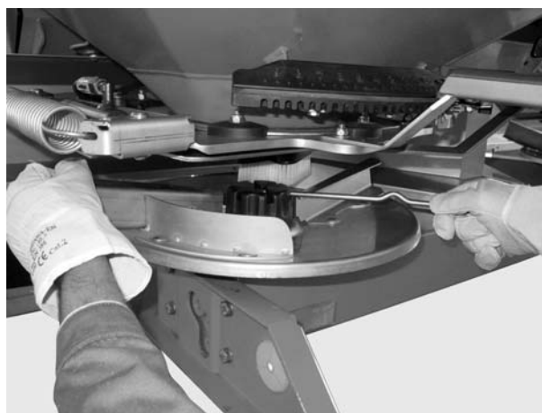
Slika 17: Olabavljanje slepe navrtke
