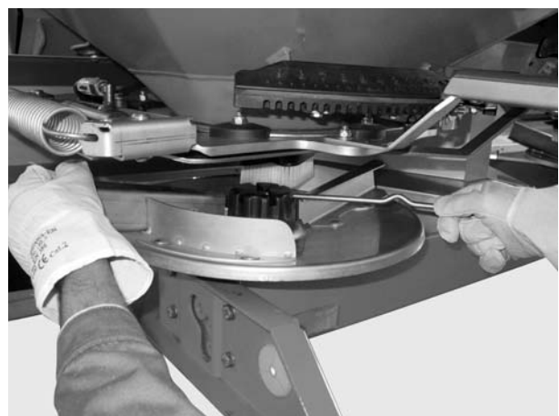
Slika 4: Olabavlivanje slepe navrtke
