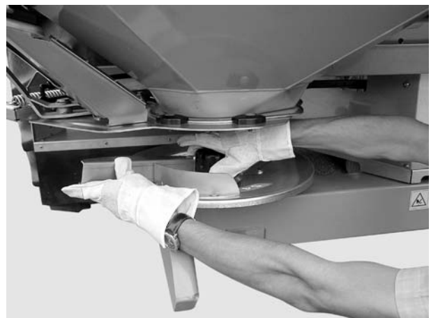
Slika 14: Navrtanje slepe navrtke
