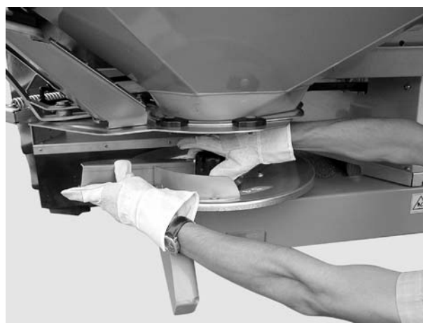
Slika 20: Navrtanje slepe navrtke
