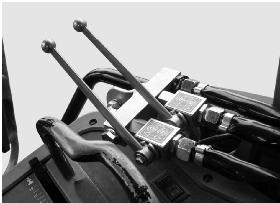
Рисунок 8: Управление заслонками с помощью двухходового блока Вы можете по отдельности управлять заслонками дозатора при помощи шаровых кранов двухходового блока.
