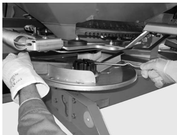
Рисунок 4: Развинчивание колпачковой гайки
