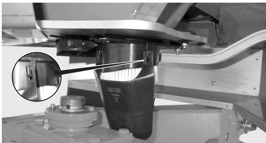
Рисунок 11: Навешивание лотка для пробной настройки нормы внесения
