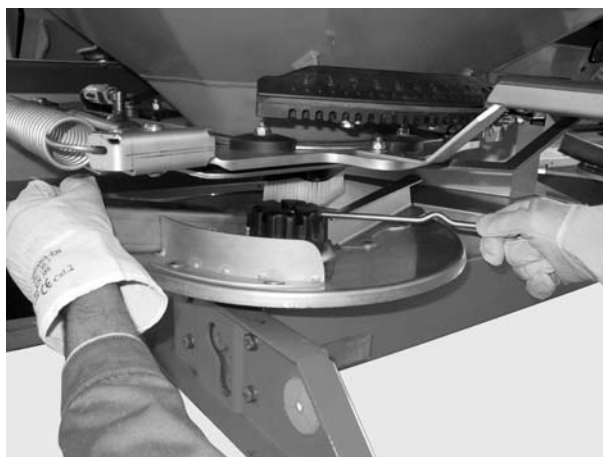
Рисунок 11: Развинчивание колпачковой гайки
