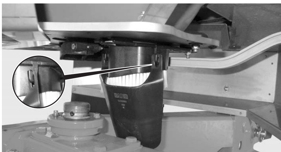
Рисунок 18: Навешивание лотка для пробной настройки нормы внесения
