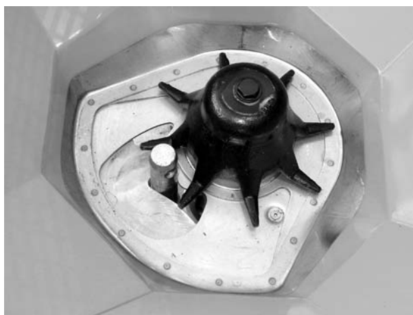
Рисунок 22: Болт нижней тяги в дозирующем отверстии
