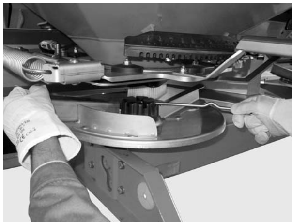
Рисунок 17: Развинчивание колпачковой гайки
