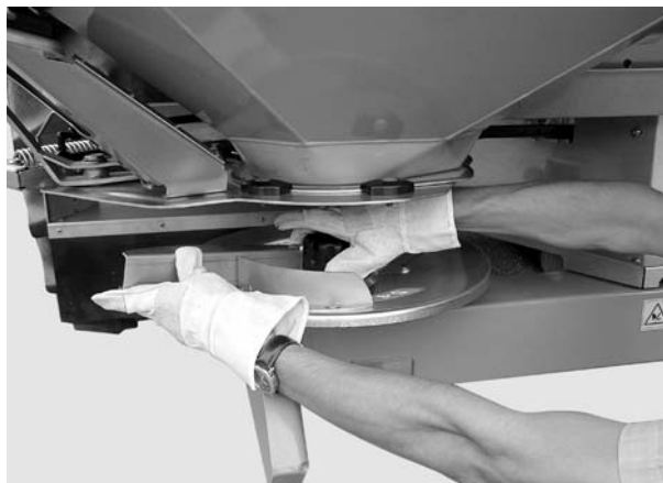
Рисуніок 12: Откручивание колпачковой гайки
