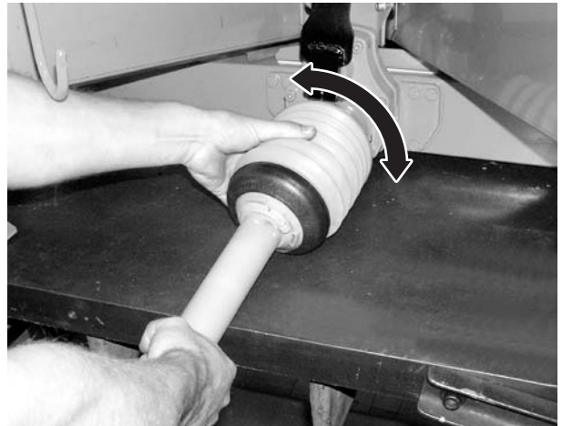
Рисунок 8.4: Прикладывание защитного кожуха карданного вала
