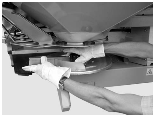
Рисунок 13: Закручивание колпачковой гайки
