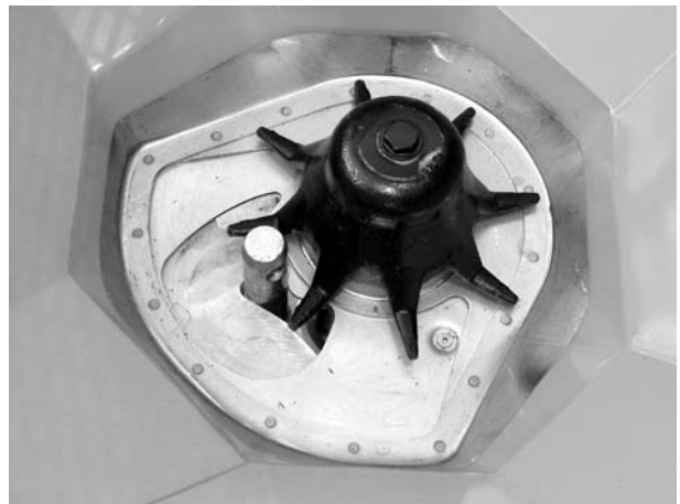
Рисунок 25: Болт нижней тяги в дозирующем отверстии
