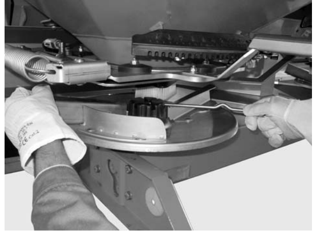
Рисунок 10: Развинчивание колпачковой гайки
