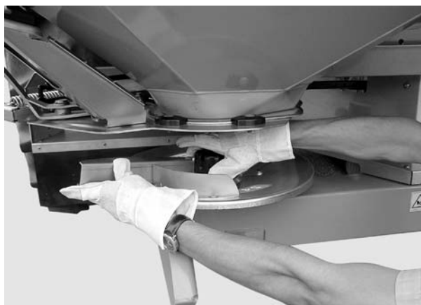
Рисунок 14: Закручивание колпачковой гайки
