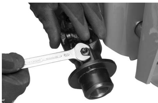
Рисúнок 2: Отвинчивание смазочного ниппеля
