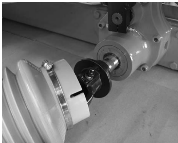
Рисúнок 3: Надевание карданного вала на конец вала редуктора
