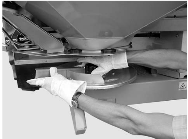
Рисунок 20: Закручивание колпачковой гайки
