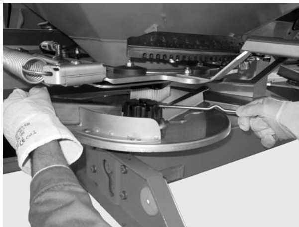
Рисунок 4: Развинчивание колпачковой гайки
