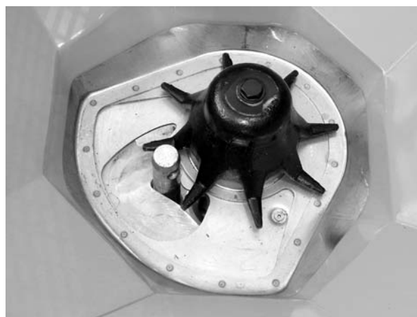
Рисунок 23: Болт нижней тяги в дозирующем отверстии
