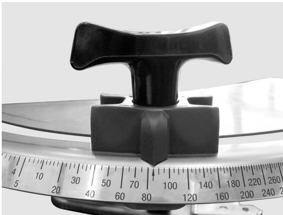
Рисунок 24: Шкала для настройки заслонки дозатора
