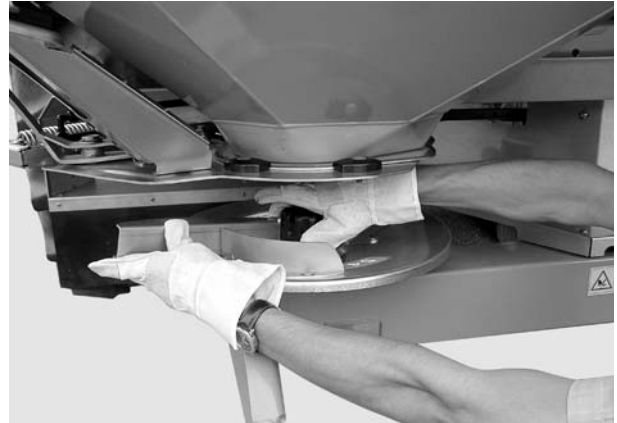
Рисунок 5: Откручивание колпачковой гайки
