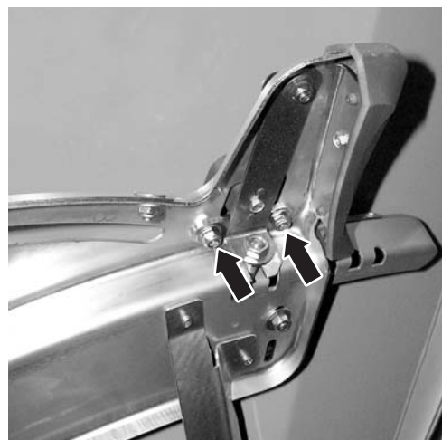
Рисунок 25: Отсоединение юстировочной пластины точки подачи
