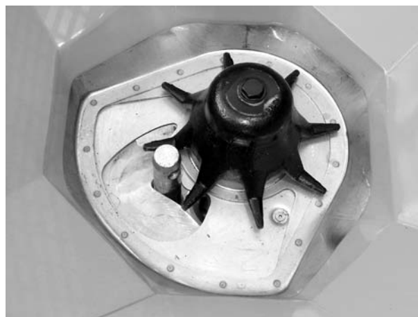
Bilde 23: Trekkstangbolt i doseringsåpning
