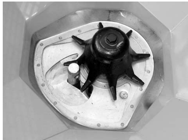
Bilde 25: Trekkstangbolt i doseringsåpning
