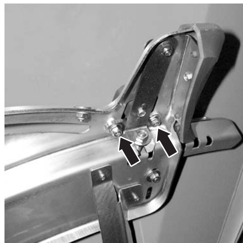
Bilde 25: Løsne justeringsplate utmatingspunkt
