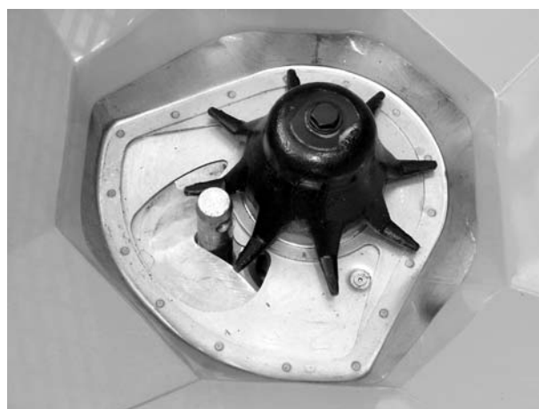
Obrázek 22: Čep spodní spojky v dávkovacím otvoru
