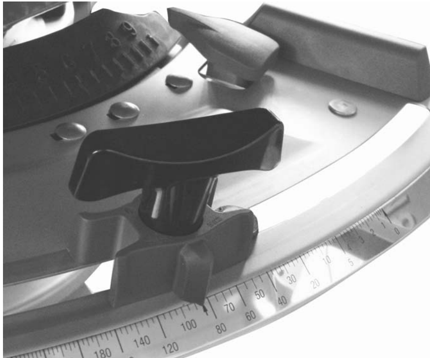
Obrázek 26: Stupnice nastavení dávkovacího hradítka
