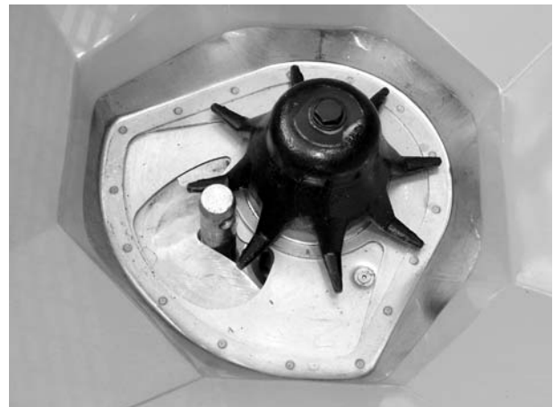
Obrázek 23: Čep spodní spojky v dávkovacím otvoru
