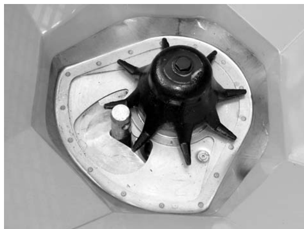
Obrázek 25: Čep spodní spojky v dávkovacím otvoru
