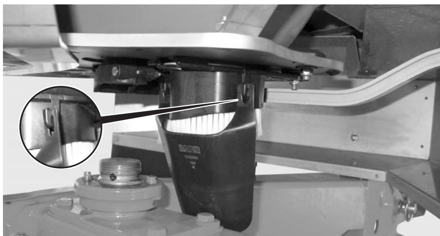
Obrázek 12: Zavěšení žlabu na provedení zkoušky dávky
