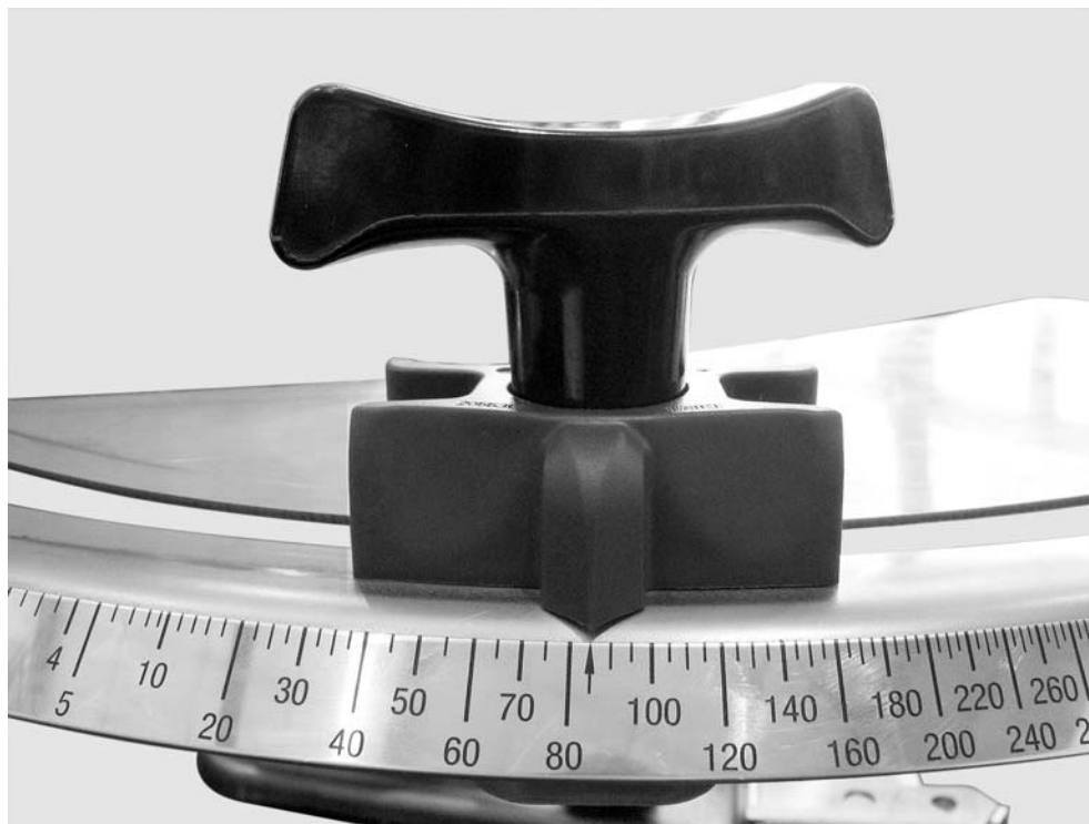
Obrázek 24: Stupnice nastavení dávkovacího hradítka
