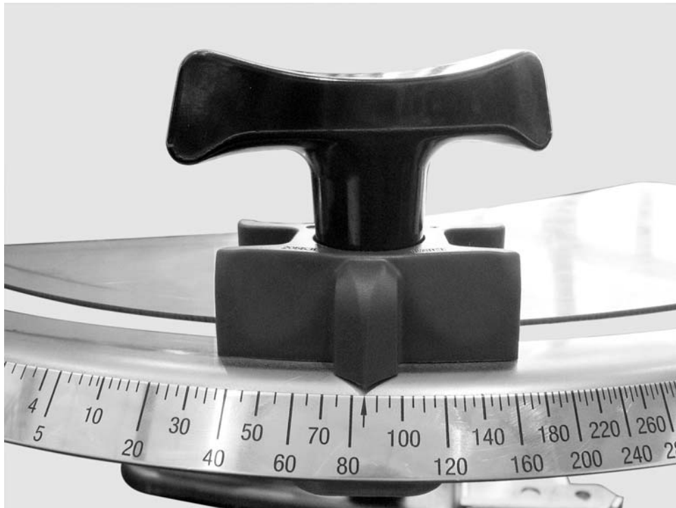
Obrázek 23: Stupnice nastavení dávkovacího hradítka
