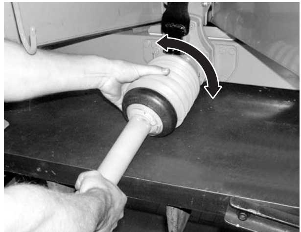
Bild 8.4: Sätt på kraftöverföringsaxelns skydd.
