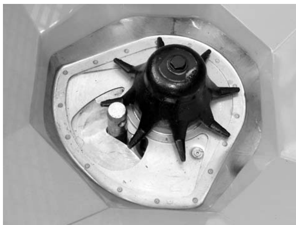
Bild 22: Nedre ledarm i doseringsöppningen
