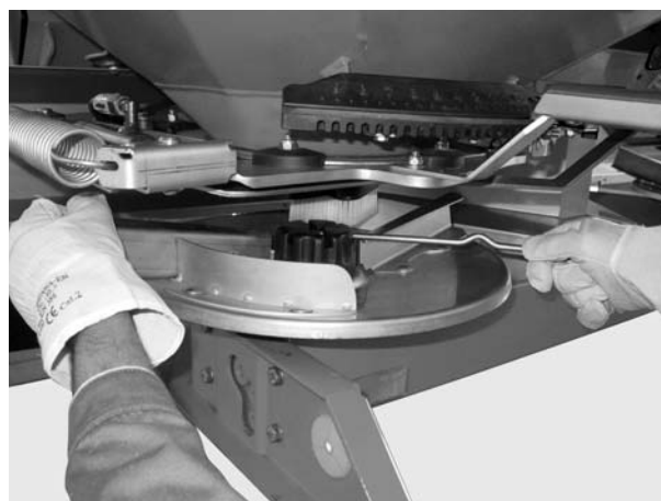
Obrázek 8.3: Povolení uzavřené matice
