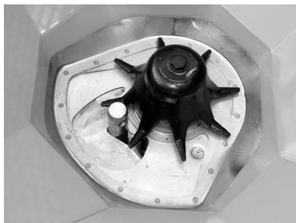
Obrázek 9.13: Čep spodní spojky v dávkovacím otvoru
