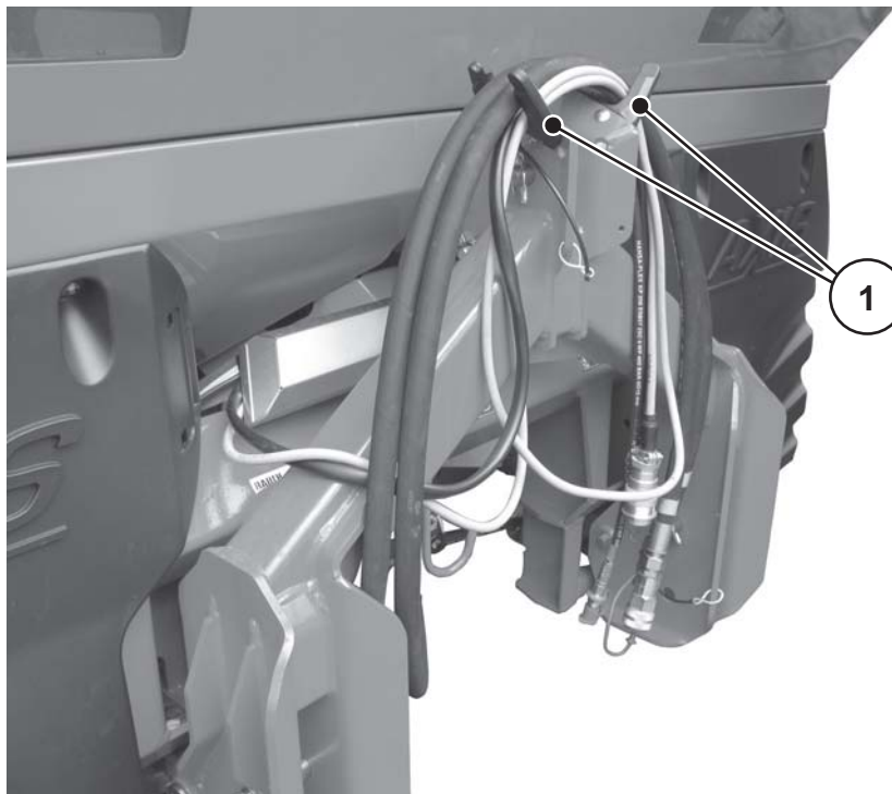
Obrázek 8.10: Uložení kabelů a hydraulických hadic
