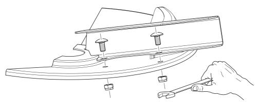
Figure 9.12: Schrauben Wurfflügel lösen
