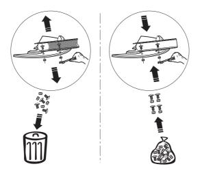
Figure 9.13: Neue selbstsichernde Muttern verwenden
