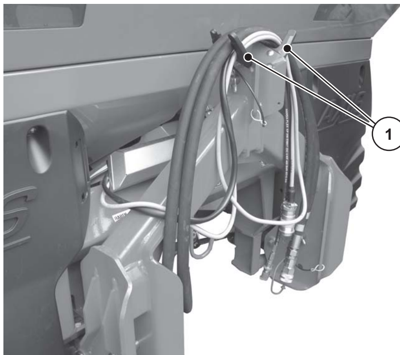
Figure 8.10 : Rangement des câbles et des tuyaux hydrauliques
