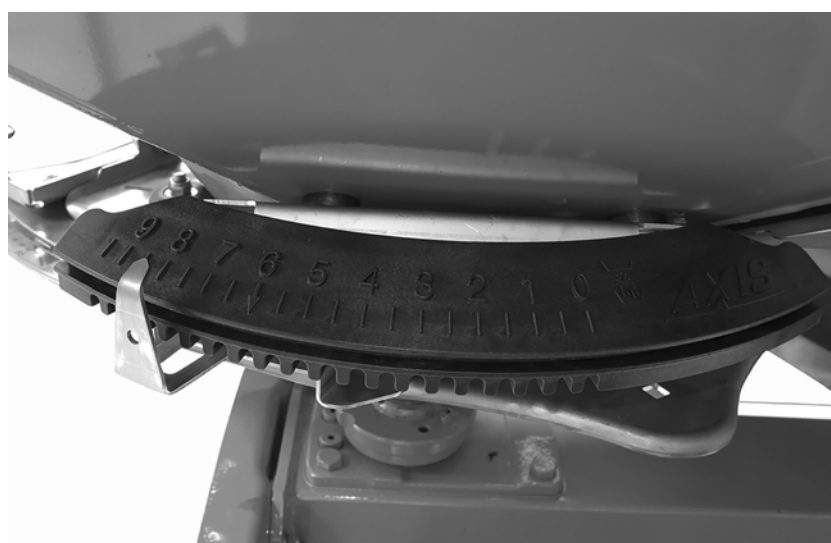
Figure 8.5 : Centre de réglage du point de chute
