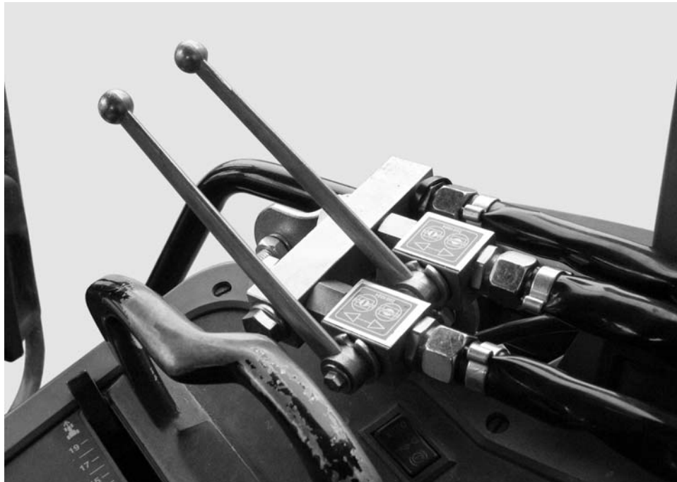
Slika 8: Uređaj za upravljanje zasunom dvosmjerne jedinice
