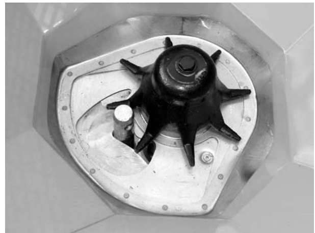
Slika 23: Klin donjeg cilindra u otvoru za doziranje
