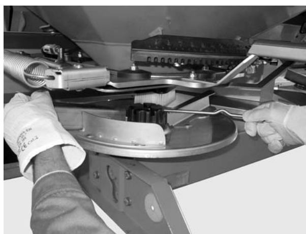
Slika 11: Otpustite zaobljenu slijepu maticu
