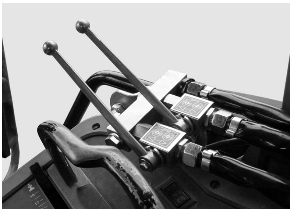
Slika 1: Uređaj za upravljanje zasunom dvosmjerne jedinice
