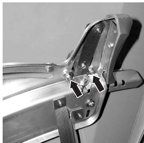
Slika 29: Otpuštanje prilagodne ploče za točku unosa
