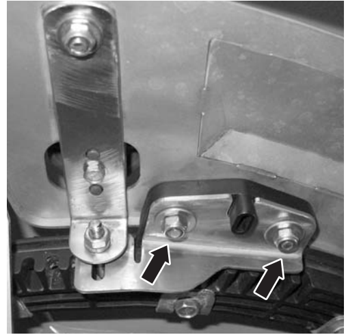
Slika 28: Otpuštanje prilagodne ploče za točku unosa
