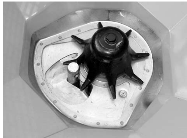
Slika 22: Klin donjeg cilindra u otvoru za doziranje
