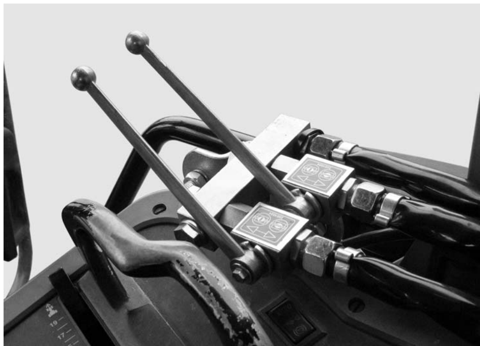
Imagine 1: Dispozitivul de acțiune a sertarului, de la unitatea cu două căi.
