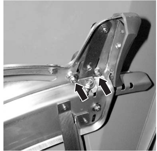
Imagine 29: Slăbiți placa de ajustare pentru punctul de alimentare
