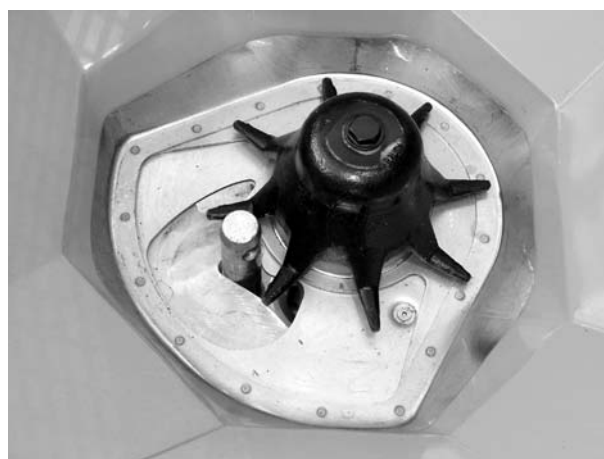
Imagine 23: Bolțul de bară de cuplare inferioară în deschiderea de dozare
