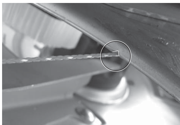
Imagine 31: Marcaje la centrul de reglare
