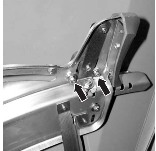
Imagine 25: Slăbiți placa de ajustare pentru punctul de alimentare
