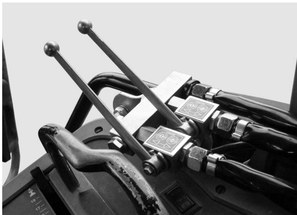
Фиг. 8: : Механизъм за задействане на шибърите на двупътния блок Дозиращите шибъри могат да се задействат поотделно чрез сферичните кранове на двупътния блок.
