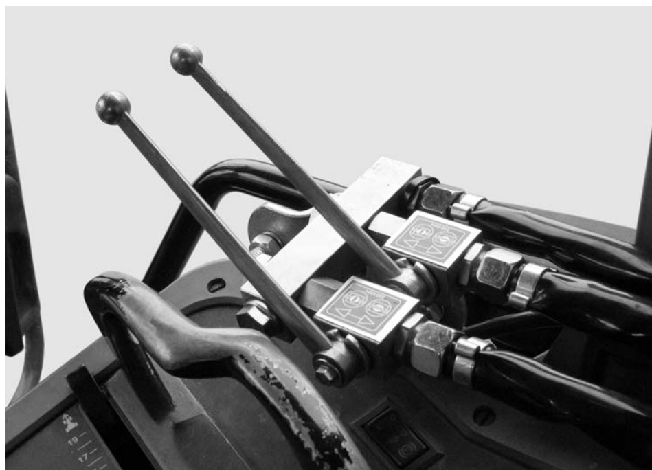
Фиг. 1: : Механизъм за задействане на шибърите на двупътния блок Дозиращите шибъри могат да се задействат поотделно чрез сферичните кранове на двупътния блок.
