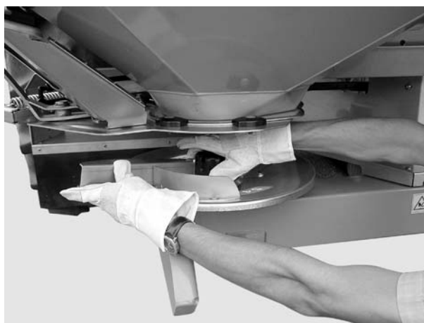
Rysunek 20: Przykręcanie nakrętki kołpakowej
