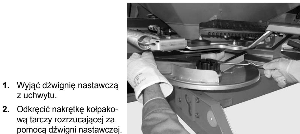
Rysunek 11: Odkręcanie nakrętki kołpakowej
