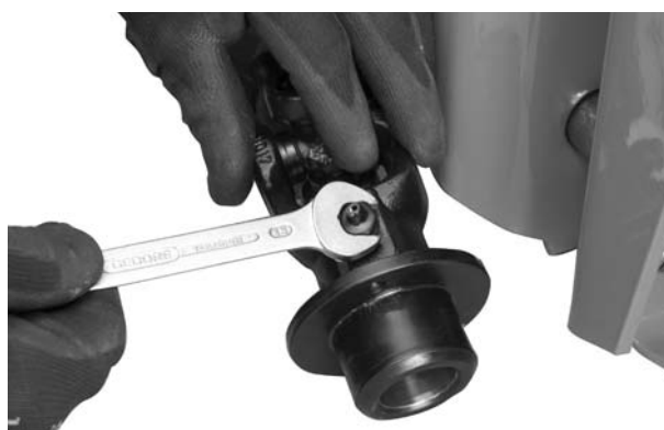
Rysunek 2: Luzowanie gniazda smarowego
