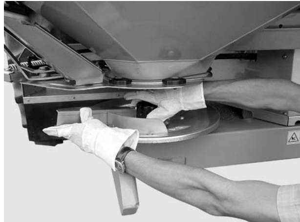
Rysunek 5: Odkręcanie nakrętki kołpakowej
