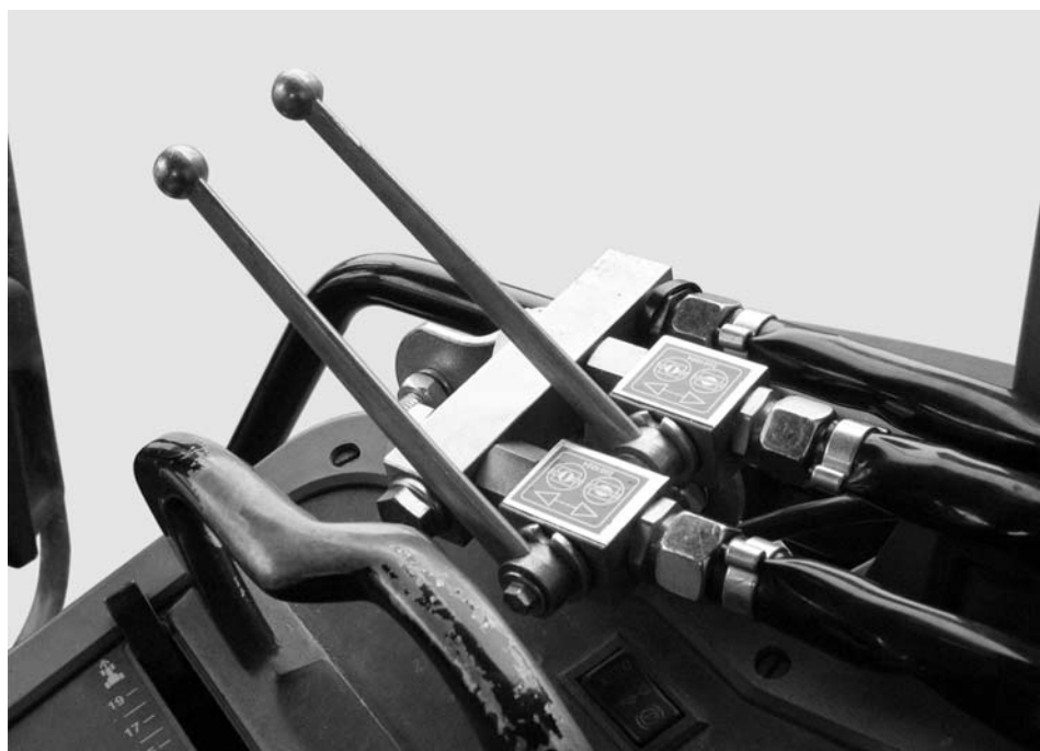
Rysunek 1: Układ sterowania zasuwami jednostki dwudrożnej
