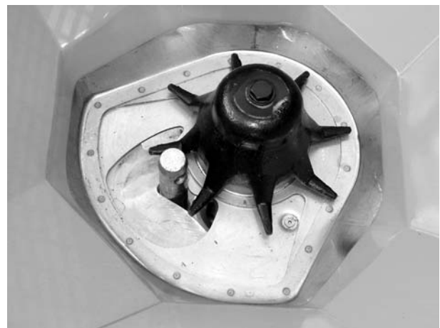
Bild 23: Unterlenkerbolzen in Dosieröffnung
