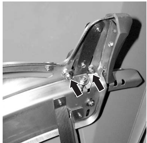
Bild 29: Justageblech Aufgabepunkt lösen
