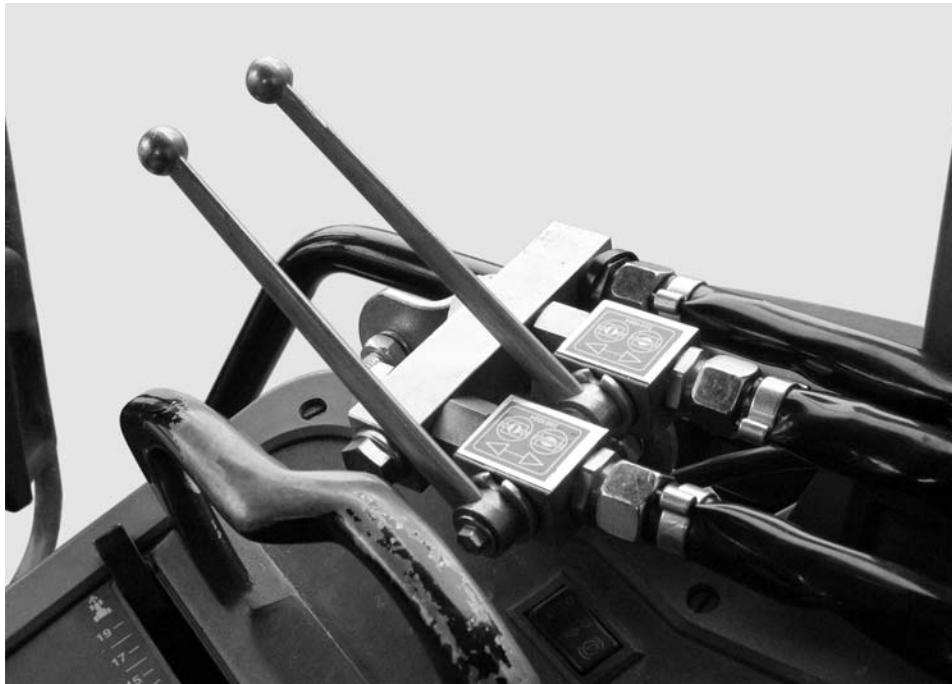
Bild 8: Schieberbetätigung der Zwei-Wege-Einheit
