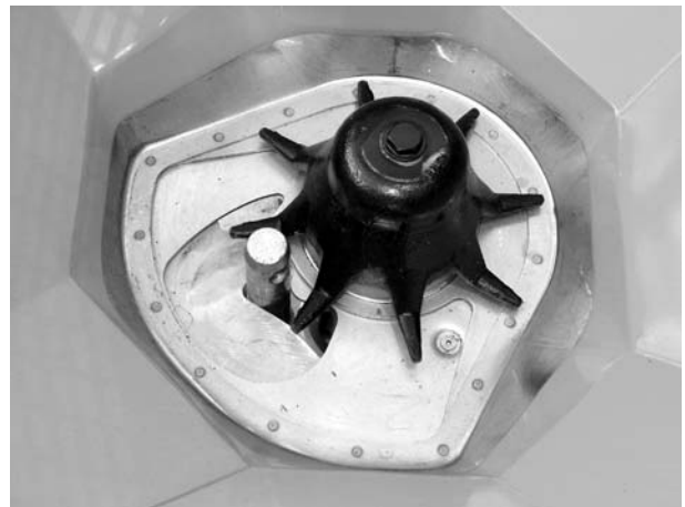
Bild 25: Unterlenkerbolzen in Dosieröffnung
