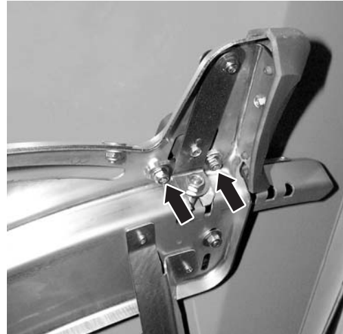
Bild 25: Justageblech Aufgabepunkt lösen
