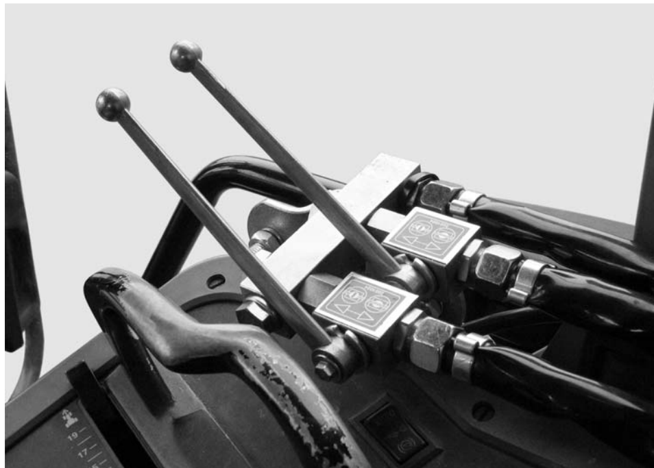
Bild 1: Schieberbetätigung der Zwei-Wege-Einheit
