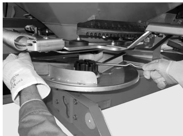
Mynd 12: Losað um hetturó
