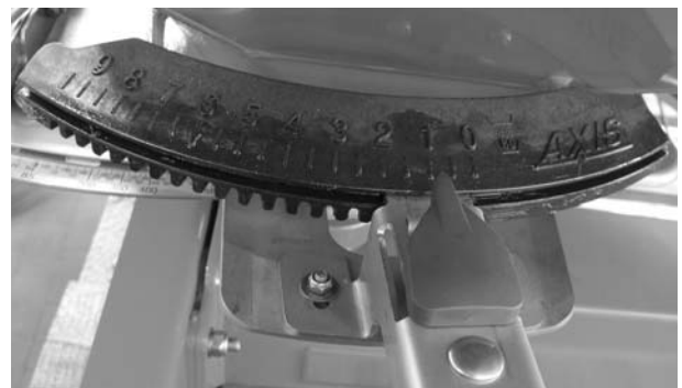
Mynd 42: Stilling útrennslisstaðar athuguð
