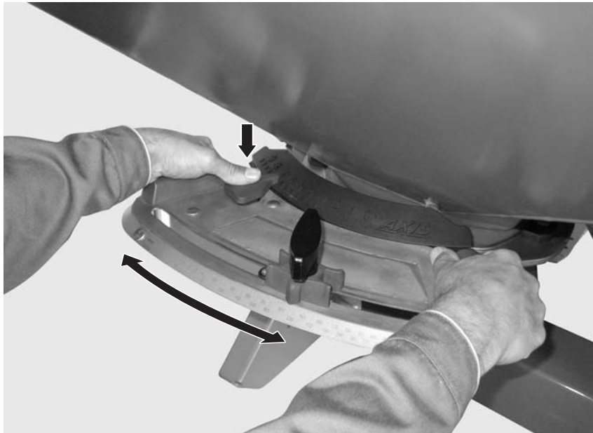
Mynd 14: Stillibúnaður fyrir útrennslisstað
