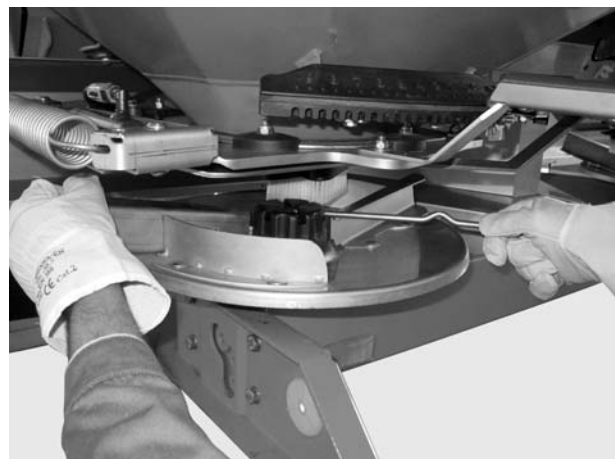
Mynd 11: Losað um hetturó
