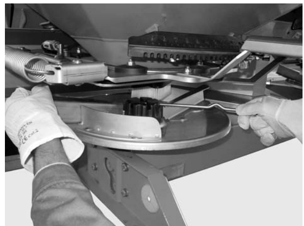
Mynd 11: Losað um hetturó
