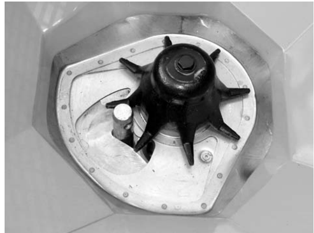
Mynd 22: Beislisbolta í skömmtunaropi
