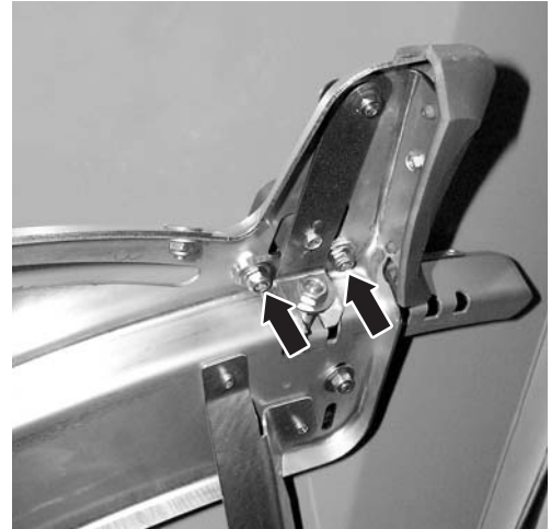
Mynd 25: Stillingarplata útrenslisstaðar losuð
