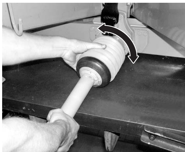
Mynd 8.4: Drifskaftshlífin sett á
