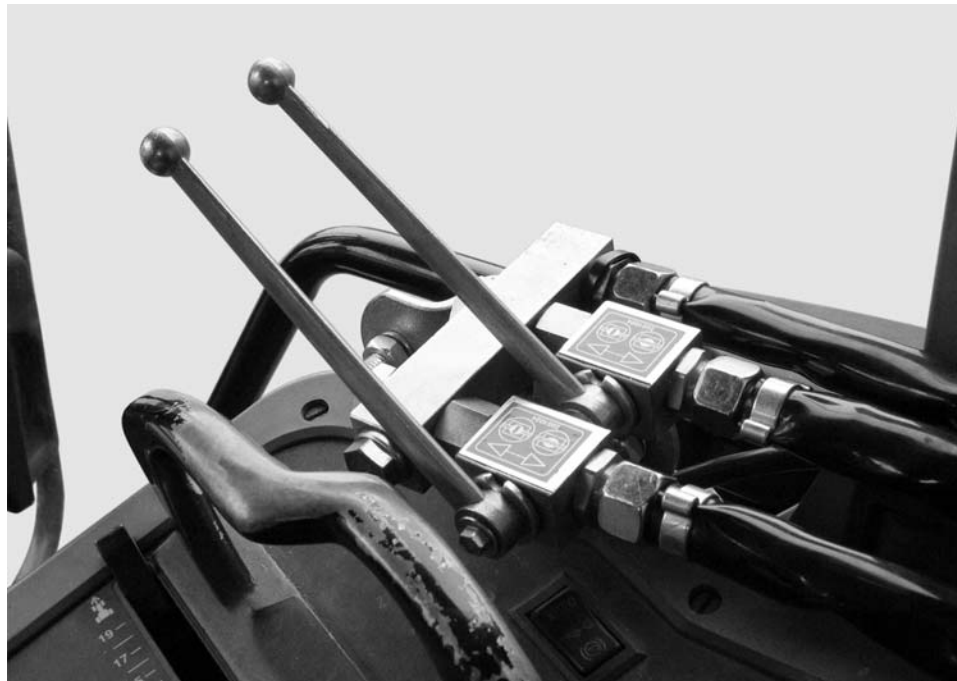
Mynd 1: Stýring skömmtunarops með tvíátta einingu
