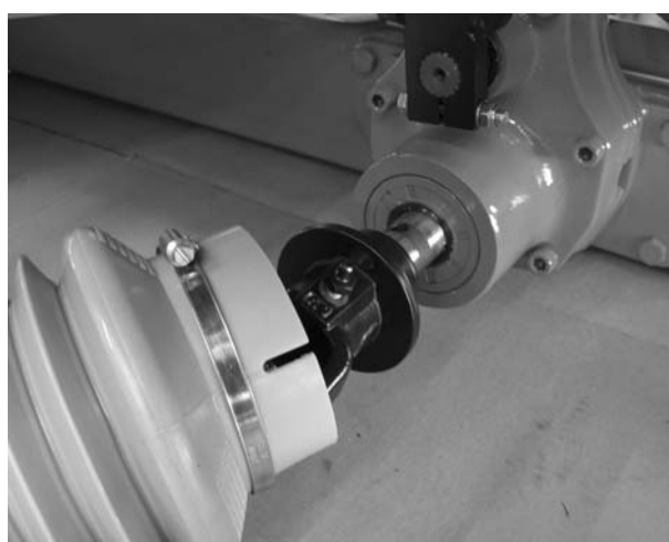
Mynd 3: Drifskaftinu stungið á drifásinn
