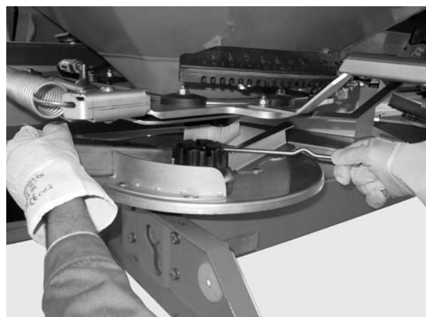
Mynd 4: Losað um hetturó
