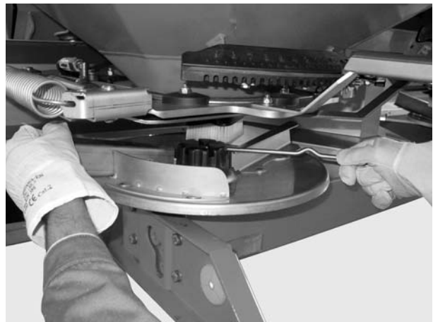
Mynd 5: Losað um hetturó
