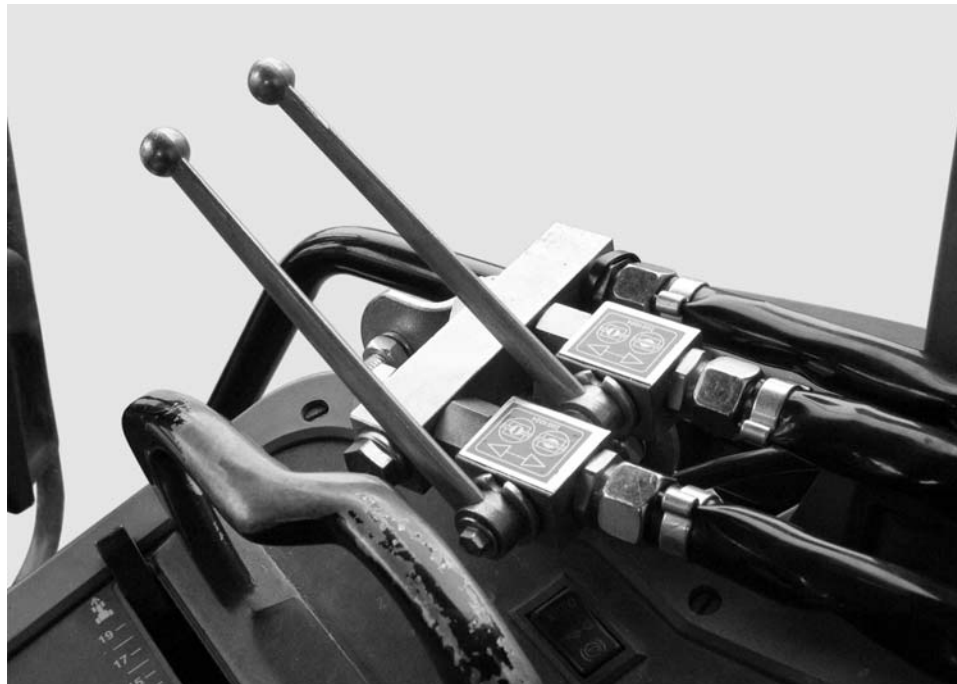
Mynd 8: Stýring skömmtunarops með tvíátta einingu
