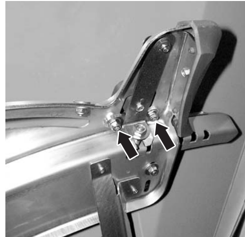
Mynd 34: Stillingarplata útrennslisstaðar losuð
