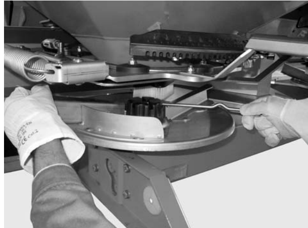
Mynd 18: Losað um hetturó
