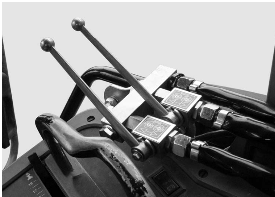
Εικόνα 8: Χειρισμός ολισθητήρα της μονάδας δύο κατευθύνσεων
