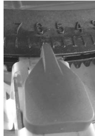
Εικόνα 31: Ρύθμιση σημείου εφαρμογής στη θέση 6
