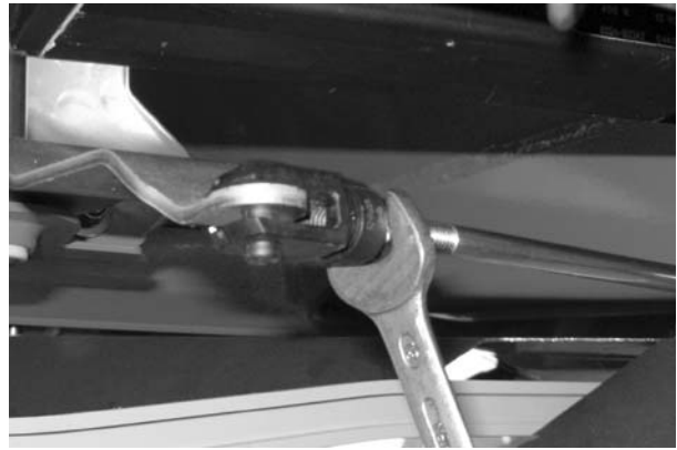
Εικόνα 29: Εισαγωγή εσωτερικής κεφαλής περόνης στη θέση της
