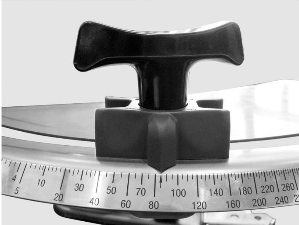
Εικόνα 23: Κλίμακα ρύθμισης συρόμενου δοσομετρητή
