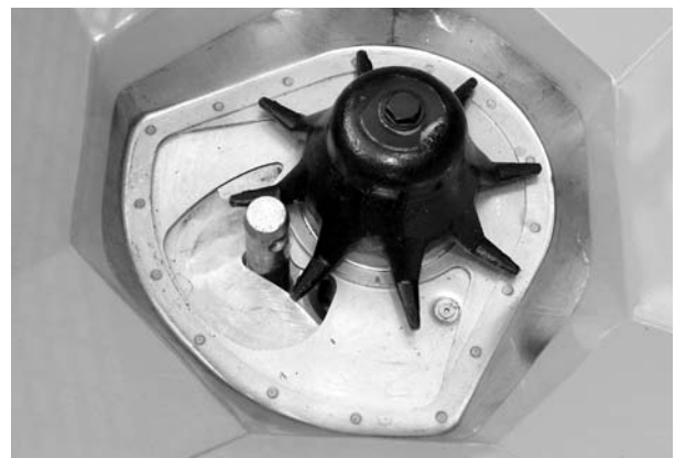
Εικόνα 22: Μπουλόνι κάτω συνδέσμου στο δοσομετρικό στόμιο
