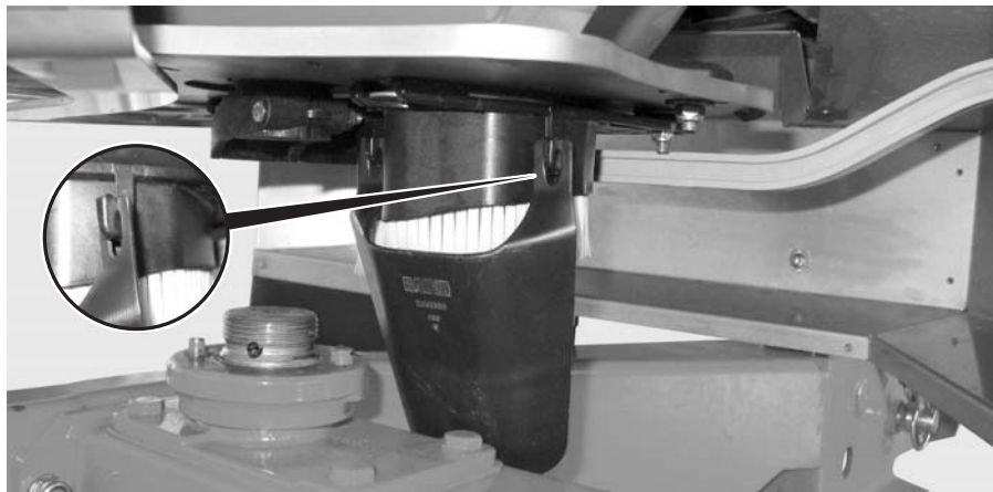
Εικόνα 19: Προσάρτηση ολισθητήρα δοκιμής βαθμονόμησης
