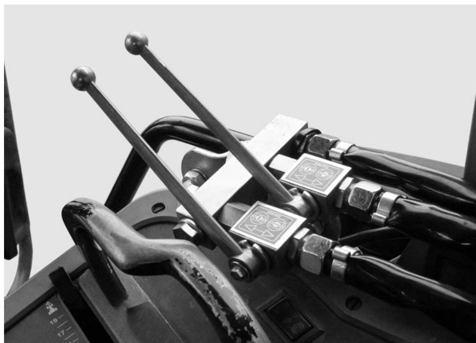
Εικόνα 1: Χειρισμός ολισθητήρα της μονάδας δύο κατευθύνσεων
