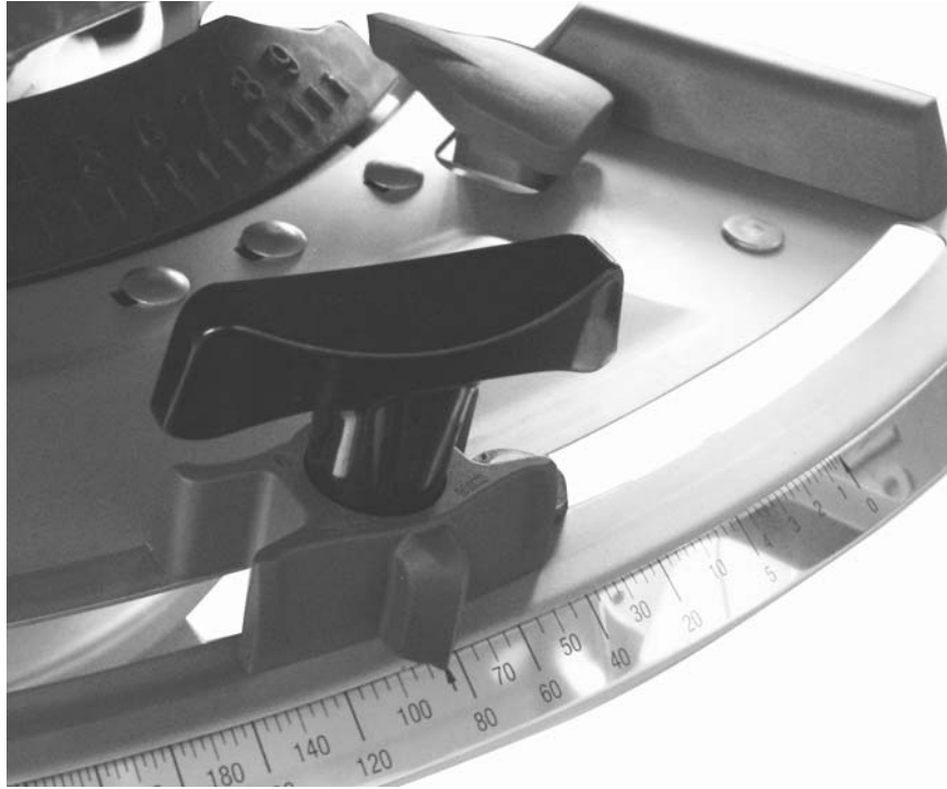
Εικόνα 26: Κλίμακα ρύθμισης συρόμενου δοσομετρητή
