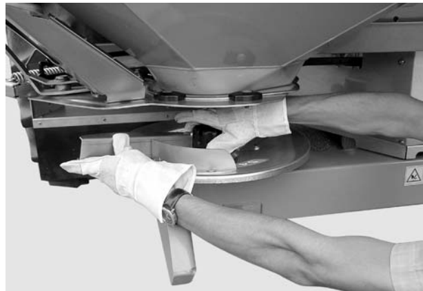
Εικόνα 14: Βίδωμα τυφλού παξιμαδιού
