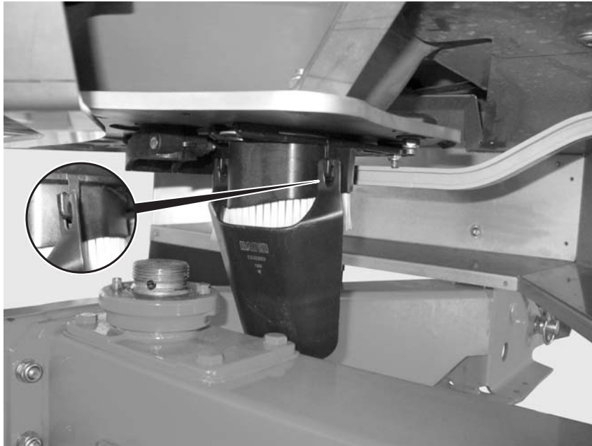
Εικόνα 12: Προσάρτηση ολισθητήρα δοκιμής βαθμονόμησης
