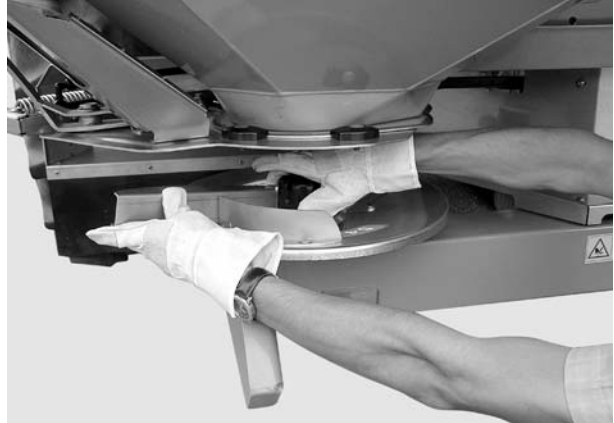
Εικόνα 5: Ξεβίδωμα τυφλού παξιμαδιού
