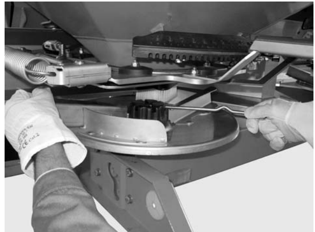
Εικόνα 11: Χαλάρωση τυφλού παξιμαδιού
