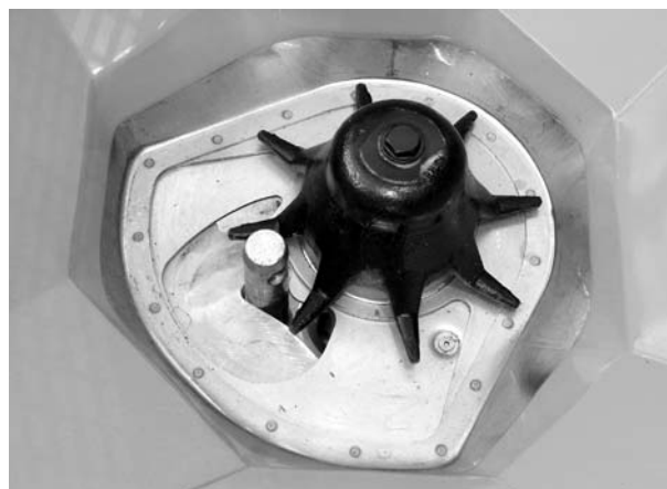
Εικόνα 20: Μπουλόνι κάτω συνδέσμου στο δοσομετρικό στόμιο
