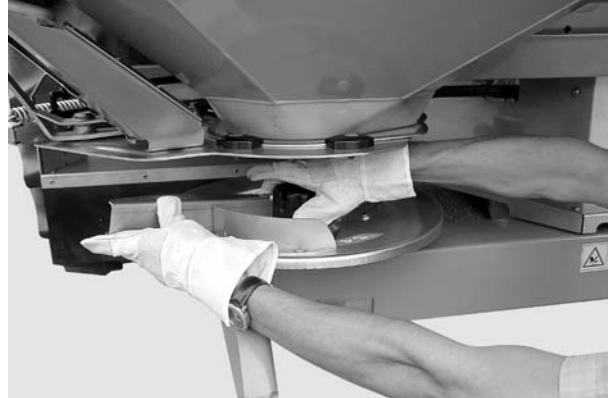
Εικόνα 13: Ξεβίδωμα τυφλού παξιμαδιού
