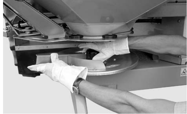
Εικόνα 6: Ξεβίδωμα τυφλού παξιμαδιού
