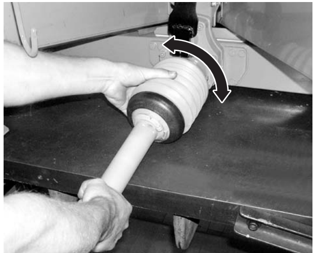
Εικόνα 8.4: Εφαρμογή προστασίας αρθρωτού άξονα
