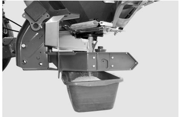
Εικόνα 20: Εκτέλεση δοκιμής βαθμονόμησης
