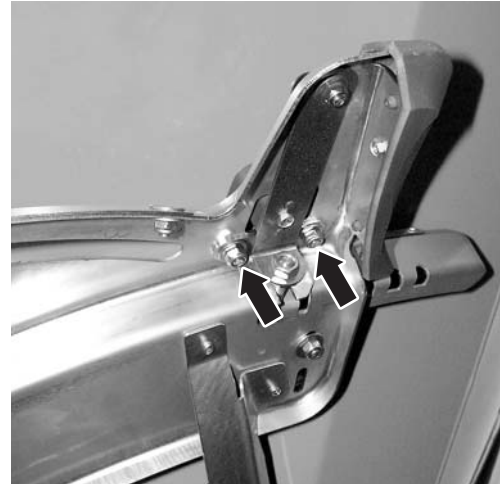
Εικόνα 25: Χαλάρωση ελάσματος ευθυγράμμισης σημείου εφαρμογής
