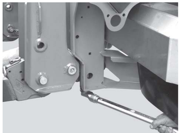
Εικόνα 20: Σύσφιξη του στοιχείου ζύγισης (αριστερά στην κατεύθυνση κίνησης)
