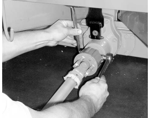
Εικόνα 8.3: Στερέωση αρθρωτού άξονα
