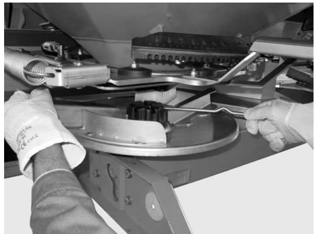
Εικόνα 5: Χαλάρωση τυφλού παξιμαδιού
