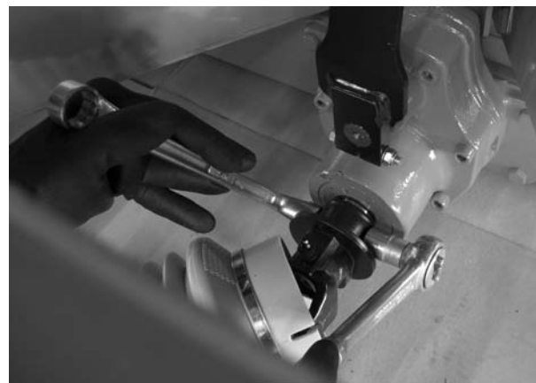
Εικόνα 4: Στερέωση αρθρωτού άξονα
