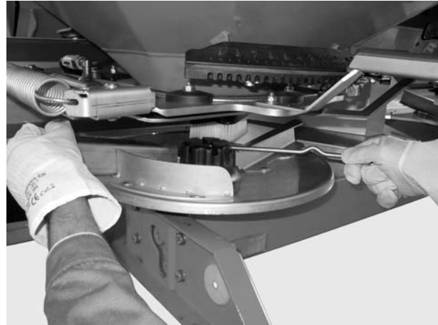
Εικόνα 18: Χαλάρωση τυφλού παξιμαδιού
