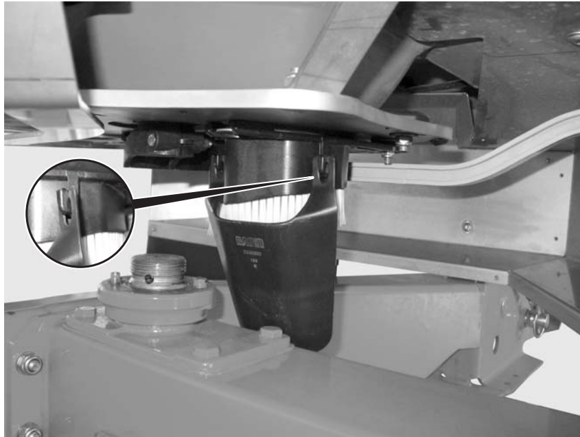
Εικόνα 12: Προσάρτηση ολισθητήρα δοκιμής βαθμονόμησης
