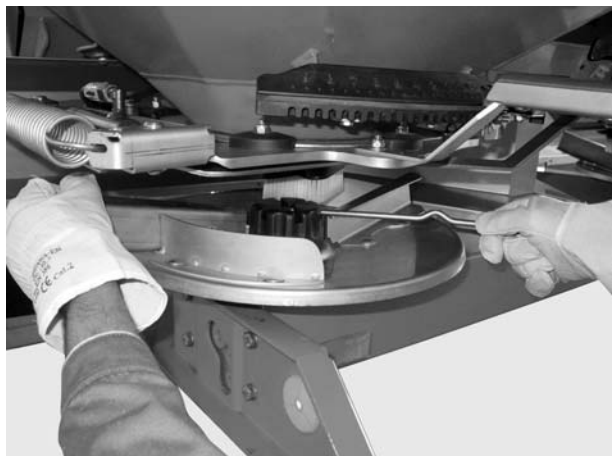
Εικόνα 11: Χαλάρωση τυφλού παξιμαδιού
