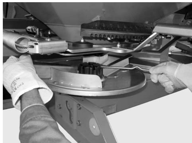
Εικόνα 12: Χαλάρωση τυφλού παξιμαδιού
