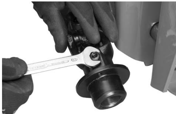
Εικόνα 2: Χαλάρωση στομίου εισαγωγής γράσου
