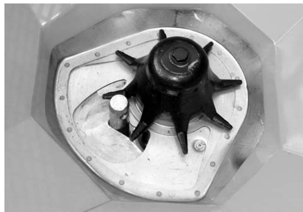
Εικόνα 25: Μπουλόνι κάτω συνδέσμου στο δοσομετρικό στόμιο
