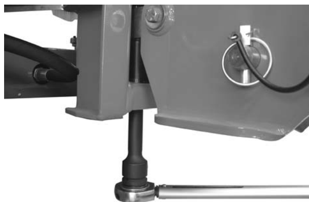
9.1 pav.: Svorio daviklio tvirtinimas (važiavimo kryptimi kairėje pusėje)
