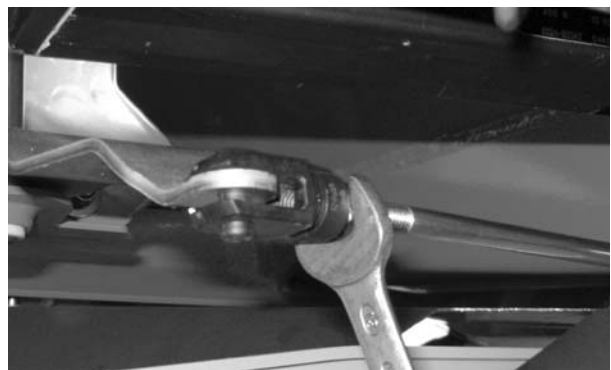
9.19 pav.: Vidinės šakutės galvutės įkabimas
