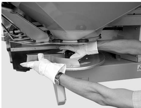
8.4 pav.: Gaubtelinės veržlės išsukimas
