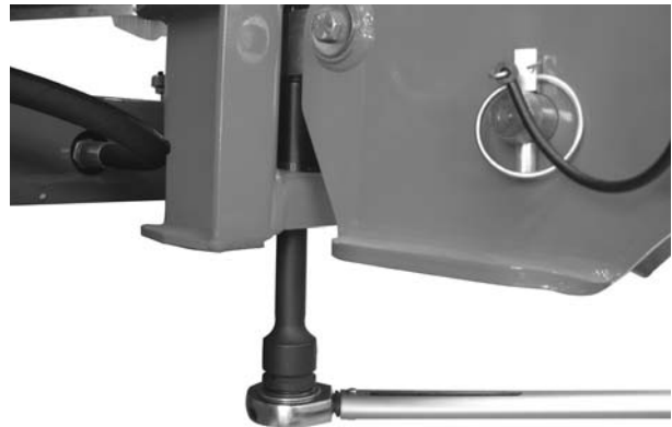
Obrázek 9.1: Upevnění tenzometru (ve směru jízdy vlevo)
