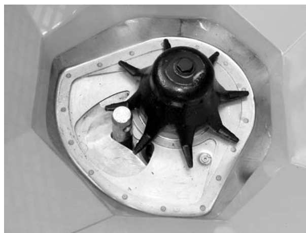
Rysunek 9.13: Trzpień dolnego ramienia podnośnika w otworze dozującym
