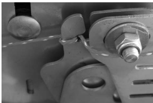
Rysunek 9.23: Przykładanie sznura do jednostki nastawczej
