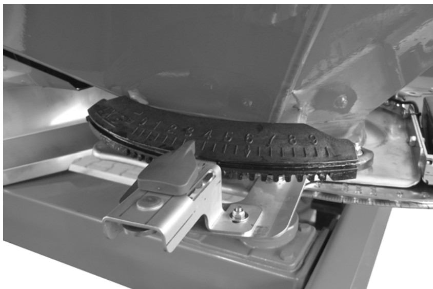
Rysunek 8.5: Wskazanie punktu dozowania nawozu
