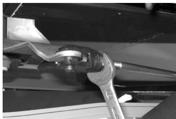
Rysunek 9.19: Zaczepienie wewnętrznej głowicy widelkowej
