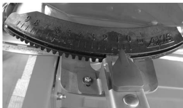
Rysunek 9.30: Sprawdzenie wyregulowania punktów podawania
