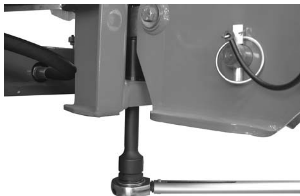
Rysunek 9.1: Zamocowanie sensora wagi (w kierunku jazdy w lewo)
