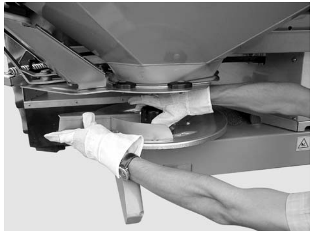
Attēls 6: Cepures veida uzgriežņa noskrūvēšana
