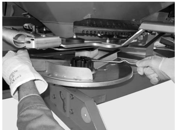
Attēls 5: Cepures veida uzgriežņa atbrīvošana
