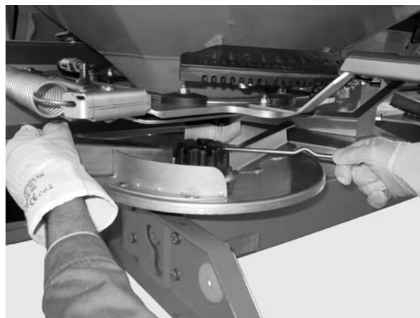
Attēls 11: Cepures veida uzgriežņa atbrīvošana
