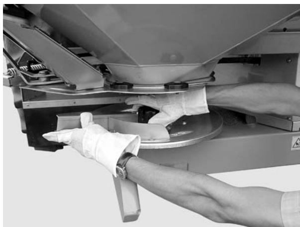
Attēls 14: Cepures veida uzgriežņa pieskrūvēšana
