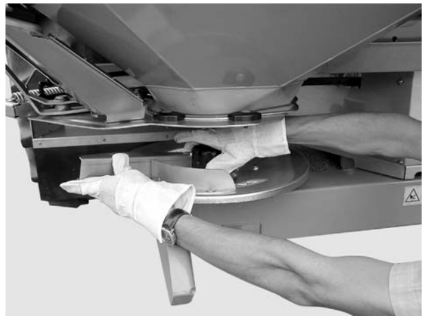
Attēls 14: Cepures veida uzgriežņa pieskrūvēšana
