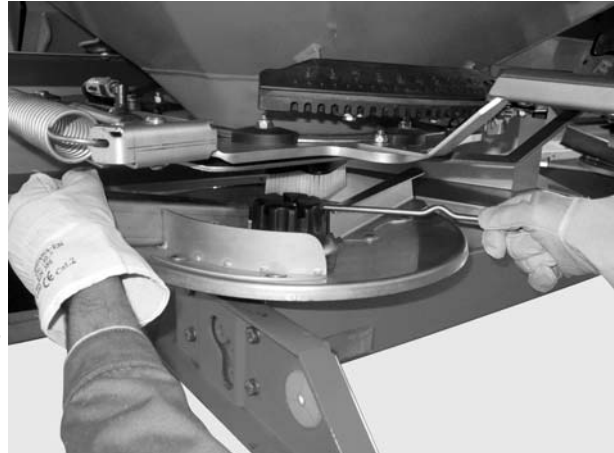
Attēls 18: Cepures veida uzgriežņa atbrīvošana
