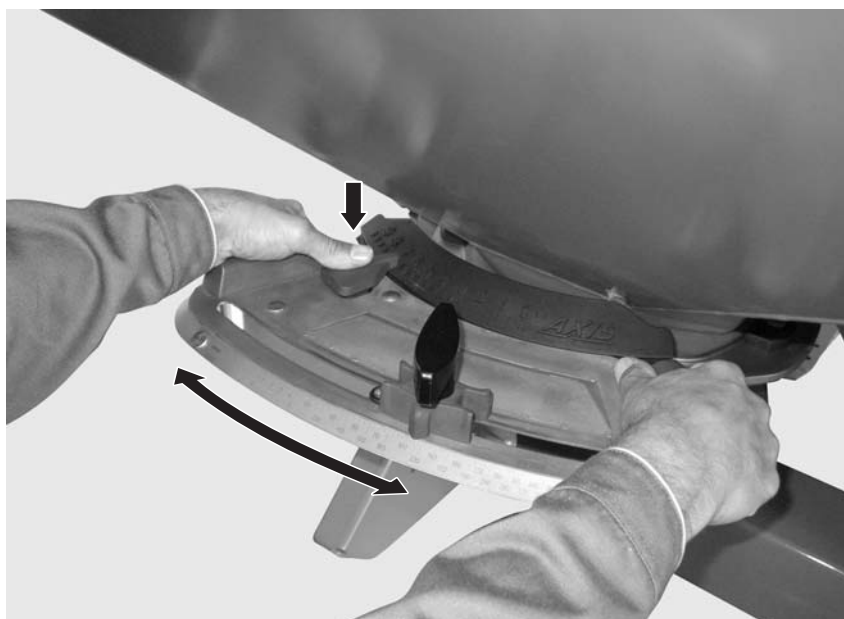
Attēls 14: Iestatīšanas centrs Padeves punkts
