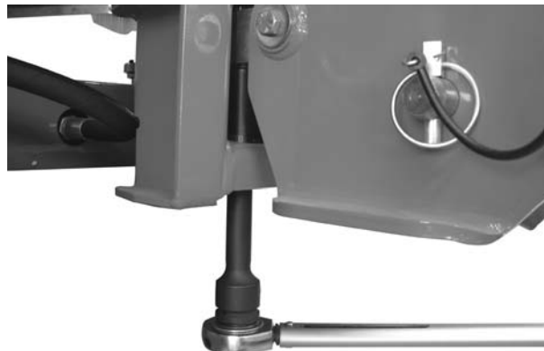
Attēls 18: Svāra devēja stiprinājums (braukšanas virzienā kreisajā pusē)
