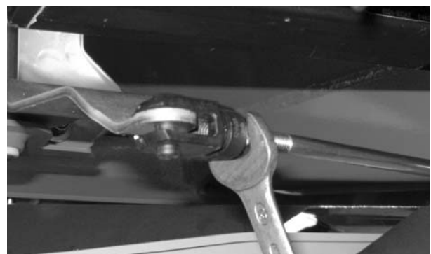
Attēls 29: Iekšējās dakšas galvas pievienošana
