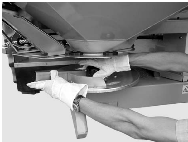
Attēls 13: Cepures veida uzgriežņa noskrūvēšana
