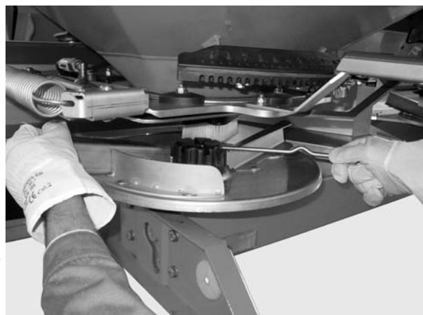
Attēls 12: Cepures veida uzgriežņa atbrīvošana
