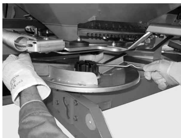
Attēls 11: Cepures veida uzgriežņa atbrīvošana
