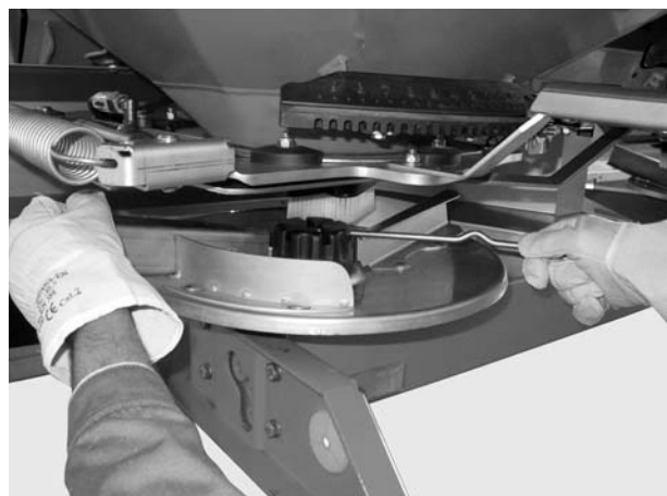
Attēls 4: Cepures veida uzgriežņa atbrīvošana
