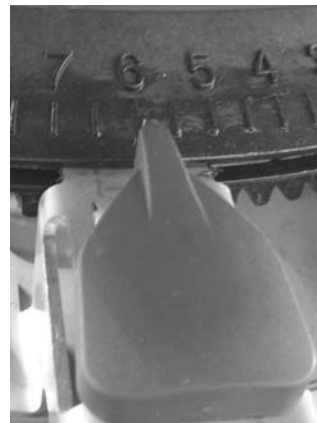
Attēls 31: Padeves punktu iestatiet pozīcijā 6.
