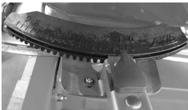
Attēls 42: Pārbaudiet padeves punkta regulējumu.
