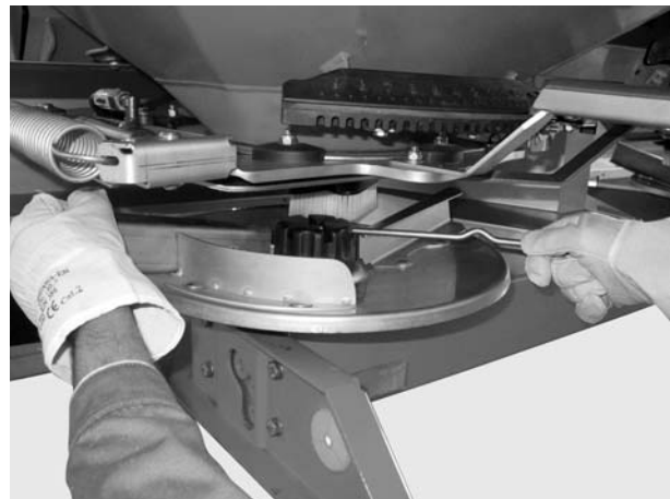
Joonis 12: Keerake kübarmutter lahti
