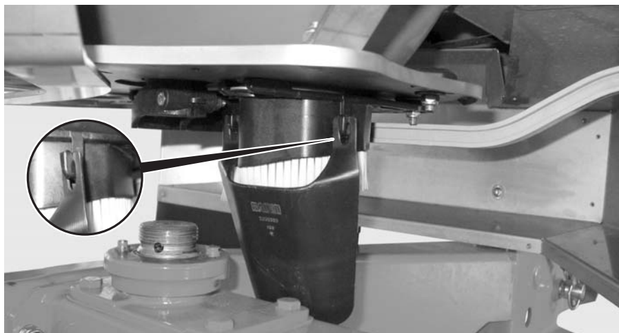
Joonis 19: Annustuskatse renni kinnitamine
