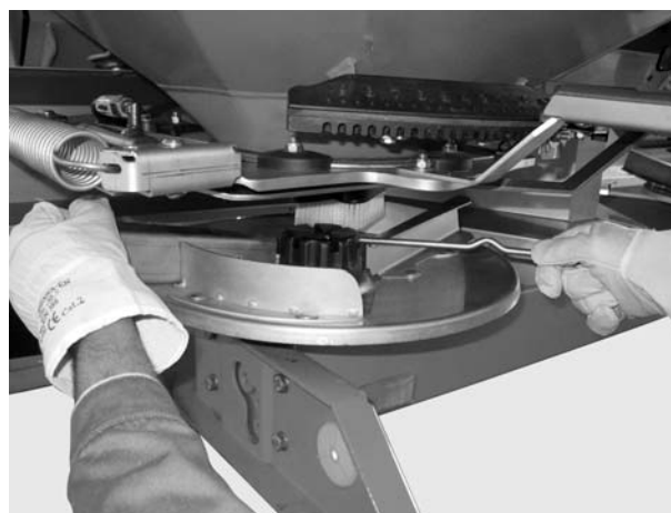
Joonis 11: Keerake kübarmutter lahti
