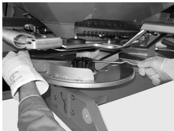
Joonis 11: Keerake kübarmutter lahti
