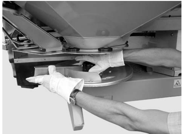
Joonis 21: Keerake kübarmutter lahti
