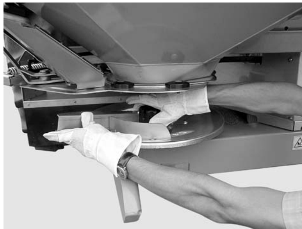
Joonis 5: Kübarmutri lahtikeeramine
