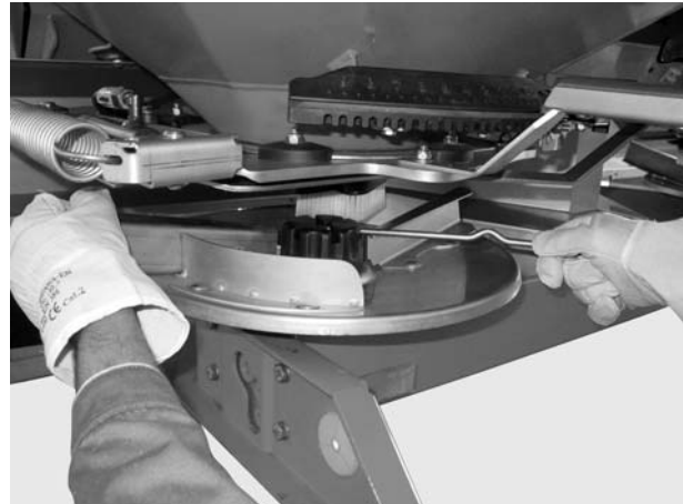
Joonis 18: Keerake kübarmutter lahti
