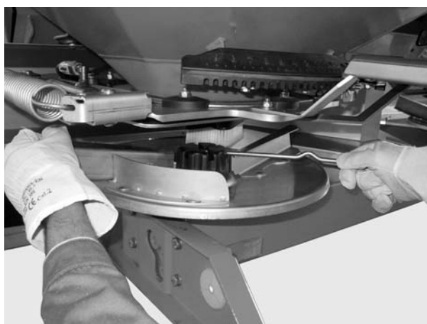
Joonis 4: Keerake kübarmutter lahti
