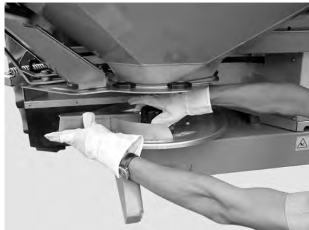
Obrázok 21: Uzavretú maticu naskrutkujte
