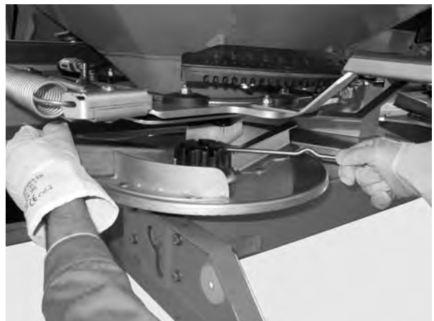
Obrázok 4: Uzavretú maticu uvoľnite
