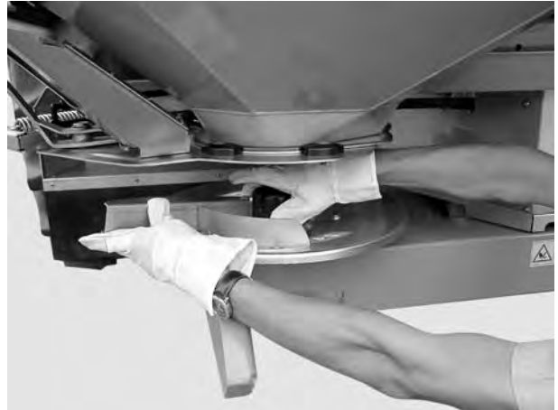
Obrázok 6: Odskrutkovanie uzavretej matice
