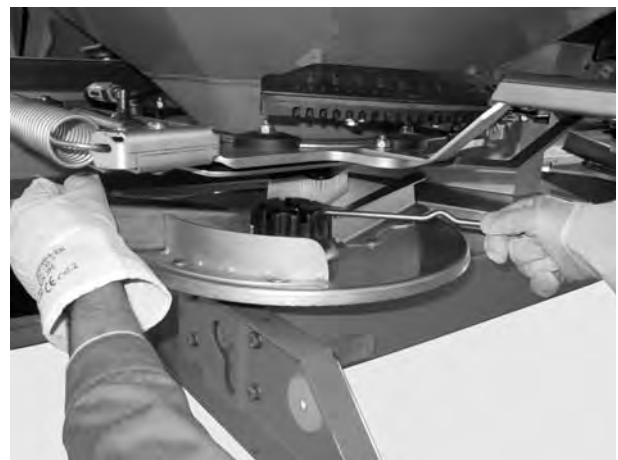
Obrázok 11: Uzavretú maticu uvoľnite
