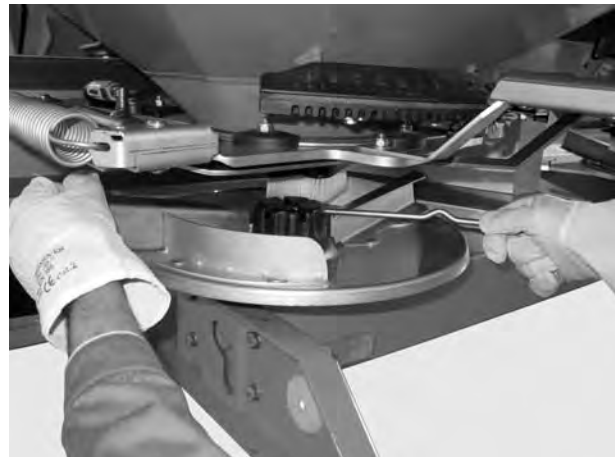
Obrázok 11: Uvoľnenie uzavretej matice
