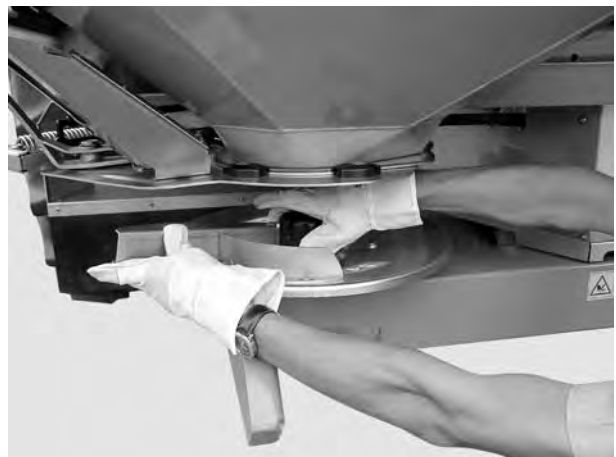
Obrázok 14: Zaskrutkovanie uzavretej matice
