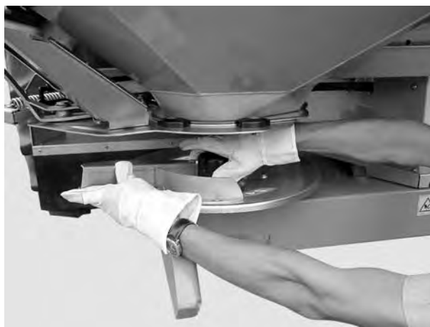
Obrázok 14: Zaskrutkovanie uzavretej matice
