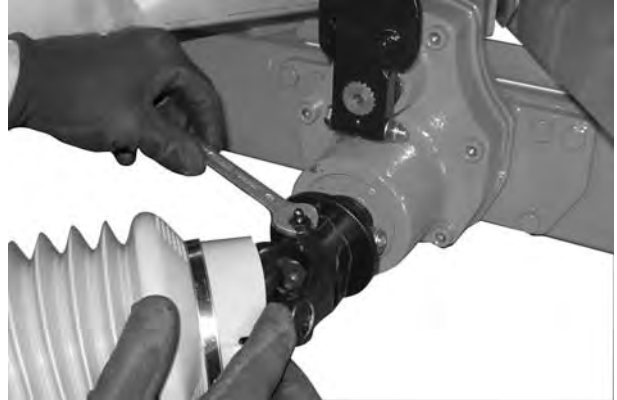
Obrázok 5: Uťahnutie mazacej hlavice
