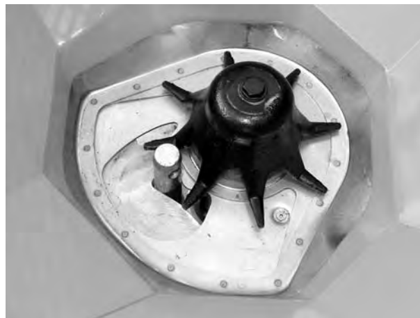
Obrázok 20: Čap dolného ramena nápravy v dávkovacom otvore
