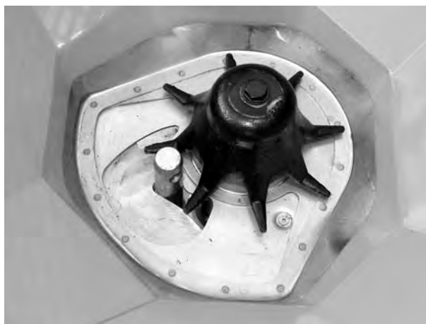
Obrázok 22: Čap dolného ramena nápravy v dávkovacom otvore
