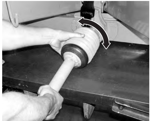
Obrázok 6: Založenie ochrany kĺbového hriadeľa
