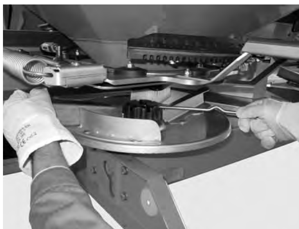
Obrázok 18: Uvoľnenie uzavretej matice
