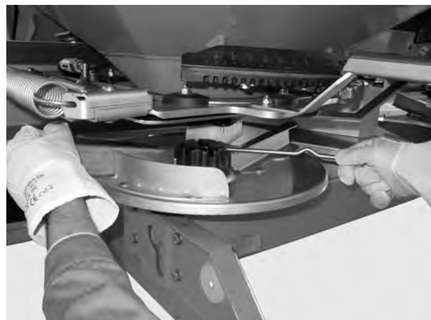
Obrázok 12: Uzavretú maticu uvoľnite
