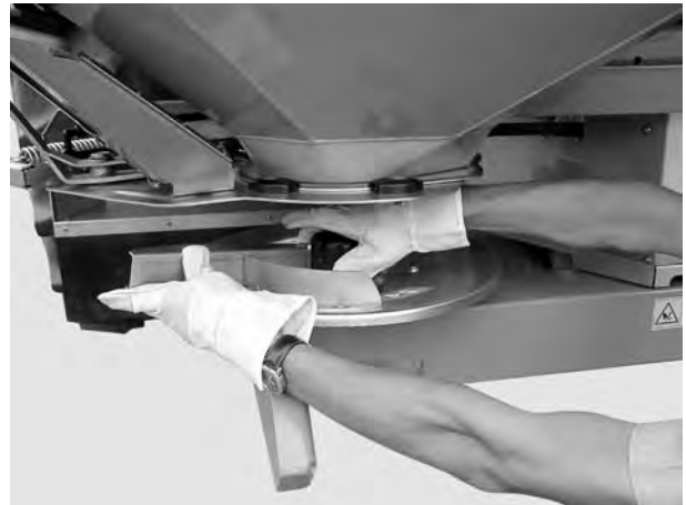
Obrázok 13: Odskrutkovanie uzavretej matice
