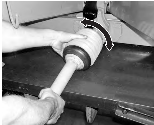
Obrázok 8.4: Založenie ochrany kĺbového hriadeľa
