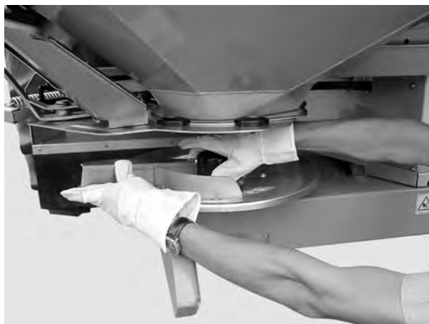
Obrázok 5: Odskrutkovanie uzavretej matice
