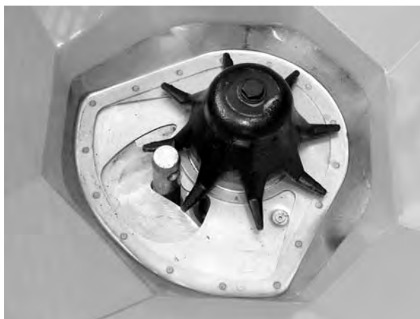
Obrázok 25: Čap dolného ramena nápravy v dávkovacom otvore
