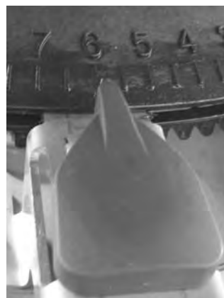
Obrázok 31: Nastavenie bodu aplikácie do polohy 6
