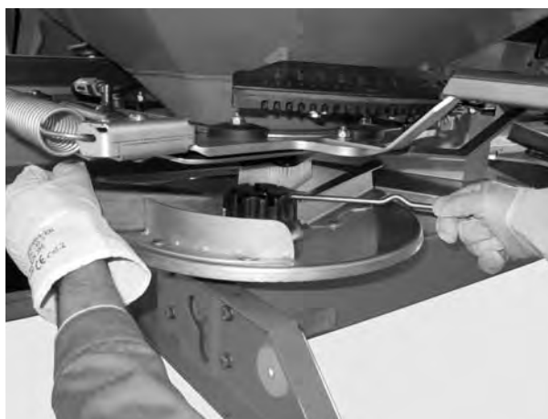
Obrázok 5: Uvoľnenie uzavretej matice
