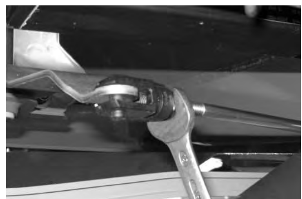
Obrázok 29: Zaviesenie vnútornej hlavy vidlice
