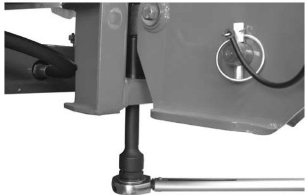
Afb. 9.1: Bevestiging van de weegcel (in rijrichting links)
