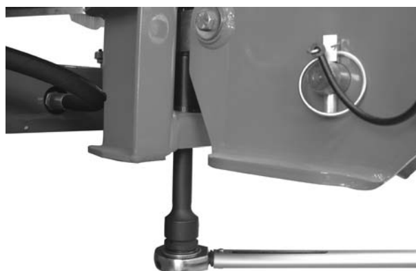
Bild 9.1: Montering av vågcellen (på vänster sida i körriktningen)
