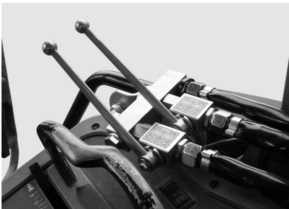
Slika 8: Hidraulično upravljanje zasunima za doziranje preko dvorazvodne jedinice
