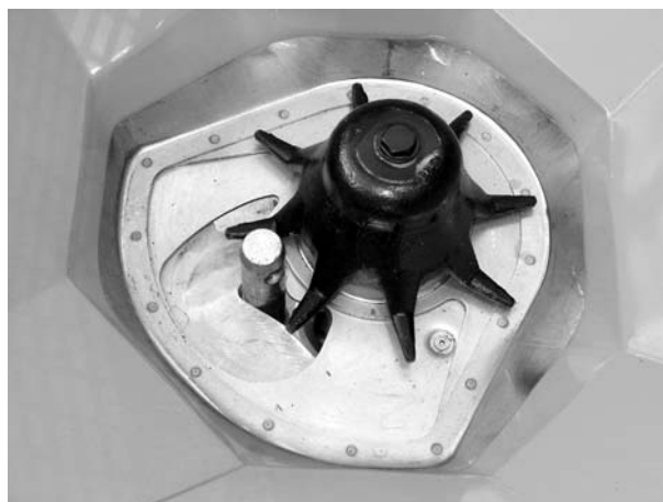
Slika 22: Sornik spodnje ročice v dozirni odprtini
