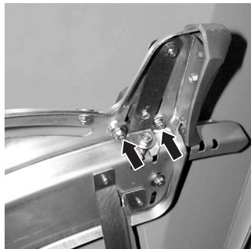
Slika 34: Sprostitev nastavitvene plošče točke izmeta
