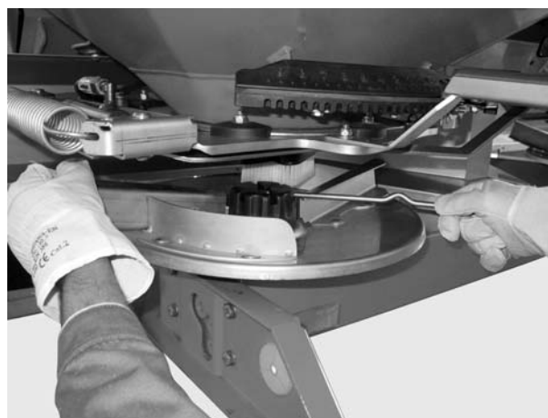
Slika 11: Odvijte zaprto matico
