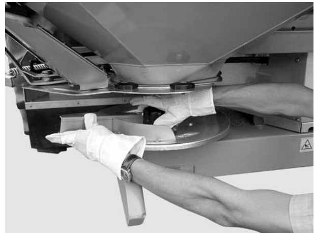
Slika 6: Odvijte zaprto matico.
