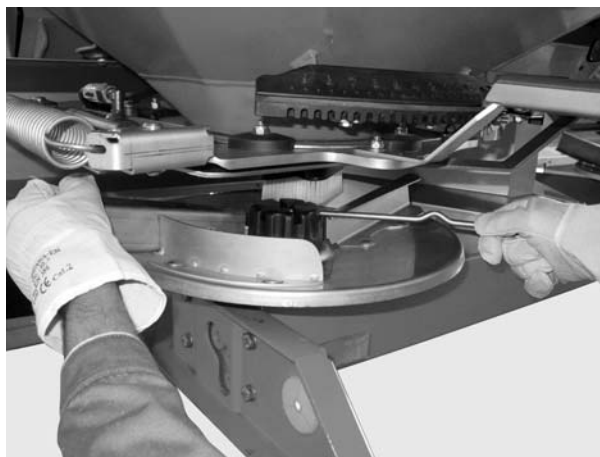
Slika 12: Odvijte zaprto matico
