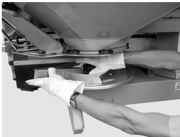
Slika 13: Odvijte zaprto matico.
