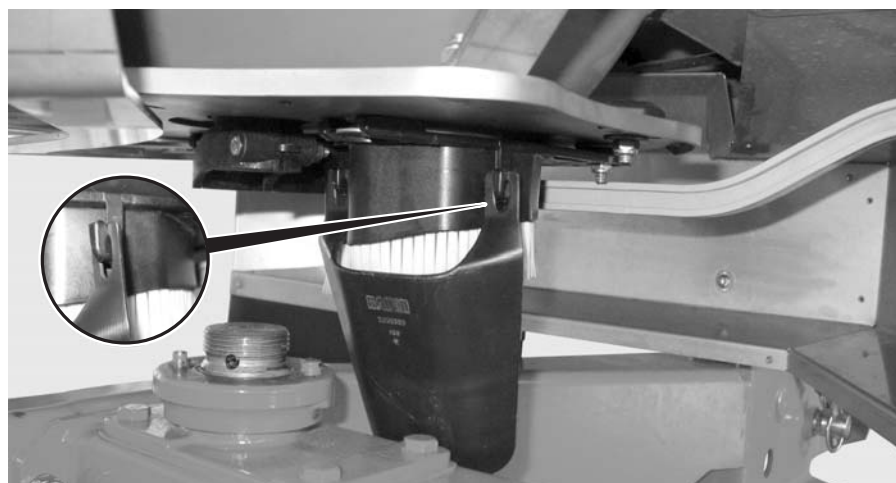
Slika 19: Namestitev žleba za preizkus trosilnika
