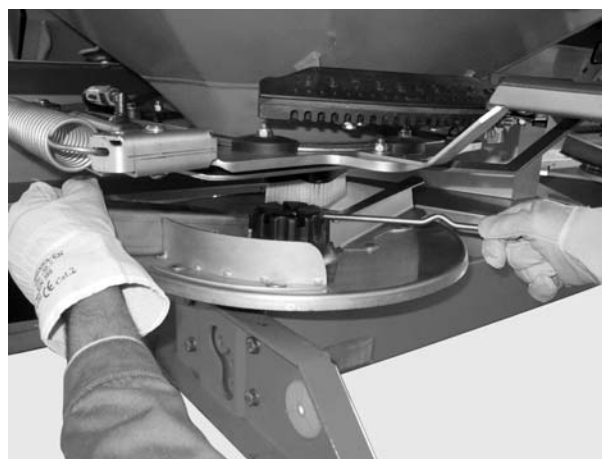
Slika 11: Odvijte zaprto matico
