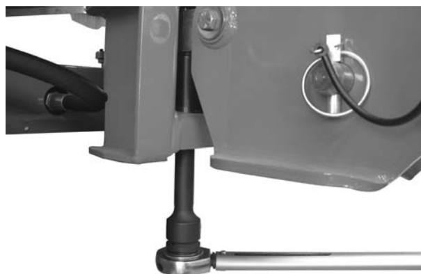
Slika 18: Pritrditev merilne celice (na levi strani, gledano v smeri vožnje)
