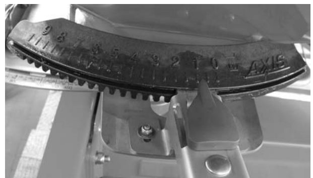
Slika 42: Preverjanje poravnave točke izmeta gnojila
