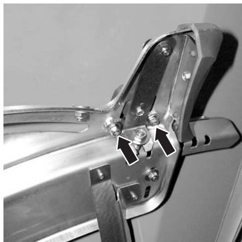
Slika 25: Sprostitev nastavitvene plošče točke izmeta
