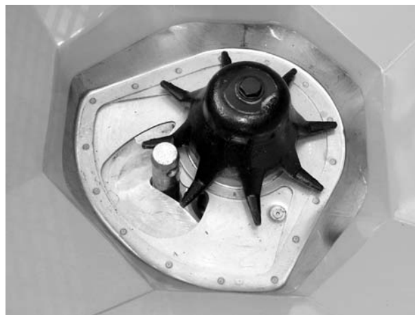
Slika 20: Sornik spodnje ročice v dozirni odprtini
