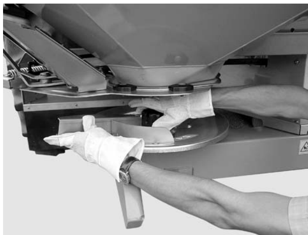
Slika 21: Privijanje zaprte matice
