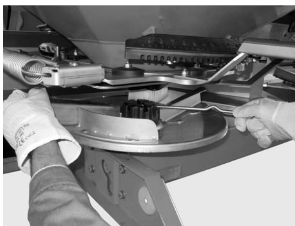
Slika 5: Odvijte zaprto matico
