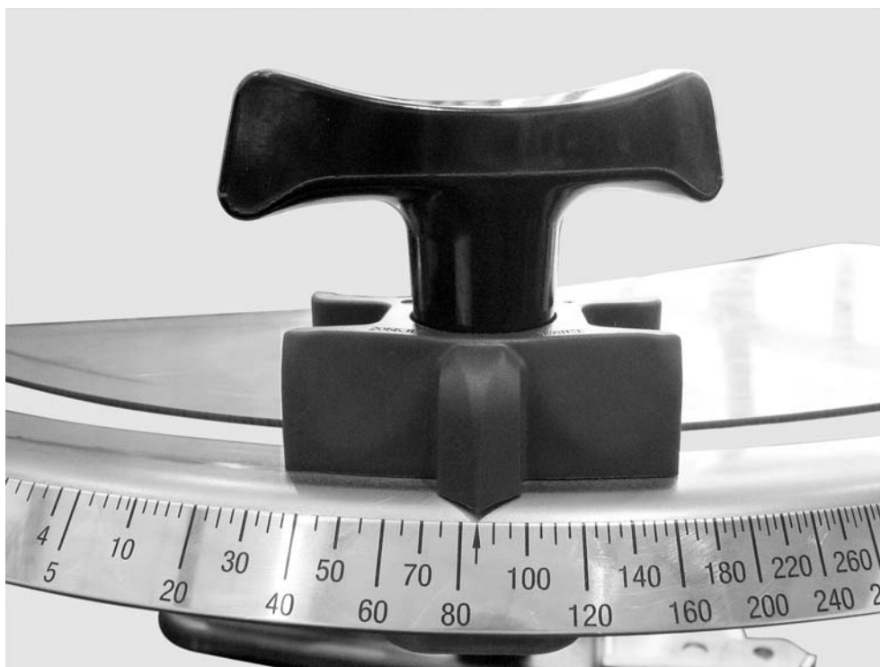
Imagine 23: Scara gradată pentru reglarea cursorului de dozare
