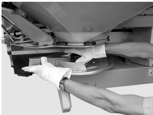
Imagine 5: Deșurubarea piuliței înfundate
