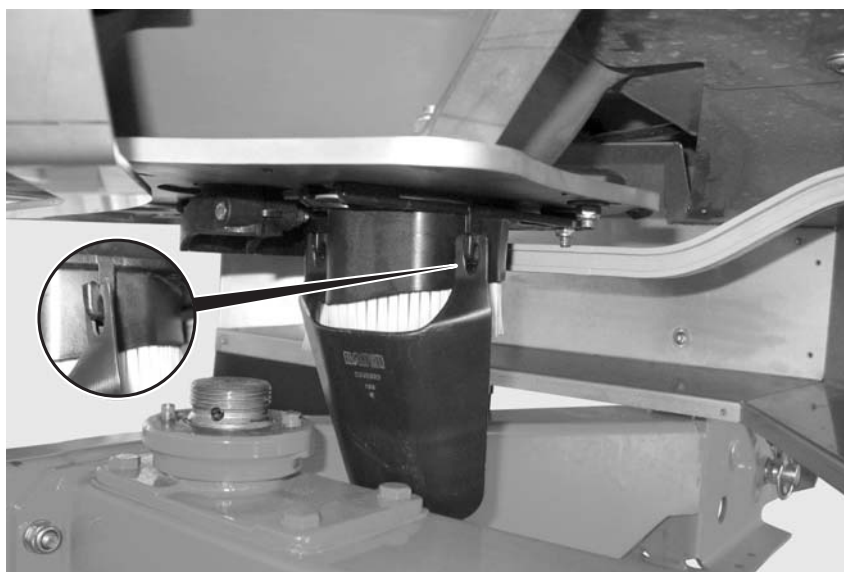
Imagine 12: Agățarea jgheabului probei de calibrare
