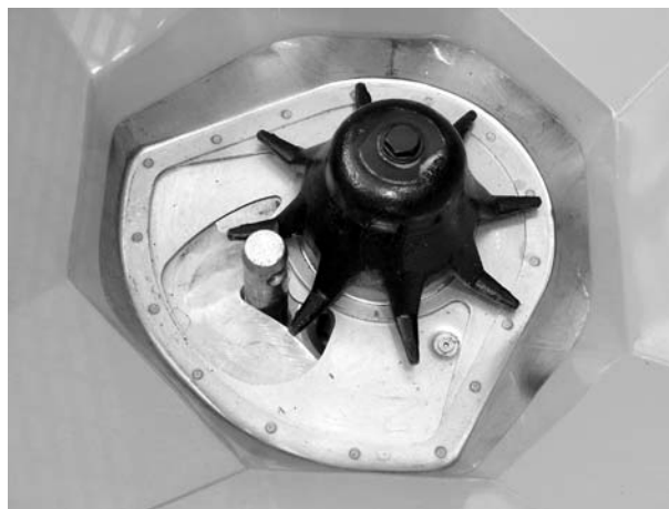
Imagine 22: Boltul ghidajului inferior în orificiul de dozare
