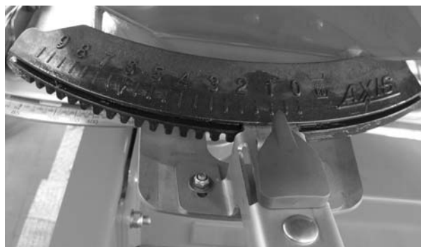
Imagine 42: Verificarea ajustării punctului de alimentare
