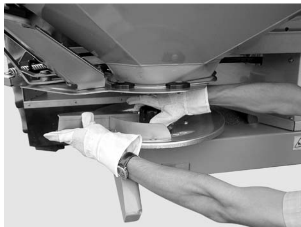
Imagine 6: Deșurubarea piuliței înfundate
