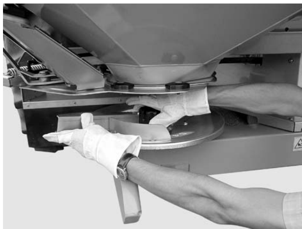
Imagine 13: Deșurubarea piuliței înfundate
