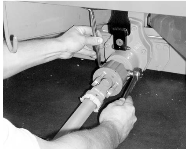
8.3 pav.: Kardaninio veleno tvirtinimas
