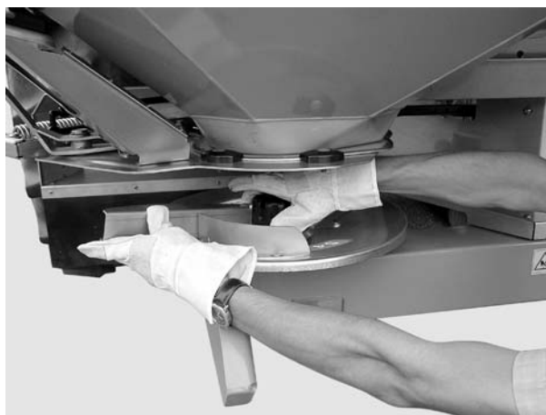
6 pav.: Gaubtelinės veržlės išsukimas
