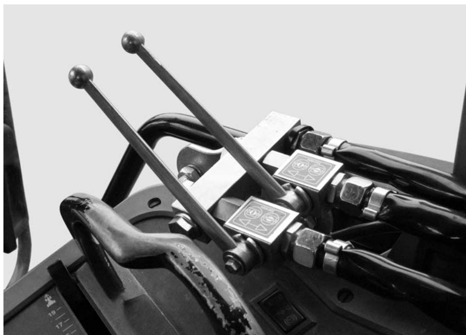
1 pav.: Dvikrypčio bloko sklendžių valdymo įtaisas
