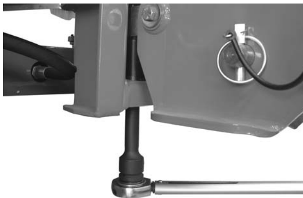
18 pav.: Svorio daviklio tvirtinimas (važiavimo kryptimi kairėje pusėje)
