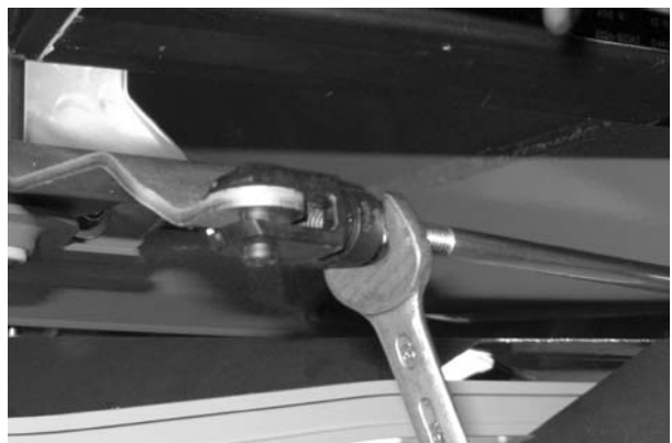
29 pav.: Vidinės šakutės galvutės įkabimas
