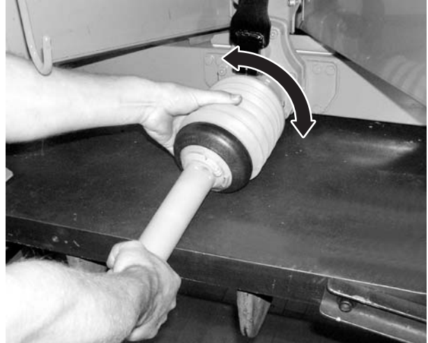
8.4 pav.: Kardaninio veleno apsaugos uždėjimas
