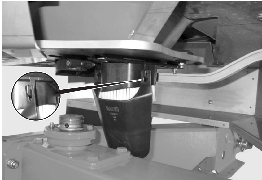
12 pav.: Išbėrimo normos testo latakų įkabinimas
