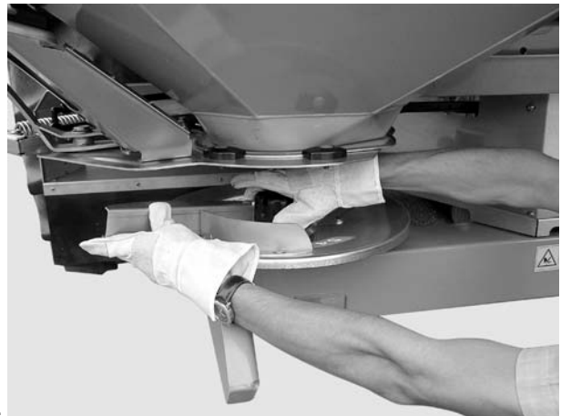
14 pav.: Gaubtelių veržlių persukimas
