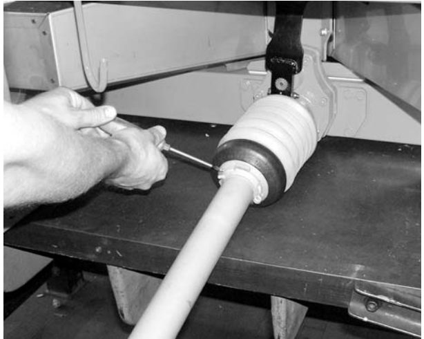
8.5 pav.: Kardaninio veleno apsaugos užfik-savimas
