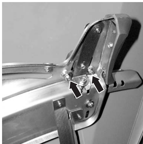
25 pav.: Užduoties taško derinimo skardos atlaisvinimas
