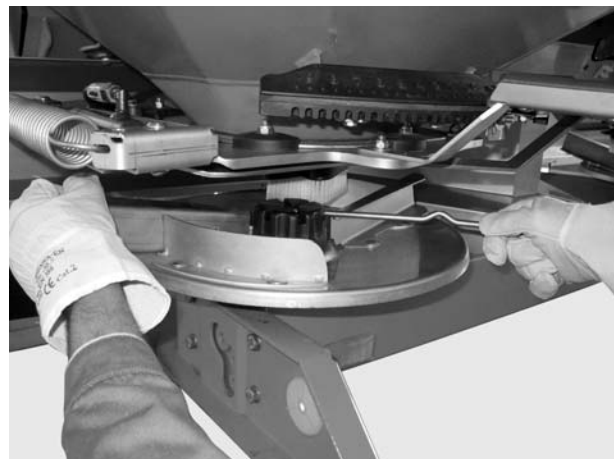
Billede 11: Løsn kalotmøtrikken
