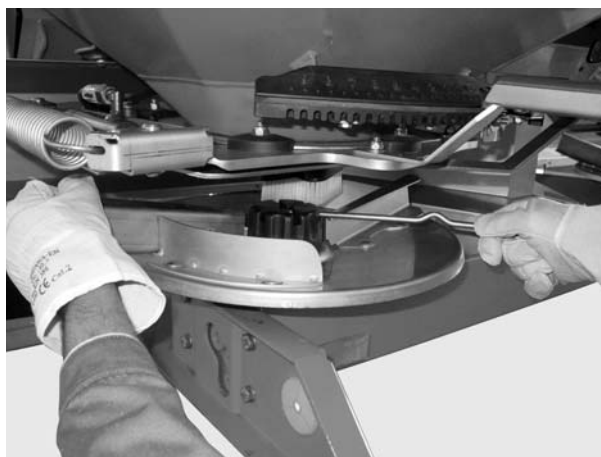
Billede 5: Løsn kalotmøtrikken
