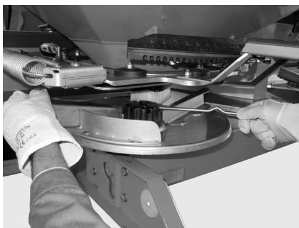
Billede 12: Løsn kalotmøtrikken
