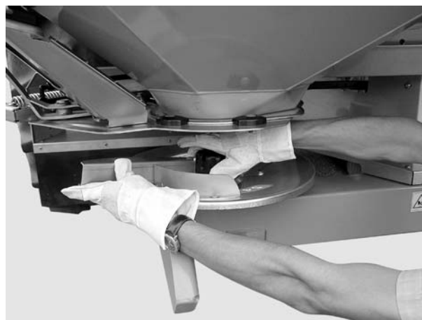
Billede 6: Skru kalotmøtrikken ud
