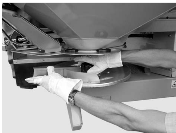
Billede 14: Skru kalotmøtrikken fast
