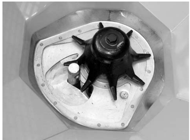
Billede 25: Trækstangsbolt i doseringsåbningen
