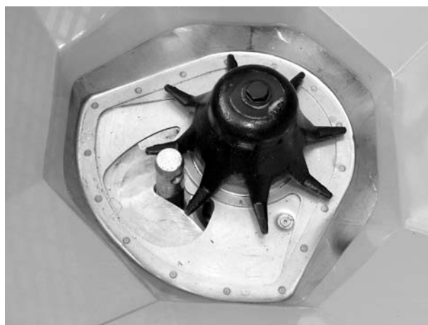
Billede 20: Trækstangbolt i doseringsåbningen
