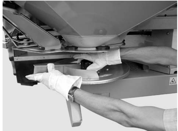
Billede 13: Skru kalotmøtrikken ud
