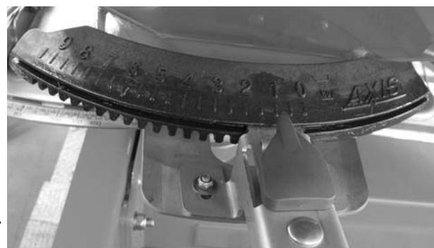
Billede 42: Kontrollér justeringen af udbringningspunktet
