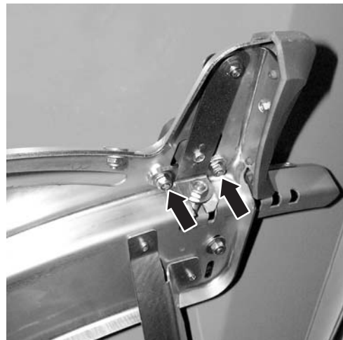
Billede 34: Løsn justeringspladen for udbringningspunktet
