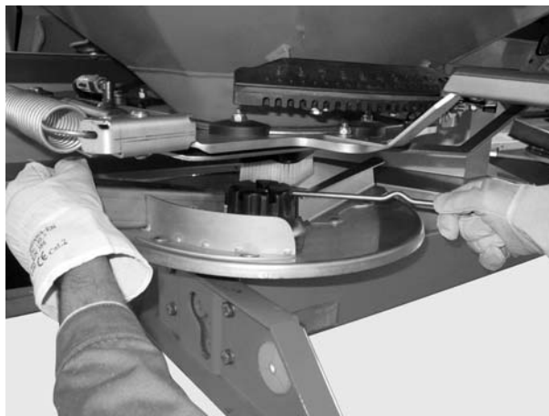
Billede 18: Løsn kalotmøtrikken
