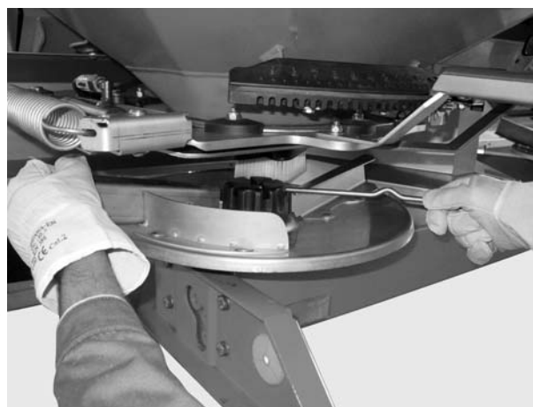
Billede 11: Løsn kalotmøtrikken
