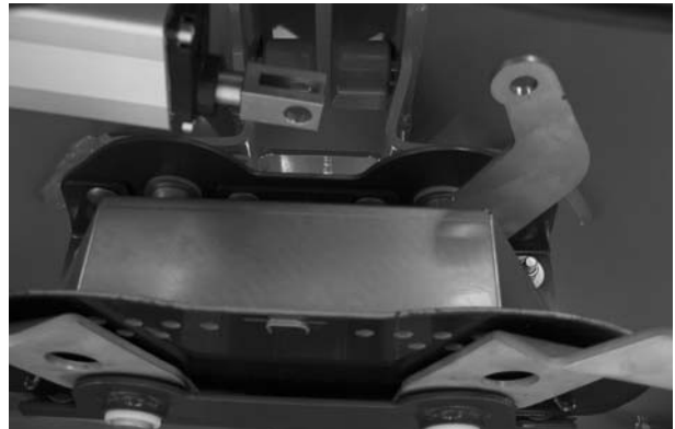
Billede 27: Løft aktuatoren ud
