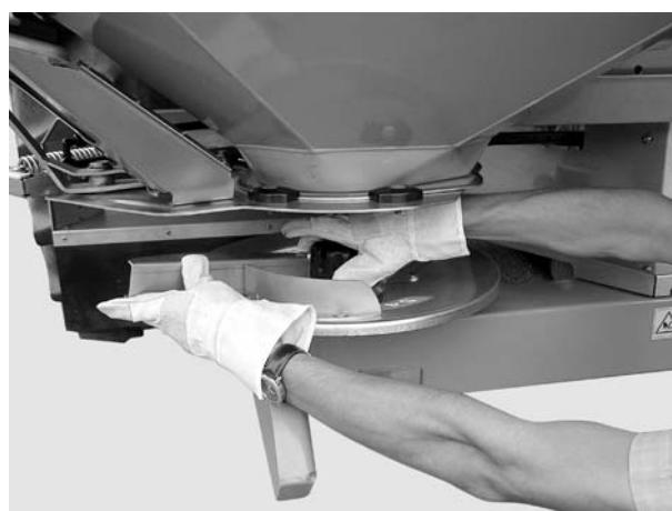
Billede 14: Skru kalotmøtrikken fast
