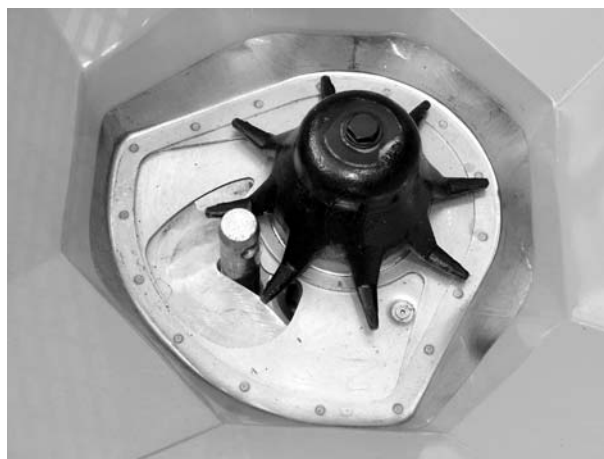
Billede 22: Trækstangbolt i doseringsåbningen
