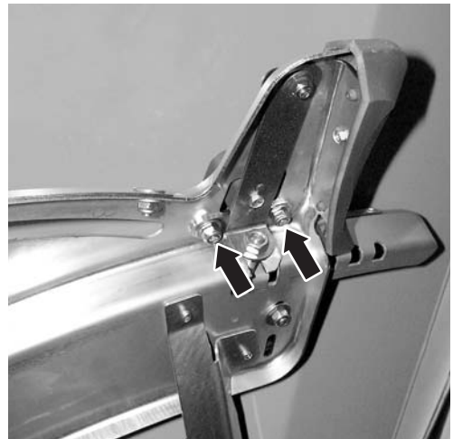
Billede 25: Løsn justeringspladen for udbringningspunktet
