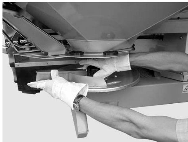
Billede 21: Skru kalotmøtrikken fast
