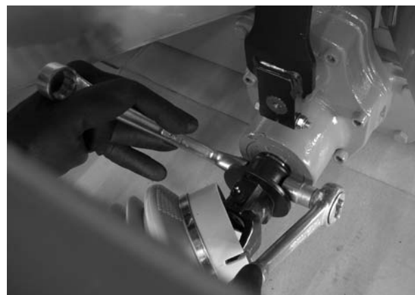
4 ábra: Rögzítse a kardántengelyt
