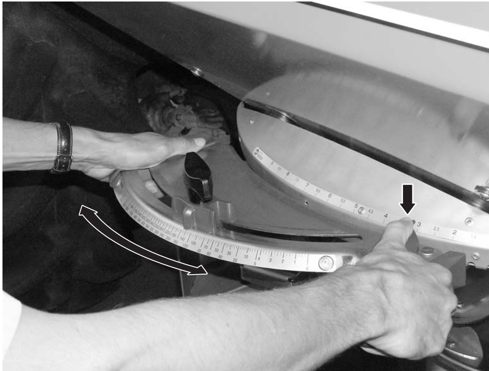
7 ábra: Feladási pont beállítási központ
