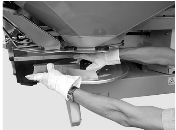
13 ábra: A kalapos anyák lecsavarása
