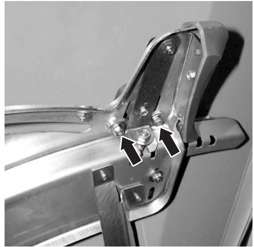
25 ábra: Oldja ki a feladási pont beállító lemezét
