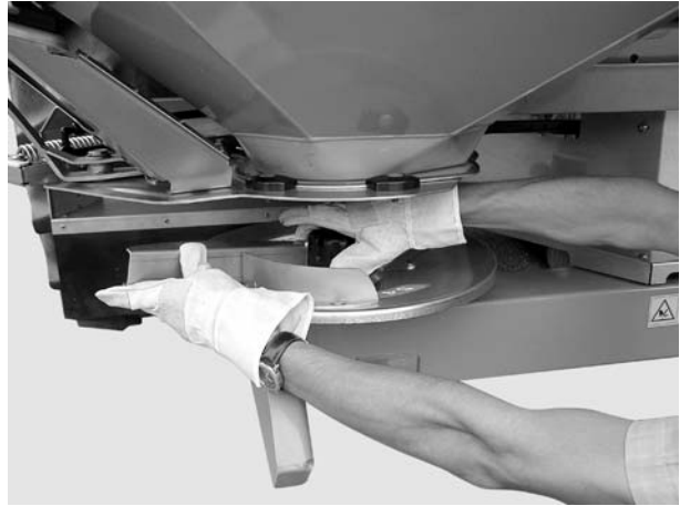
5 ábra: A kalapos anyák lecsavarása
