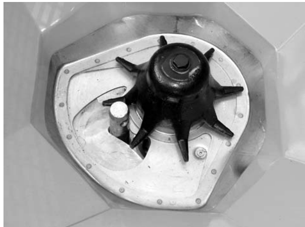
22 ábra: Felfüggesztőkar-csap az adagolónyílásban
