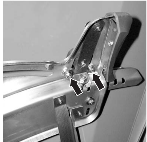
34 ábra: Oldja ki a feladási pont beállító lemezét
