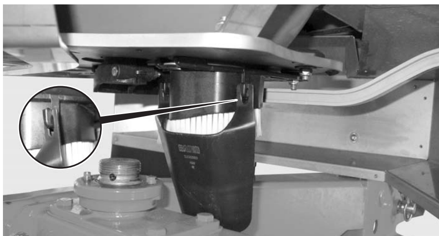
Rysunek 19: Zawieszanie zsuwni do próby kręconej
