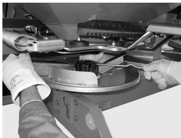
Rysunek 11: Odkręcanie nakrętki kołpakowej
