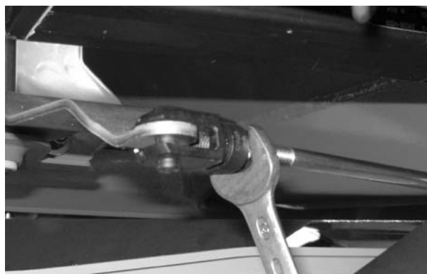
Rysunek 29: Zaczepienie wewnętrznej głowicy widelkowej
