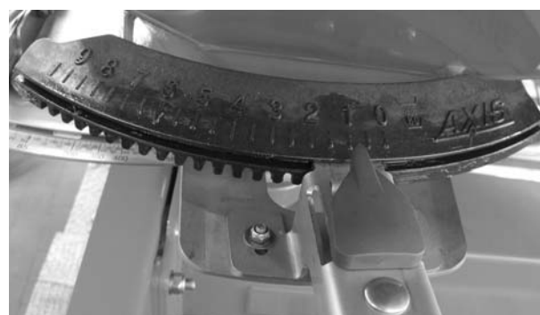
Rysunek 42: Sprawdzenie wyregulowania punktów podawania
