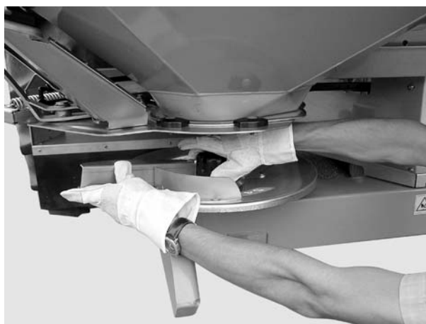
Rysunek 14: Dokręcanie nakrętki kołpakowej
