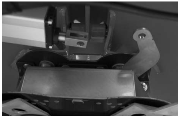
Rysunek 27: Odłączenie siłownika
