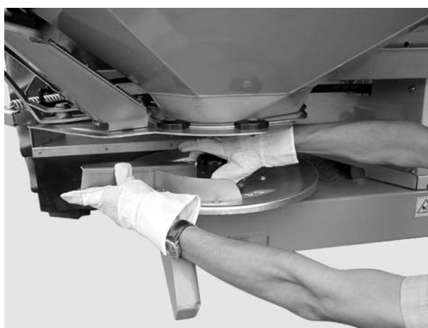
Rysunek 14: Dokręcanie nakrętki kołpakowej
