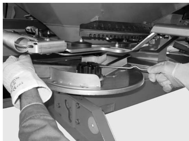
Rysunek 4: Odkręcanie nakrętki kołpakowej
