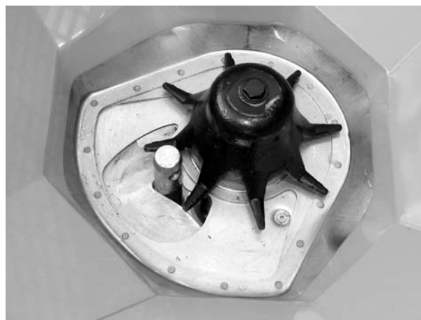
Rysunek 20: Trzpień dolnego ramienia podnośnika w otworze dozującym
