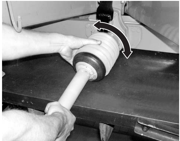
Rysunek 8.4: Zakładanie osłony wału przegubowego
