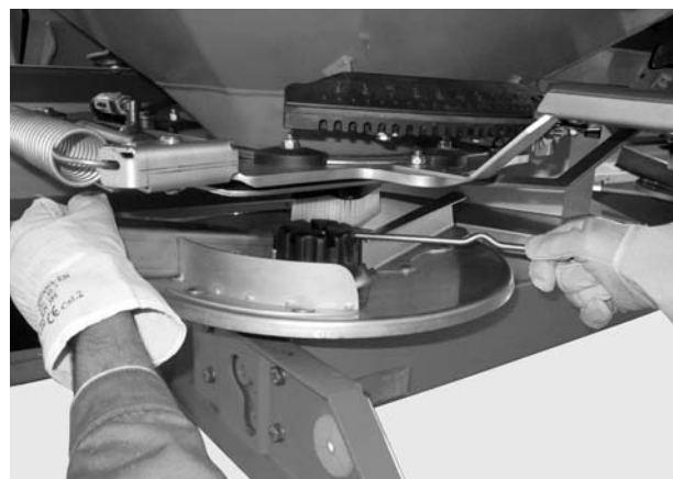
Rysunek 12: Odkręcanie nakrętki kołpakowej
