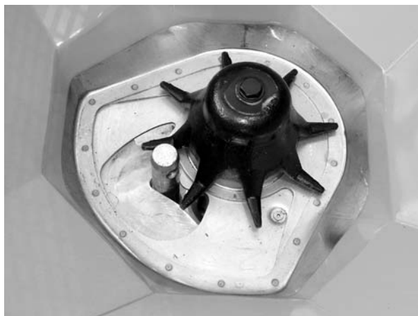
Rysunek 22: Trzpień dolnego ramienia podnośnika w otworze dozującym
