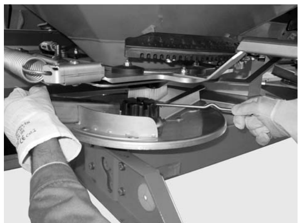
Rysunek 5: Odkręcanie nakrętki kołpakowej
