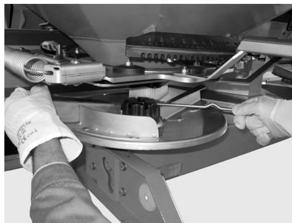
Rysunek 11: Odkręcanie nakrętki kołpakowej
