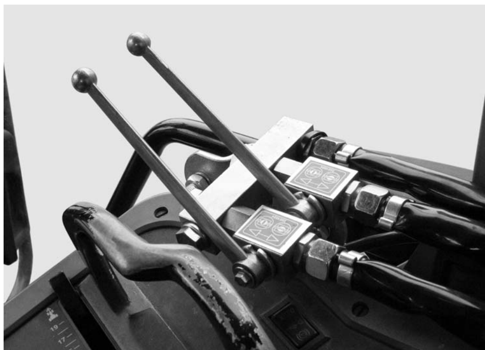
Rysunek 8: Układ sterowania zasuw z zespołem 2-drogowym
