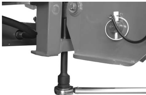
Rysunek 18: Zamocowanie sensora wagi (w kierunku jazdy w lewo)
