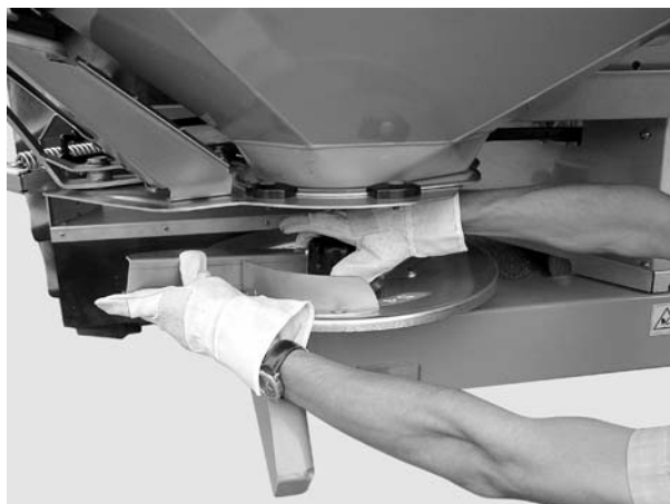
Rysunek 13: Odkręcanie nakrętki kołpakowej
