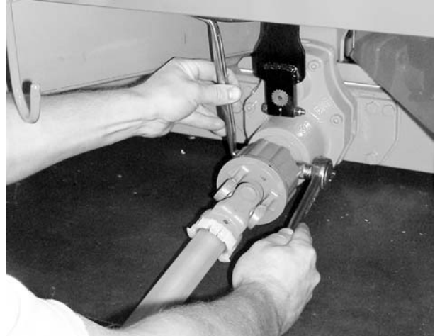
Rysunek 8.3: Mocowanie wału przegubowego
