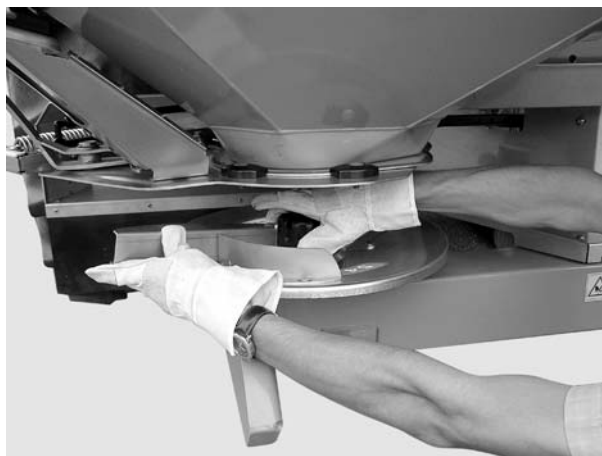
Rysunek 5: Odkręcanie nakrętki kołpakowej
