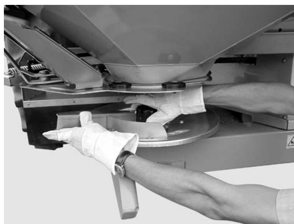
Rysunek 21: Przykręcanie nakrętki kołpakowej
