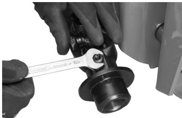
Rysunek 2: Luzowanie gniazda smarowego
