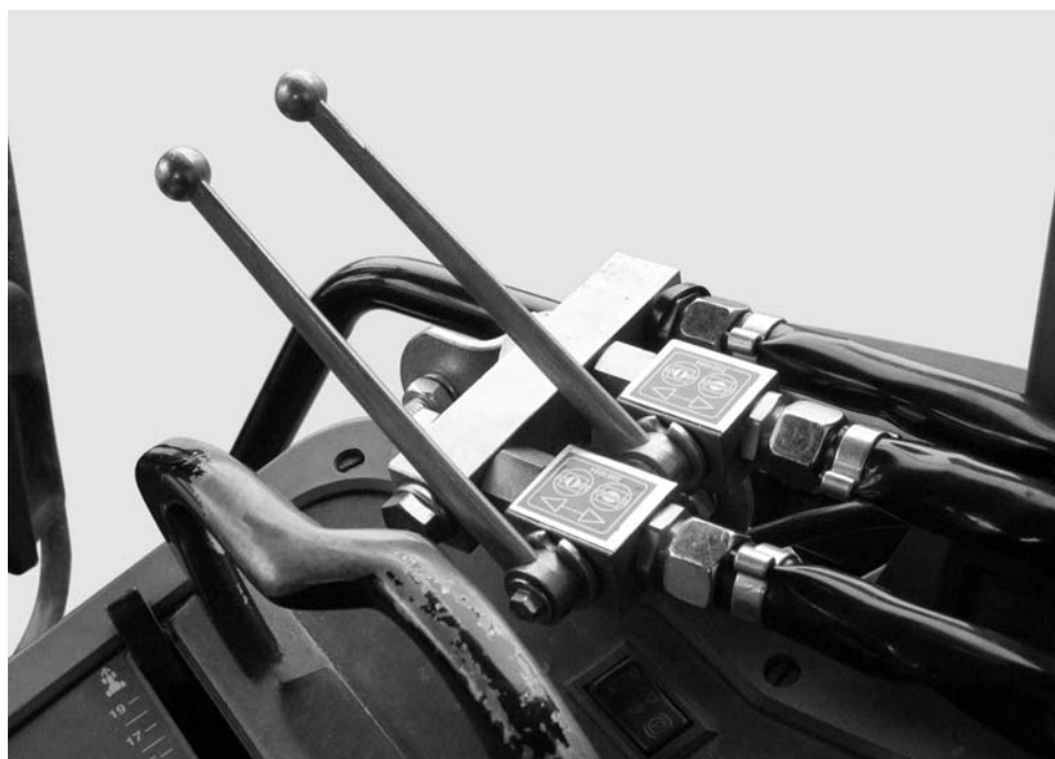
Rysunek 1: Układ sterowania zasuw z zespołem 2-drogowym
