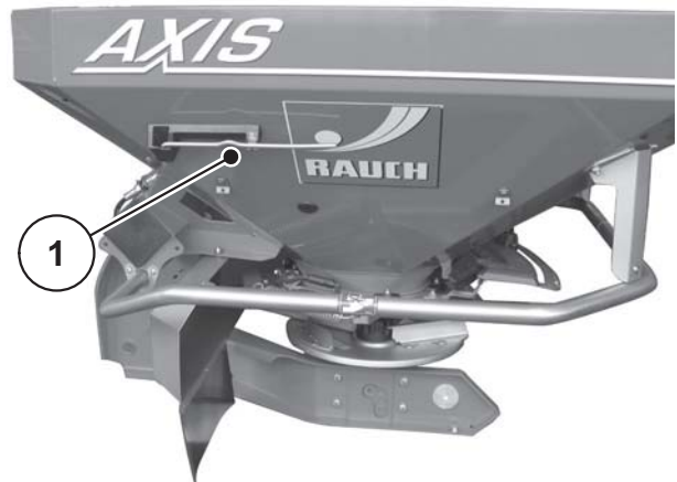
Rysunek 11: Dźwignia nastawcza
