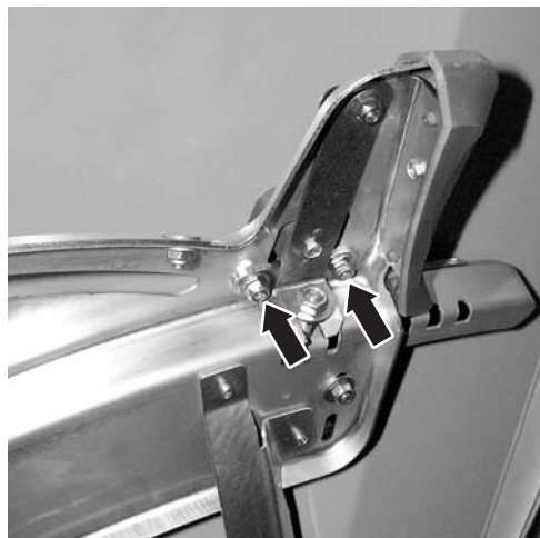
Rysunek 34: Odkręcanie blachy regulacyjnej punktu dozowania
