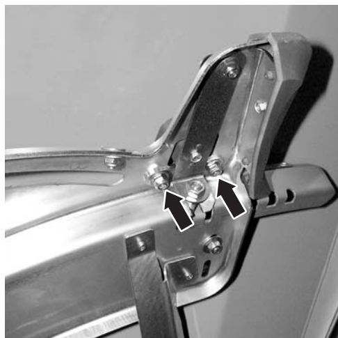
Rysunek 25: Odkręcanie blachy regulacyjnej punktu dozowania
