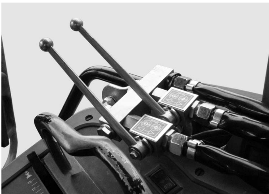
Bild 8: Slidstyrning med tvåvägsventil
