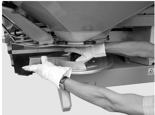
Bild 14: Skruva fast hattmuttern
