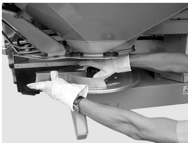
Bild 14: Skruva fast hattmuttern
