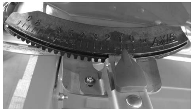
Bild 42: Kontrollera inställningen av spridningspunkten
