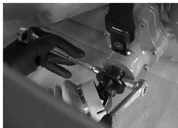
Bild 4: Sätt fast kraftöverföringsaxeln.
