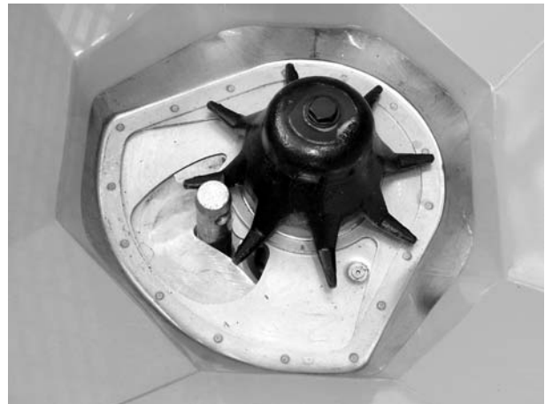
Bild 22: Bult för nedre ledarm i doseringsöppningen
