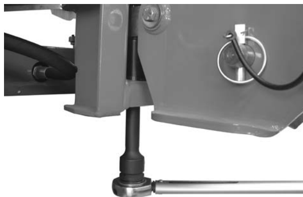
Bild 18: Montering av vågcellen (på vänster sida i körriktingen)
