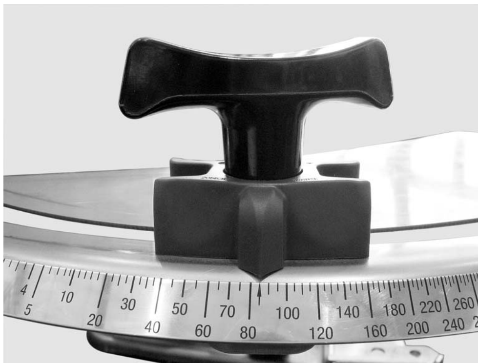
Bild 23: : Skala på doseringsslidinställningen
