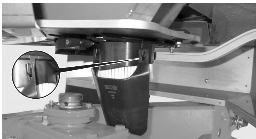
Bild 19: Sätt fast glidbanan för utmatningsprov
