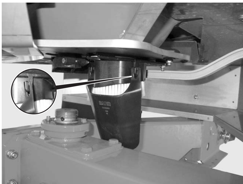
Bild 12: Sätt fast glidbanan för utmatningsprov
