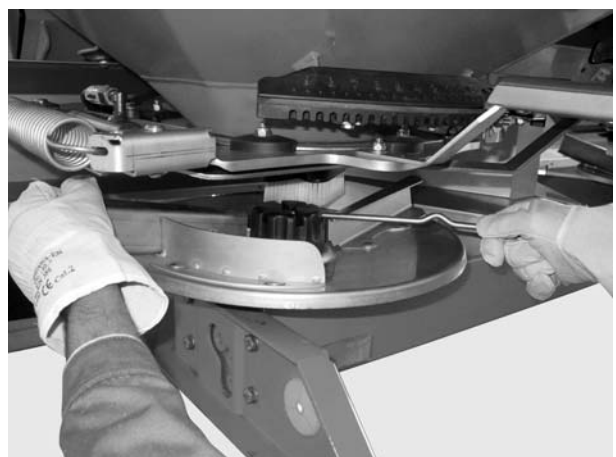
Obrázek 4: Povolení uzavřené matice
