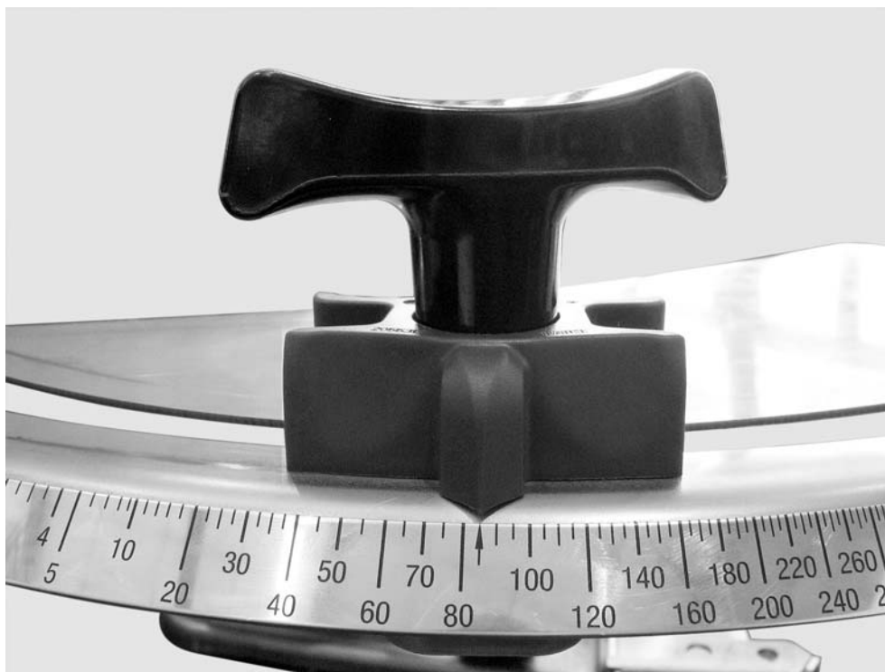
Obrázek 23: Stupnice nastavení dávkovacího šoupátka
