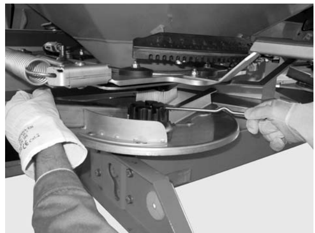
Obrázek 11: Povolení uzavřené matice
