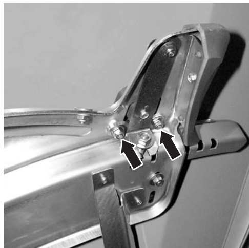
Obrázek 25: Uvolnění seřizovacího plechu bodu podávání
