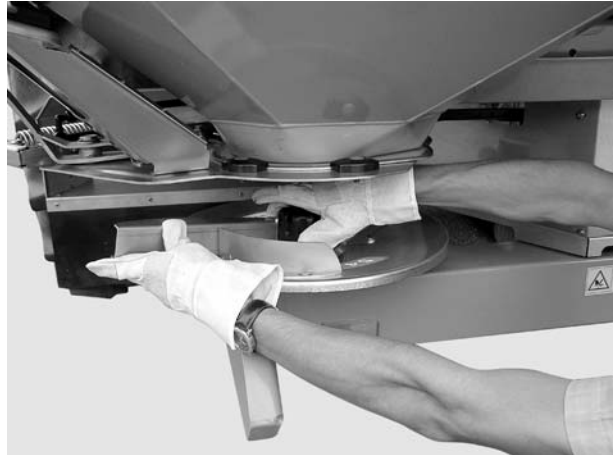
Obrázek 5: Odšroubování uzavřené matice
