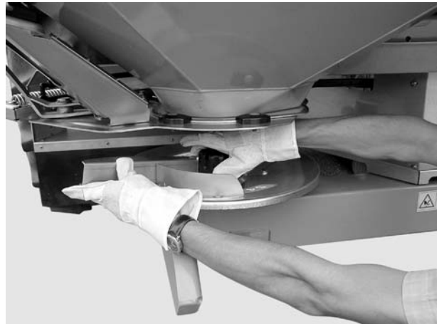
Obrázek 13: Odšroubování uzavřené matice
