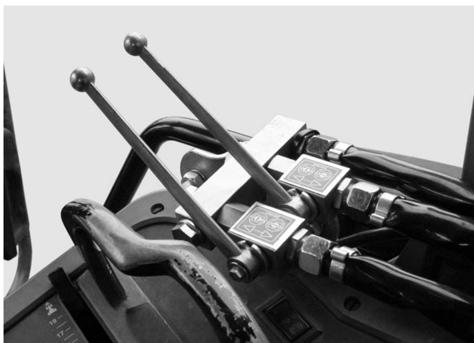
Obrázek 8: Ovládání šoupátka dvojcestné jednotky
