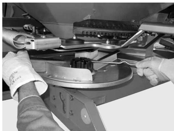
Obrázek 5: Povolení uzavřené matice
