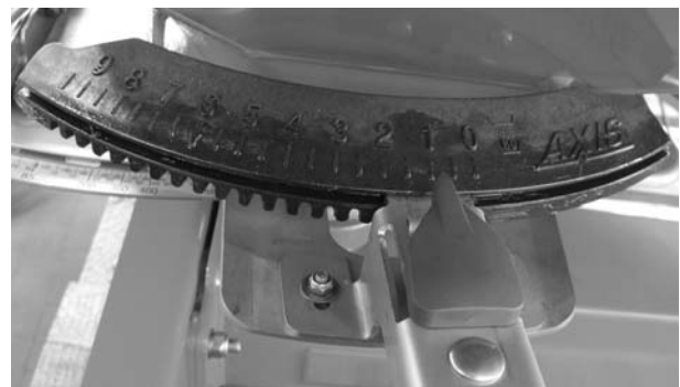
Obrázek 42: Kontrola nastavení bodu podávání
