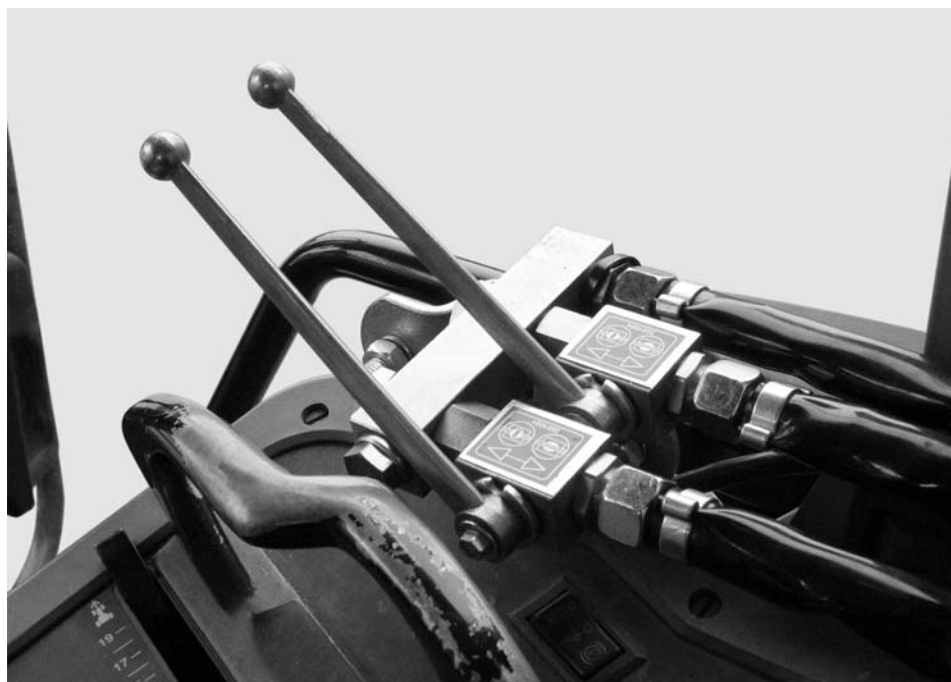
Obrázek 1: Ovládání šoupátka dvojcestné jednotky
