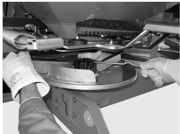
Obrázek 11: Povolení uzavřené matice
