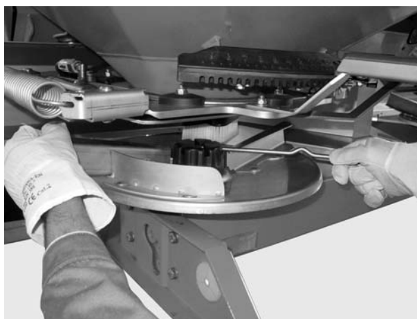
Obrázek 18: Povolení uzavřené matice
