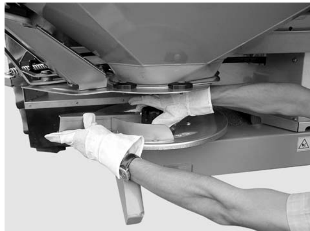
Obrázek 21: Zašroubování uzavírací matice
