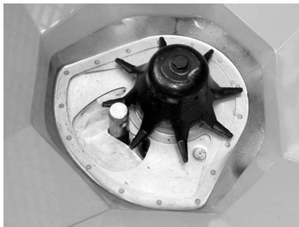
Obrázek 20: Čep dolního táhla v dávkovacím otvoru
