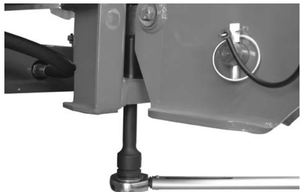
Obrázek 18: Upevnění odvažovací komory (ve směru jízdy vlevo)
