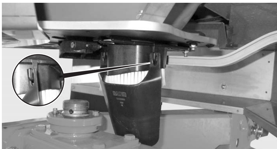
Obrázek 19: Zavěšení žlabu pro stáčecí zkoušku
