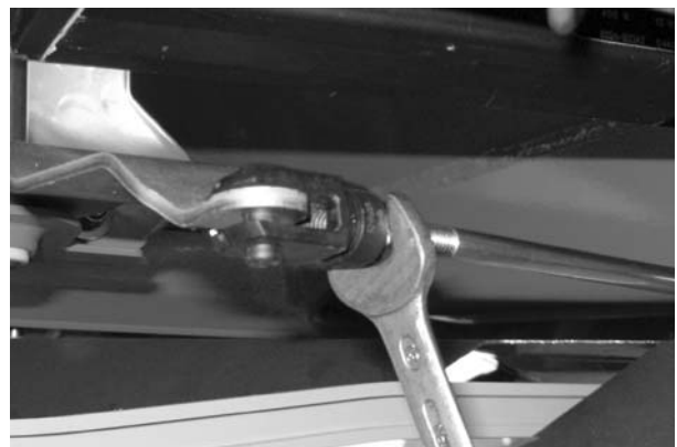
Obrázek 29: Napojení vnitřní vidlicové hlavy
