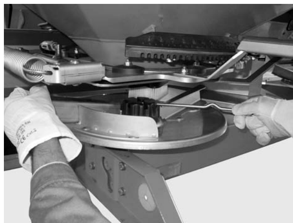
Рисунок 12: Снимите колпачковую гайку
