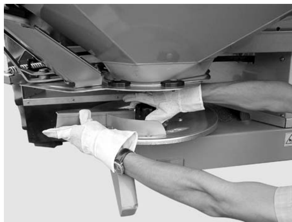
Рисунок 6: Отвинчивание глухой колпачковой гайки
