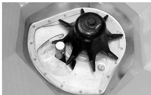
Рисунок 22: Болт нижней тяги в дозирующем отверстии
