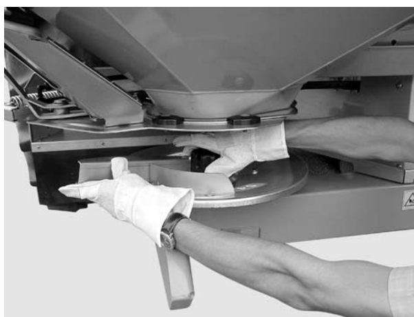
Рисунок 14: Привинтить колпачковую гайку
