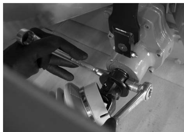
Рисунок 4: Закрепление карданного вала
