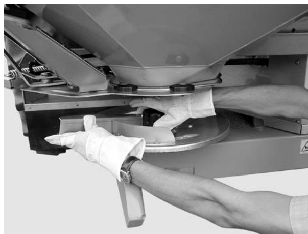
Рисунок 14: Привинтить колпачковую гайку
