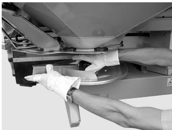
Рисунок 21: Заворачивание колпачковой гайки
