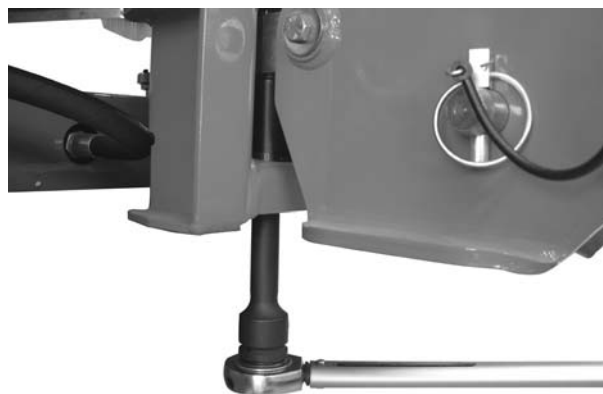
Рисунок 18: Крепление весовой ячейки (слева по направлению движения)
