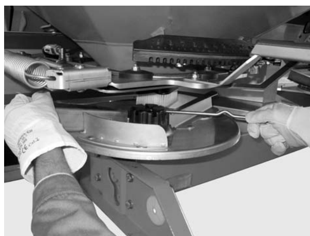
Рисунок 11: Снимите колпачковую гайку
