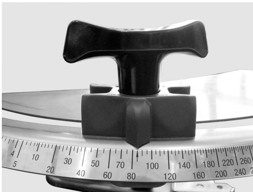
Рисунок 23: Шкала для регулировки дозирующей заслонки
