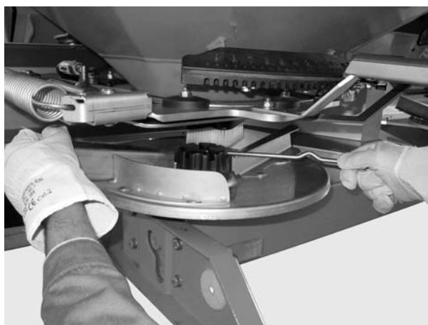
Рисунок 4: Снимите колпачковую гайку
