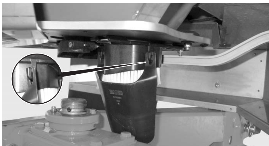
Рисунок 19: Подвешивание спускной трубы
