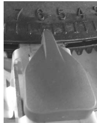
Рисунок 31: Установка точки подачи в поз. 6
