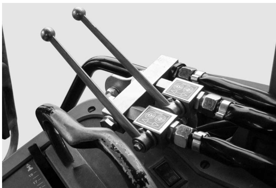
Рисунок 1: Гидравлическое устройство управления заслонкой двухходового блока
