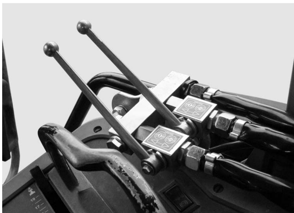
Рисунок 8: Гидравлическое устройство управления заслонкой двухходового блока
