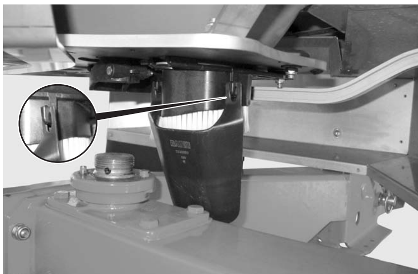
Рисунок 12: Подвешивание спускной трубы
