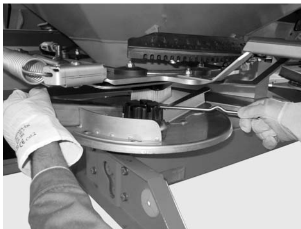
Рисунок 5: Снимите колпачковую гайку
