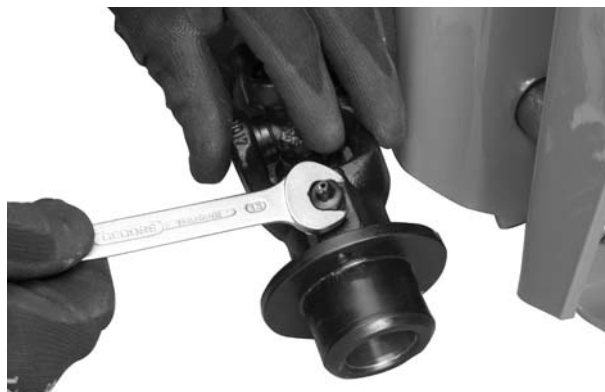
Рисунок 2: Отсоединение смазочного ниппеля
