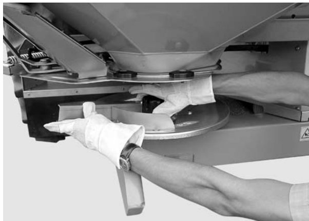
Рисунок 13: Отвинчивание глухой колпачковой гайки
