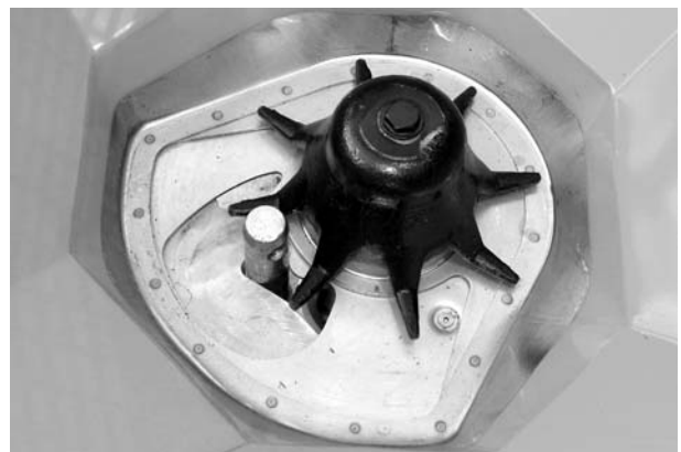
Рисунок 25: Болт нижней тяги в дозирующем отверстии
