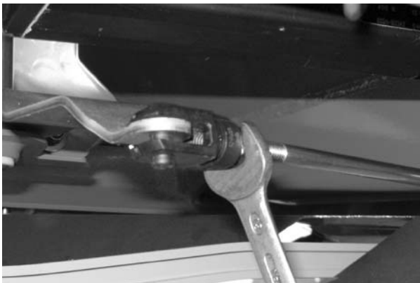
Рисунок 29: Зацепление внутренней вильчатой головки
