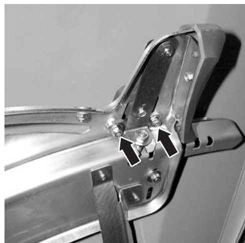
Рисунок 25: Ослабление пластины для установки -точки подачи
