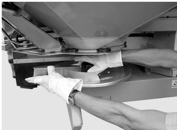
Рисунок 5: Отвинчивание глухой колпачковой гайки
