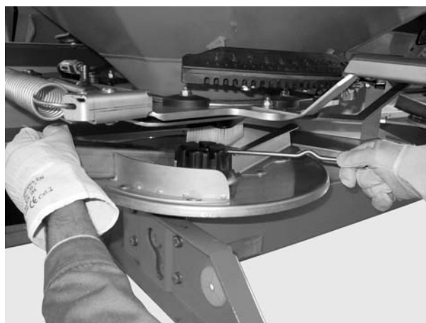
Рисунок 11: Снимите колпачковую гайку
