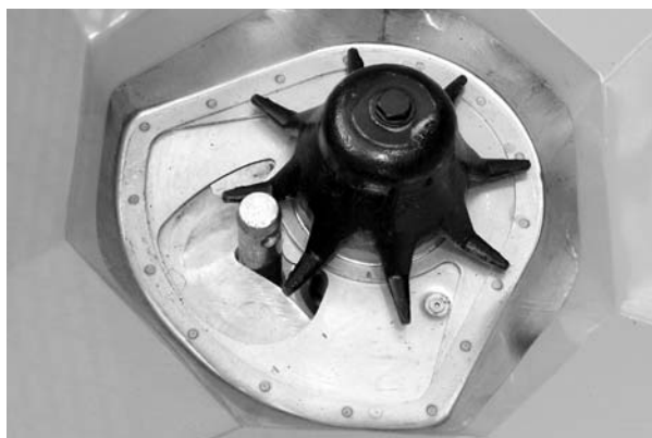
Рисúнок 20: Болт нижней тяги в дозирующем отверстии
