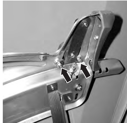
Afb. 34: afstelplaat opbrengpunt losmaken
