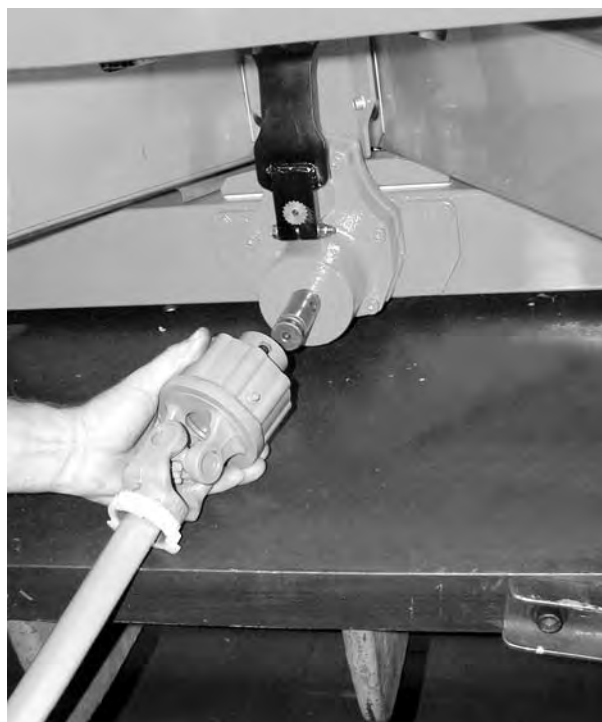
Afb. 8.2: Cardanas op de tandwielen steken
