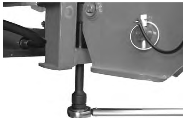
Afb. 18: Bevestiging van de weegcel (in rijrichting links)
