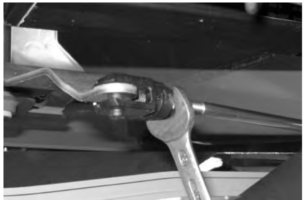
Afb. 29: Binnenste vorkkop inhangen
