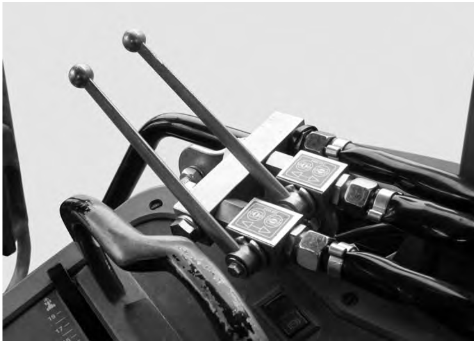
Afb. 1: Schuifbediening van de tweewegseenheid
