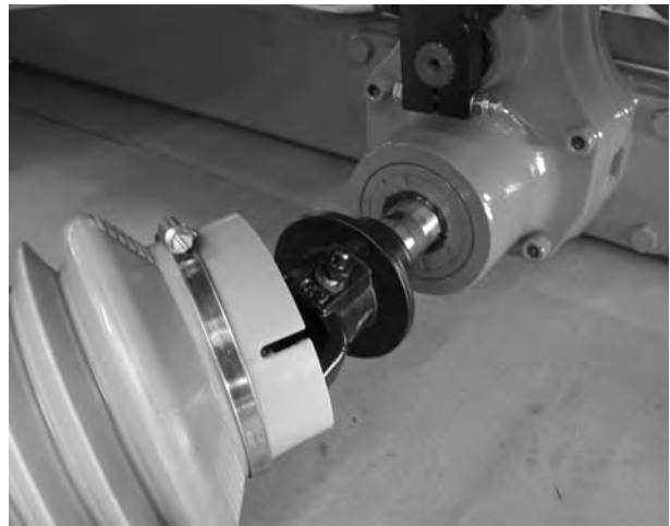
Afb. 3: Cardanas op de tandwielpen steken
