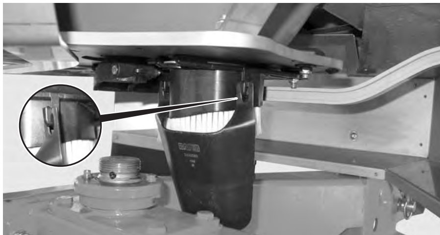
Afb. 19: Glijgoot voor afdraaiproeven ophangen.
