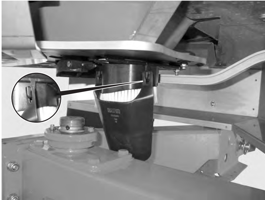
Afb. 12: Glijgoot voor afdraaiproeven ophangen.
