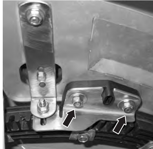
Afb. 28: afstelplaat opbrengpunt losmaken
