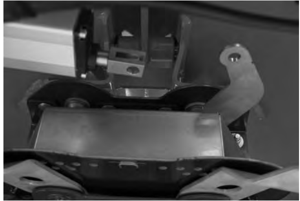
Afb. 27: Stelmotor eruit halen
