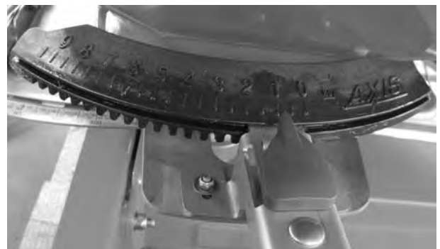
Afb. 42: Afstelling van het afgiftepunt controleren
