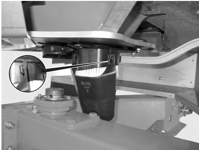
Afb. 12: Glijgoot voor afdraaiproeven ophangen.
