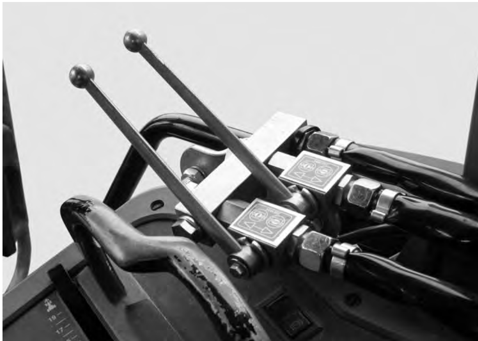
Afb. 8: Schuifbediening van de tweewegseenheid
