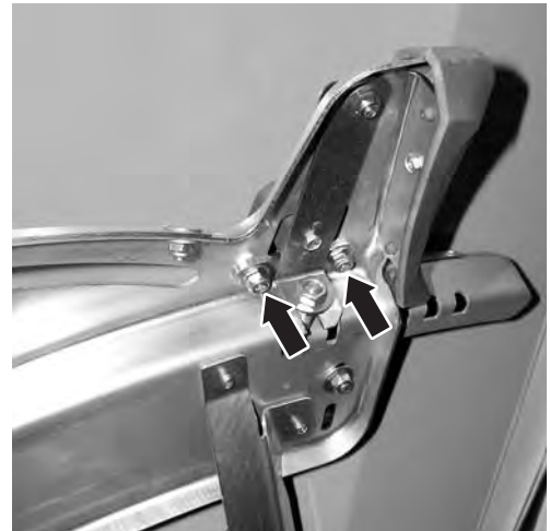
Afb. 25: afstelplaat opbrengpunt losmaken
